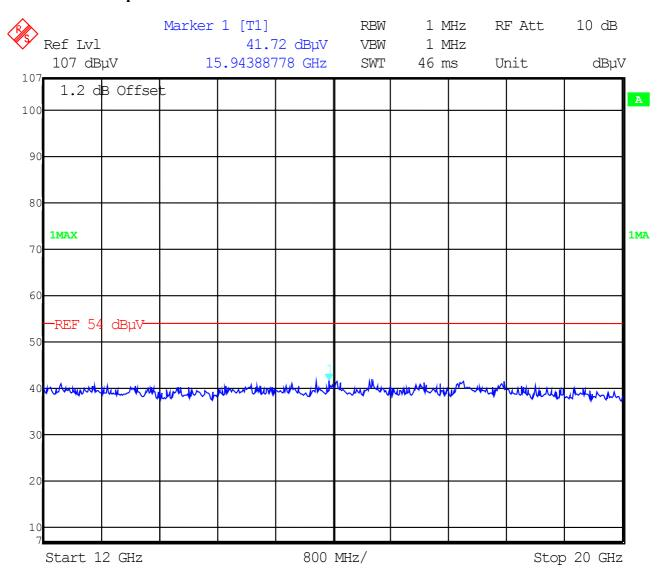
f < 1 GHz : RBW/VBW: 100 kHz  $f \ge 1GHz : RBW/VBW 1 \text{ MHz}$
