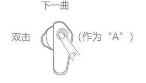
加减 (+-) 音量操作: 快速三击作为 "A" 这只耳机是音量 "+" 快速三击作为 "B" 这只耳机是音量 "-", 也可以直接通过操作 手机上面的音量减调节音量大小
