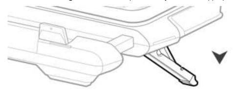
4. **插入电源** 将 type-C 供电线插入供电口,短按电源按键开机(为解锁最大性能档位,BS2 标准版建议使用≥PD 18W 的适配器供电,Pro 版建议使用≥PD 27W 的适配器供电)
