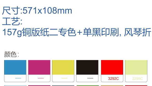
Dieline \_\_\_\_\_ \_\_\_\_\_ ----------1. 使用材质足重足克; 2. 表面划伤面积小于总面积0.5%; 印刷色差小于10%; 3. 4. 折合对齐、平整; 5. 展开正负公差小于1mm, 折合正负公差小于1mm。
