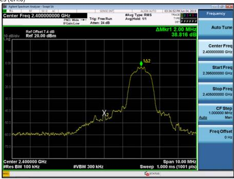
Test Plots without hopping ( $\pi/4DQPSK$ )
