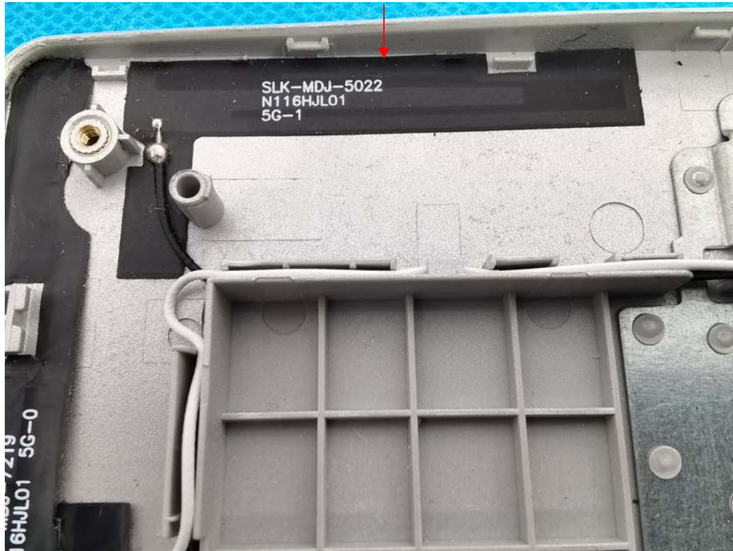
5G NR Antenna1(TX&RX)
