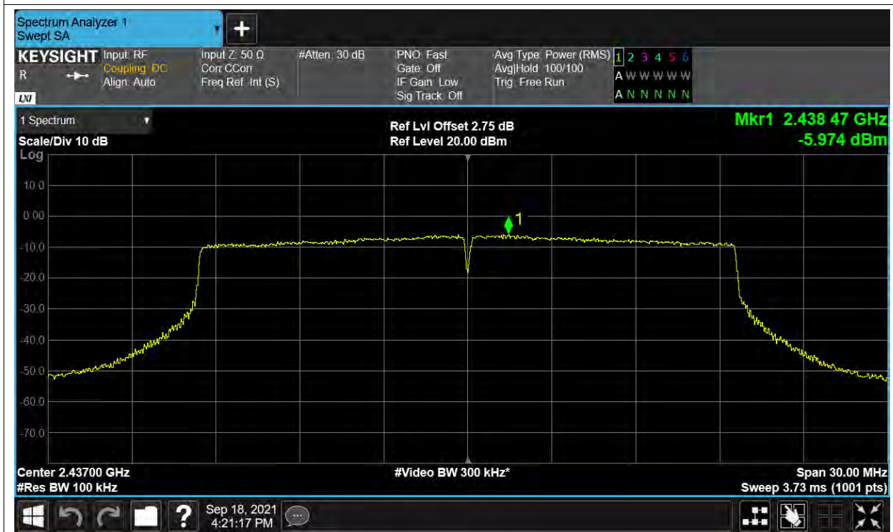
PSD NVNT ax20 2462MHz ANT1
