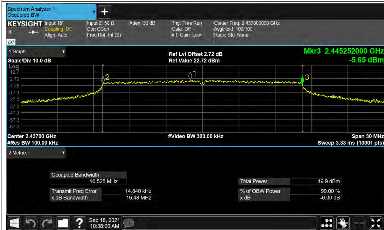
-6dB Bandwidth NVNT g 2462MHz ANT1
