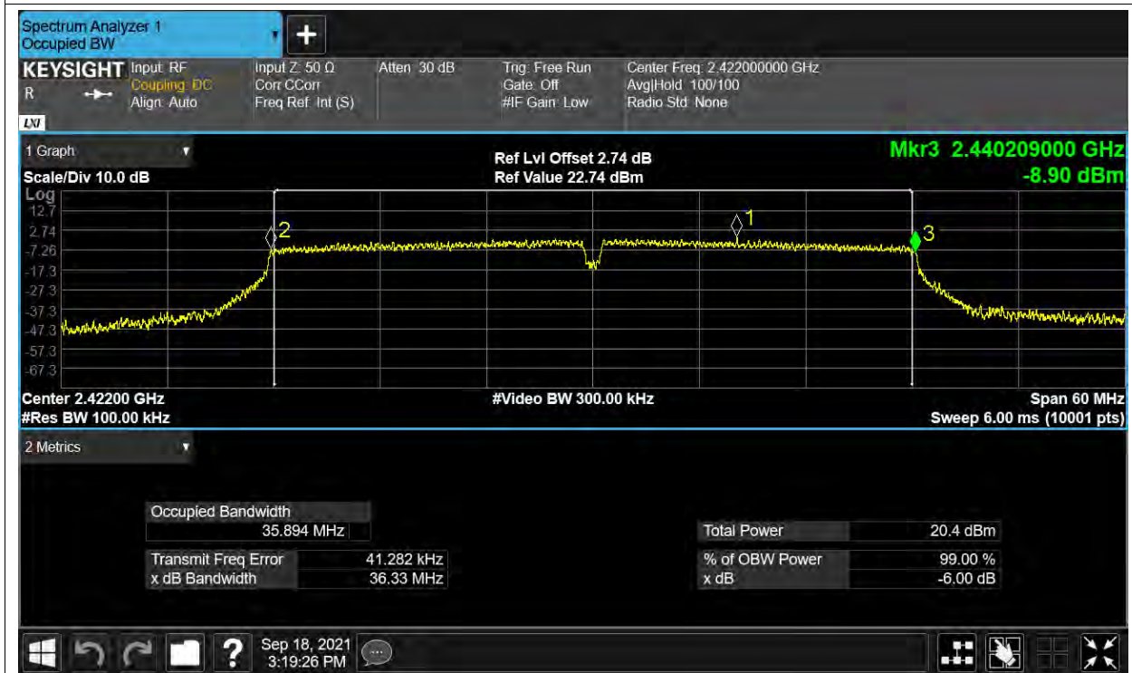
-6dB Bandwidth NVNT n40 2437MHz ANT1
