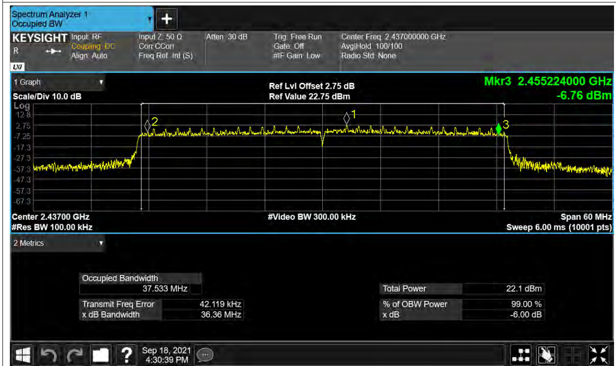
-6dB Bandwidth NVNT ax40 2452MHz ANT1
