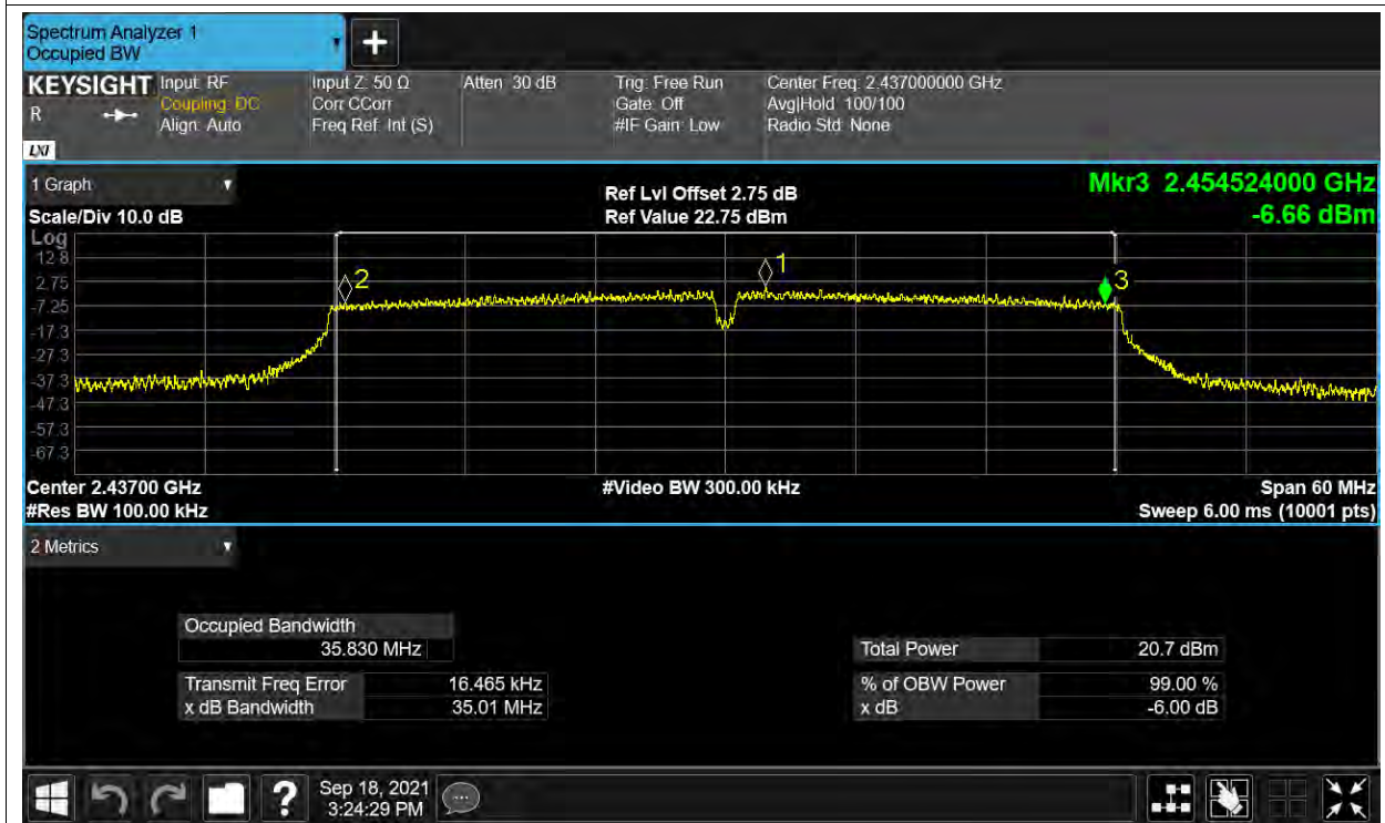
-6dB Bandwidth NVNT n40 2452MHz ANT1
