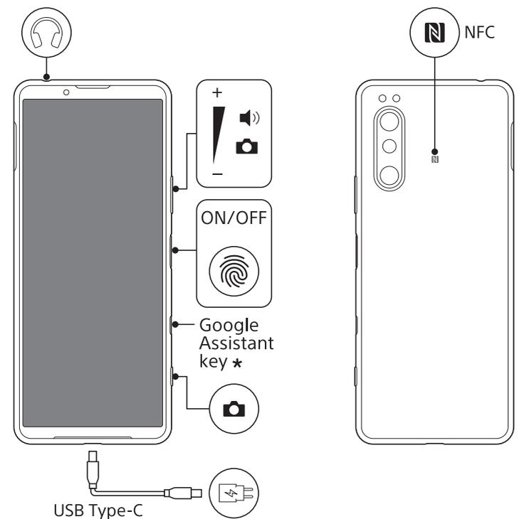
\* Назначение клавиши может отличаться в зависимости от страны/региона. Перейдите в [Настройки] > [Система] > [Жесты] > [Клавиша быстрого вызова] для получения дополнительной информации.
