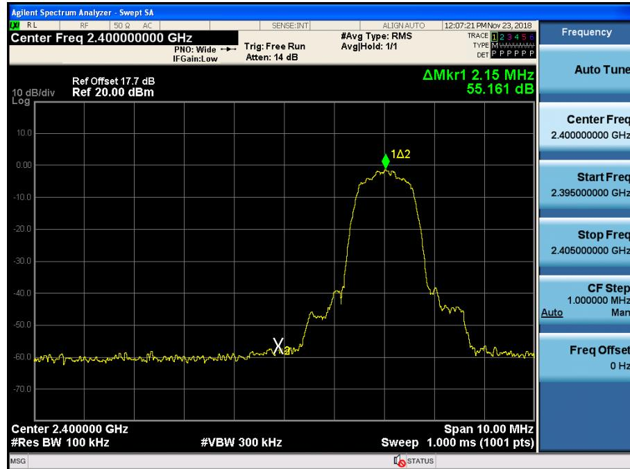
Test Plots without hopping ( $\pi/4$ DQPSK)
