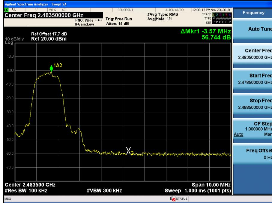
Test Plots without hopping ( $\pi/4$ DQPSK)
