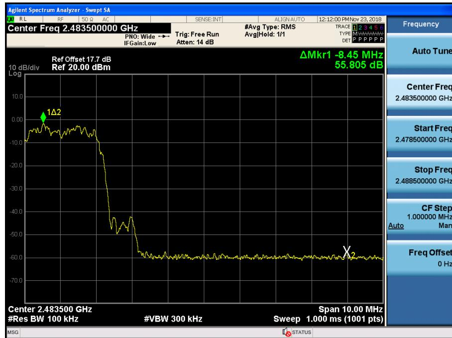
Test Plots with hopping ( $\pi/4$ DQPSK)
