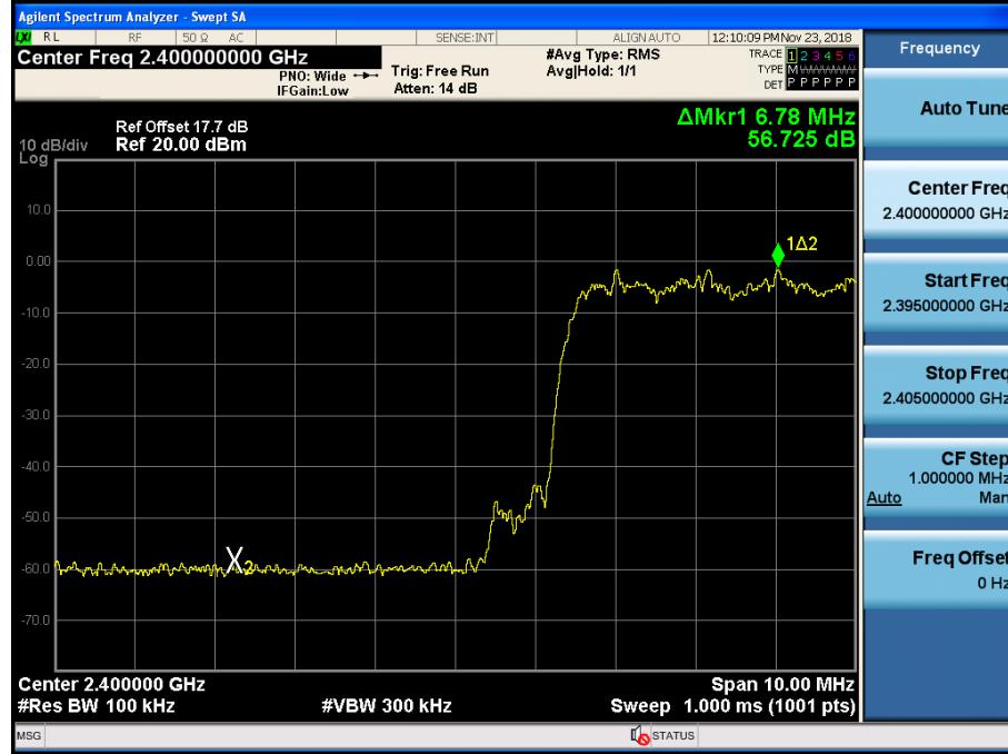
Test Plots with hopping ( $\pi/4$ DQPSK)
