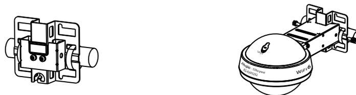
(1) Fije la placa de montaje en el soporte horizontal introduciendo dos abrazaderas para tubo a través de los orificios cuadrados de la placa de montaje. Apriete los tornillos con un destornillador Phillips.
