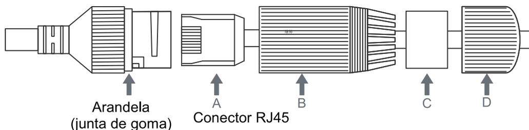
(3) Instale un conector RJ45 en el extremo sin terminación del cable Ethernet con la herramienta de instalación de cables Ethernet.
