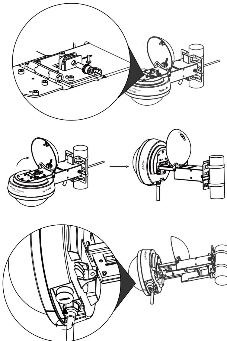
(3) Кабельный ввод состоит из четырех компонентов: А (основание адаптера), В (разъемное уплотнение), С (втулка), D (фиксирующий колпачок). Последовательно пропустите необжатый конец волоконно-оптического кабеля через компоненты D, С, В и А. Вставьте необжатый конец волоконно-оптического кабеля в коннектор RJ-45 и обожмите его. Аккуратно вставьте коннектор RJ-45 в порт SFP точки доступа. Закрутите компонент А (основание адаптера) в порт SFP.
