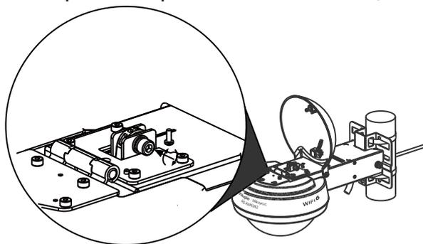
(5) Закройте верхнюю крышку и затяните винт с помощью шестигранного ключа 5 мм. Установите резиновую заглушку в отверстие.
