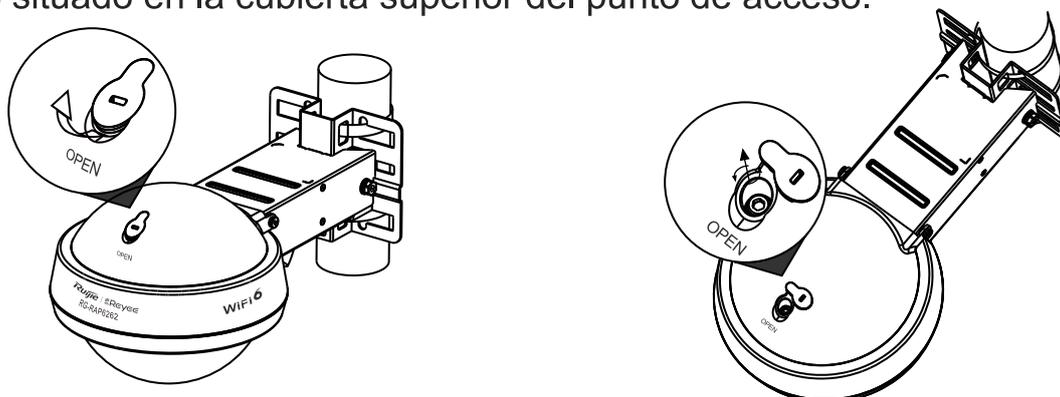
(2) Abra la cubierta superior y utilice una llave Allen de 5 mm para aflojar el tornillo del perno de la bisagra. Retire los cables del brazo de montaje y gire la
