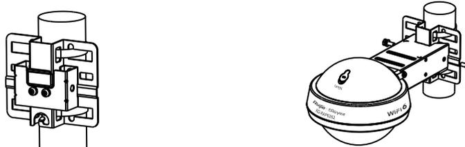
(1) Fije la placa de montaje en el soporte vertical introduciendo dos abrazaderas para tubo a través de los orificios cuadrados de la placa de montaje. Apriete los tornillos con un destornillador Phillips.
