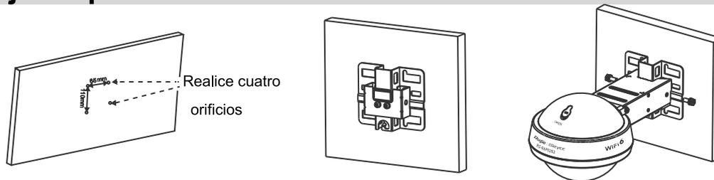
(1) Realice cuatro orificios siguiendo el patrón de 65 mm x 110 mm en la pared.
