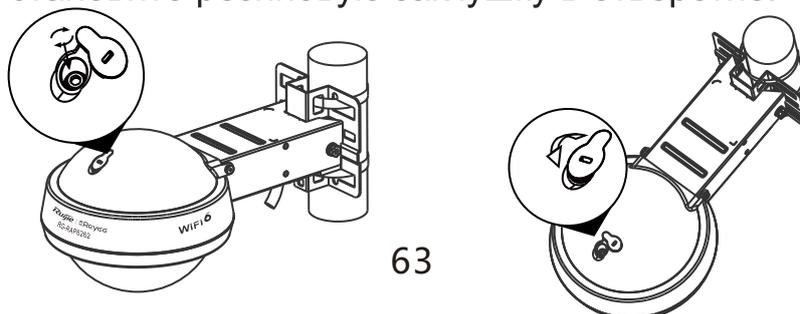
(6) Если вы хотите установить кабельный ввод, не пропуская через него кабель Ethernet, вставьте водонепроницаемый резиновый стержень в шайбу (резиновое кольцо) и последовательно затяните компоненты В, С и D.
