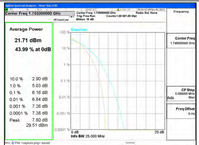
B66 / 15MHz / Mid CH / 16QAM
