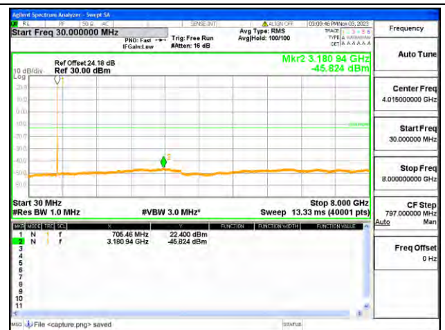
B12 / 5MHz / Mid CH / QPSK
