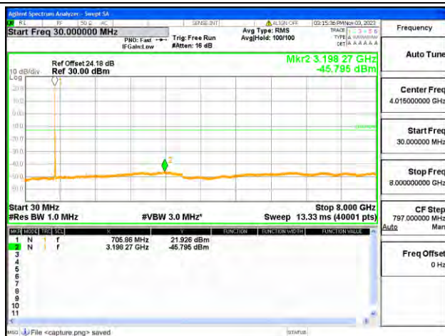
B17 / 10MHz / Mid CH / QPSK
