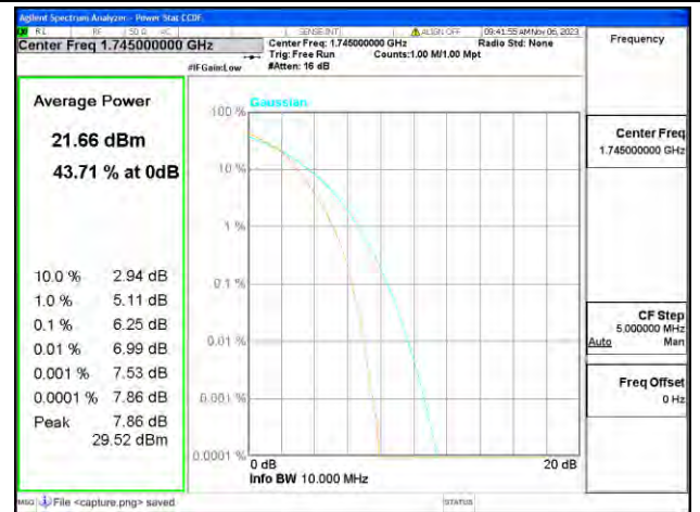
B66 / 10MHz / Mid CH / 16QAM
