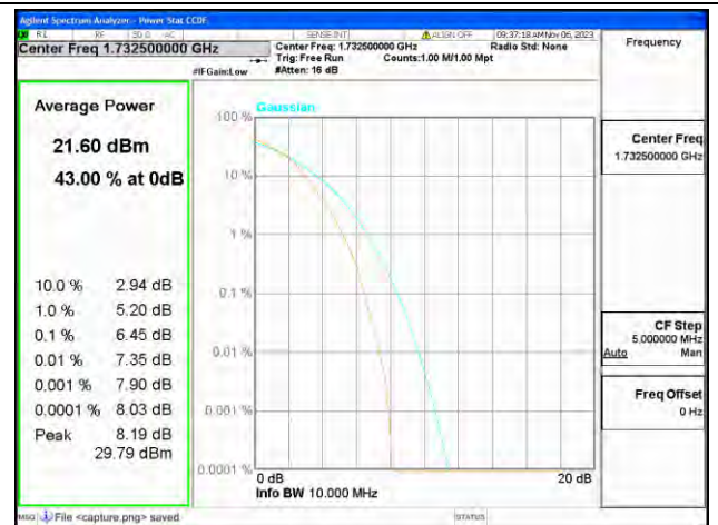
B4 / 10MHz / Mid CH / 16QAM
