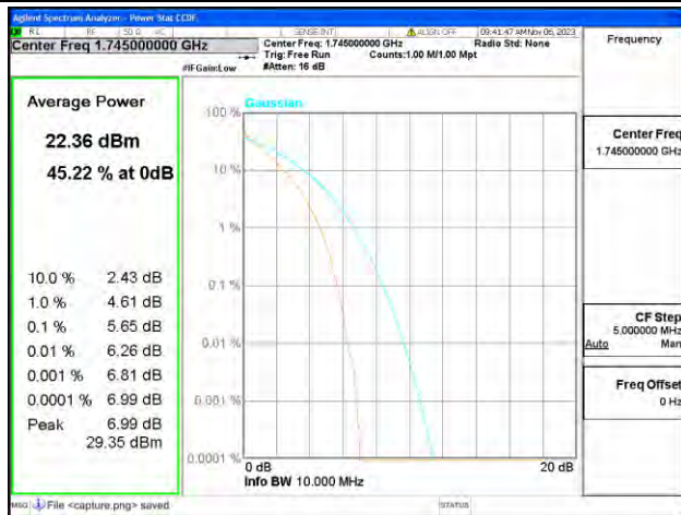
B66 / 10MHz / Mid CH / QPSK
