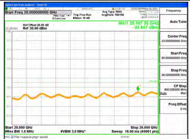
B7-20G-26G / 20MHz / Mid CH / QPSK
