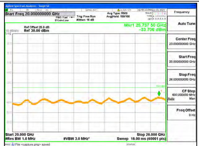
B7-20G-26G / 20MHz / High CH / QPSK
