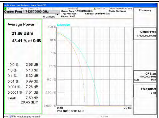
B4 / 5MHz / Low CH / 16QAM
