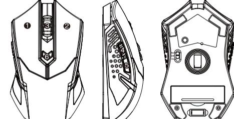
Botão direito + rodrinha, pressione ambos os botões por 5 segundos para alternar a velocidade de leitura entre 125 Hz e 250 Hz (o padrão é 125 Hz).
