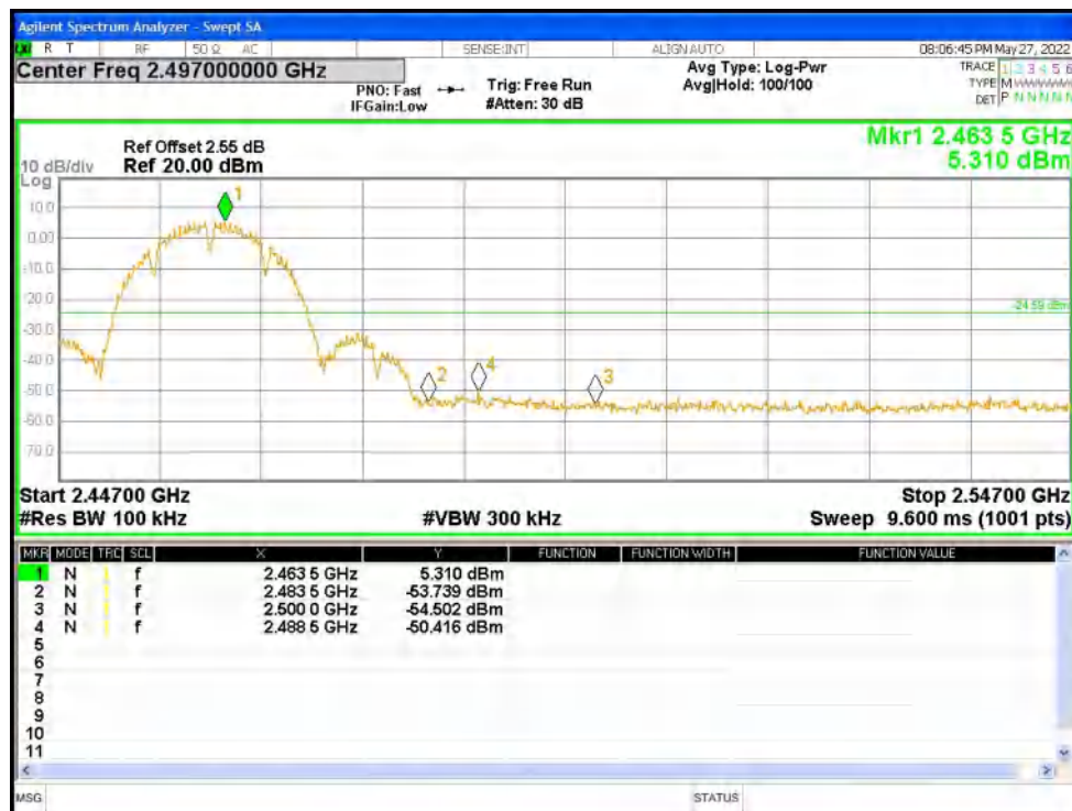
Band Edge NVNT g 2412MHz Ant1 Ref
