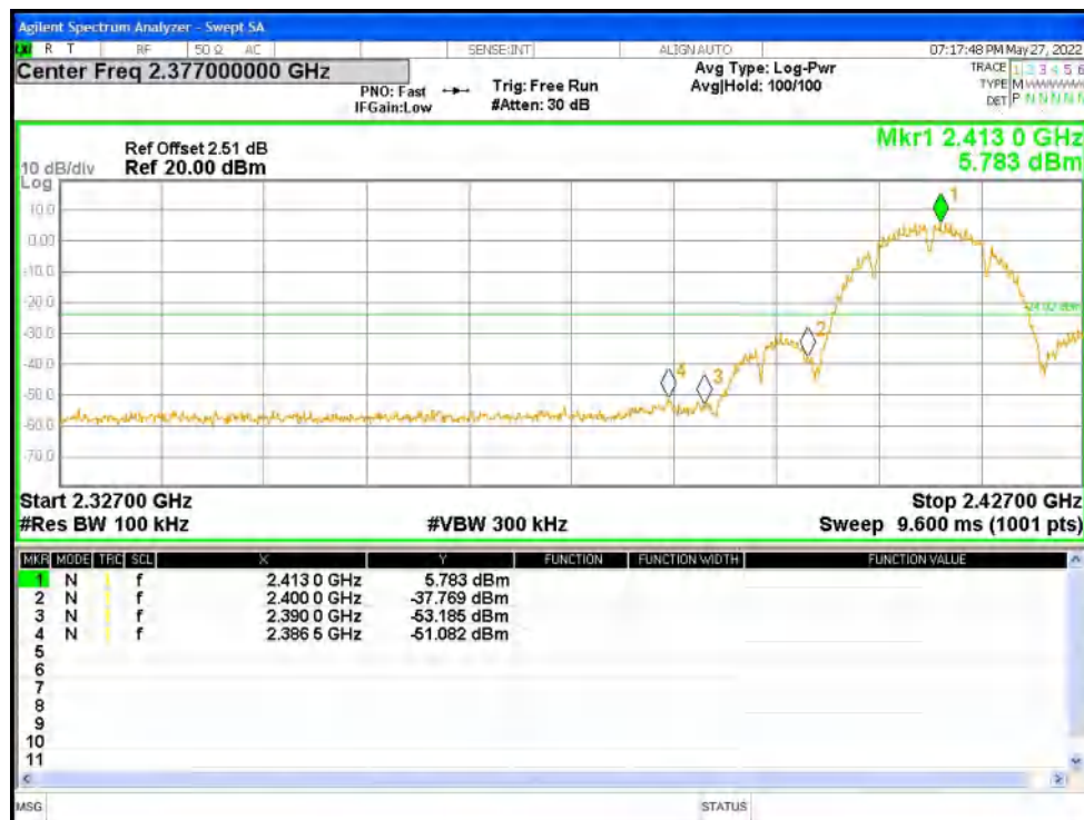
Band Edge NVNT b 2462MHz Ant1 Ref
