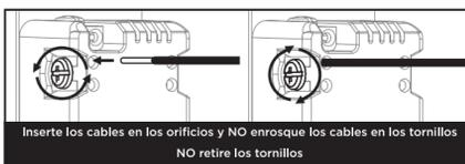
Inserte los cables en los orificios y NO enrosque los cables en los tornillos. NO retire los tornillos.
