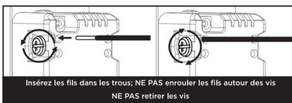
Insérez les fils dans les trous; NE PAS enrouler les fils autour des vis. NE PAS retirer les vis.
