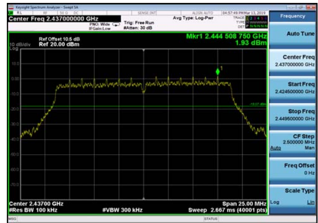
,Plot 2,Band Edge-802.11n(HT20) ,2412MHz
