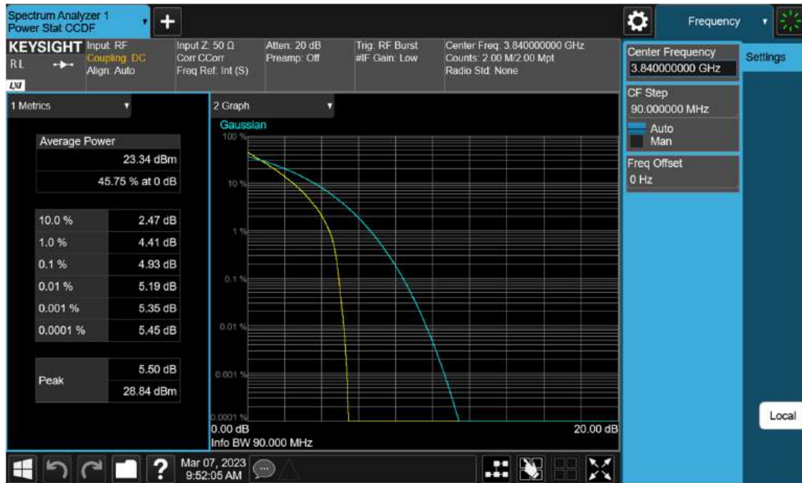
Sub6 n77(78). PAR Plot (90 M BW_Ch.656000_QPSK)
