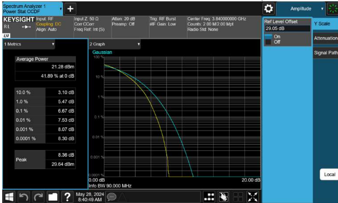
Sub6 n77(78). PAR Plot (90 M BW_Ch.656000_256 QAM)
