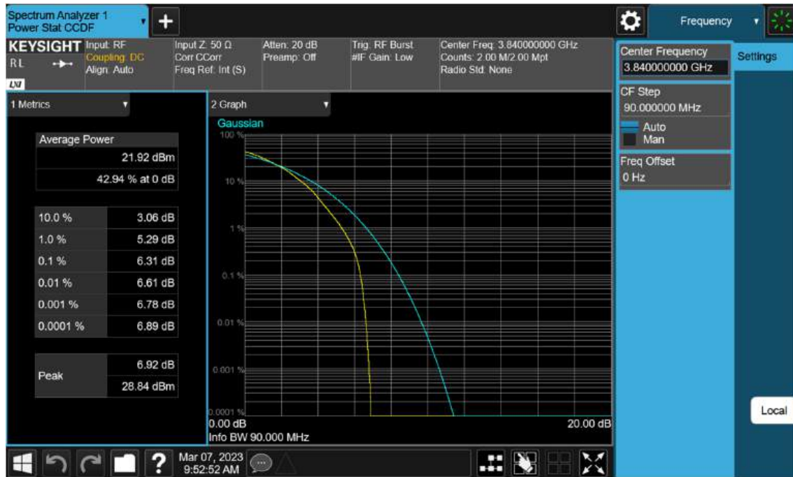
Sub6 n77(78). PAR Plot (90 M BW_Ch.656000_64 QAM)
