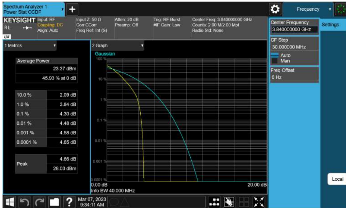
Sub6 n77(78). PAR Plot (40 M BW_Ch.656000_ BPSK)
