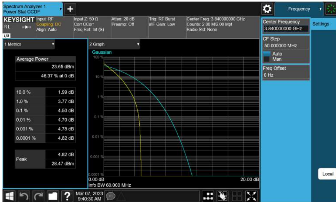
Sub6 n77(78). PAR Plot (60 M BW_Ch.656000_ BPSK)
