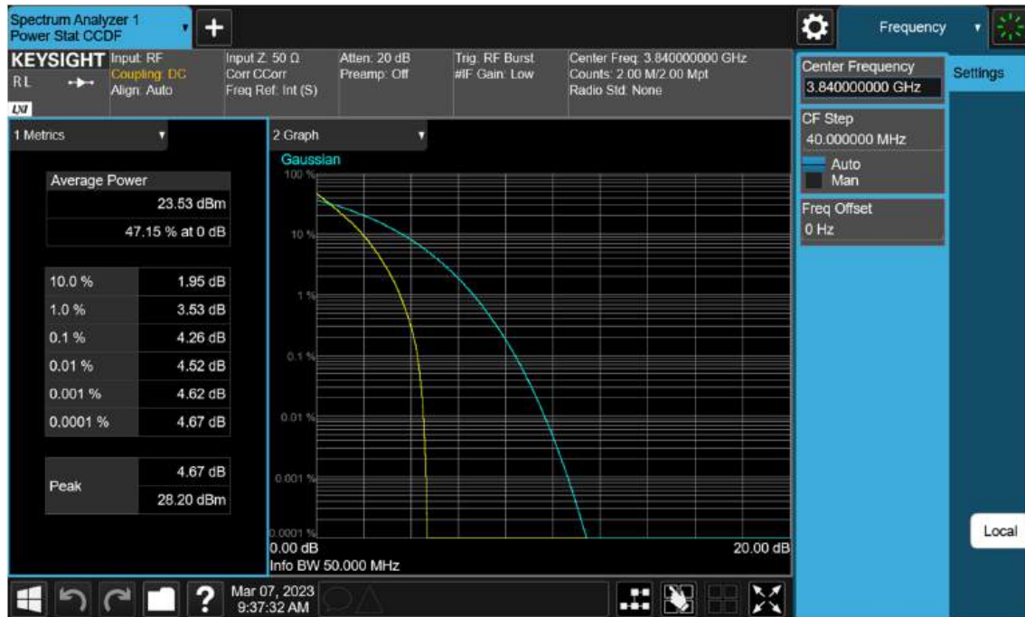
Sub6 n77(78). PAR Plot (50 M BW_Ch.656000_ BPSK)
