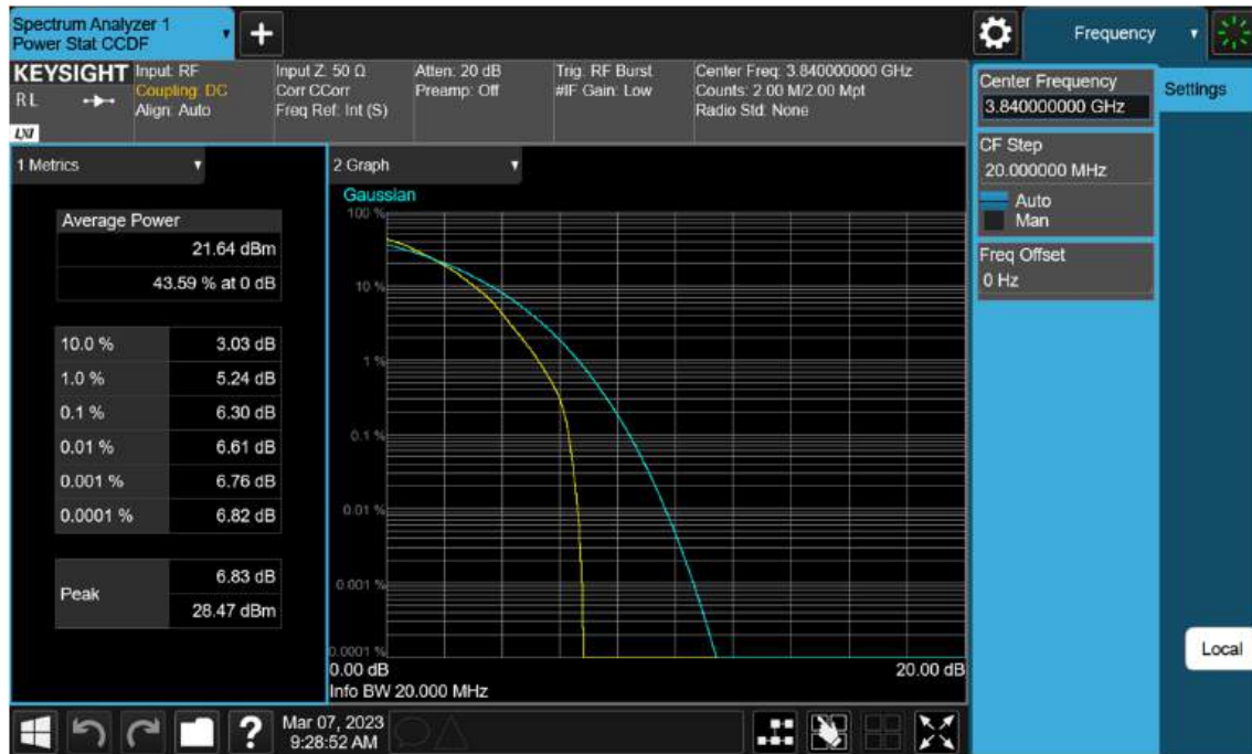
Sub6 n77(78). PAR Plot (20 M BW_Ch.656000_64 QAM)
