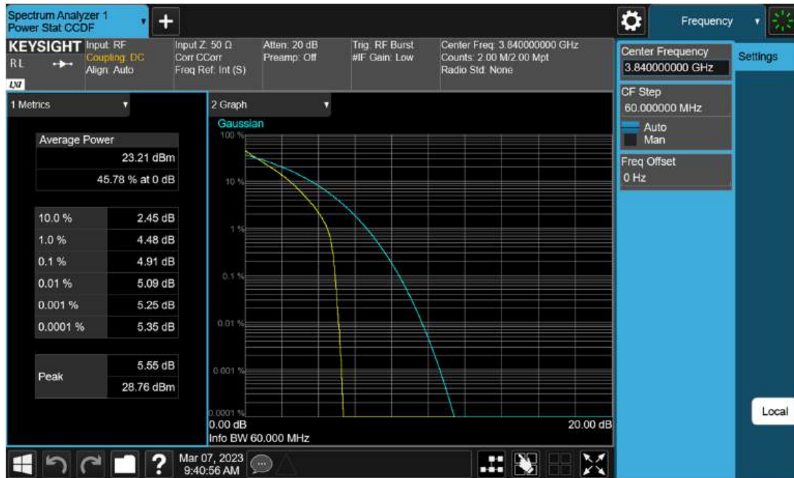
Sub6 n77(78). PAR Plot (60 M BW_Ch.656000_QPSK)
