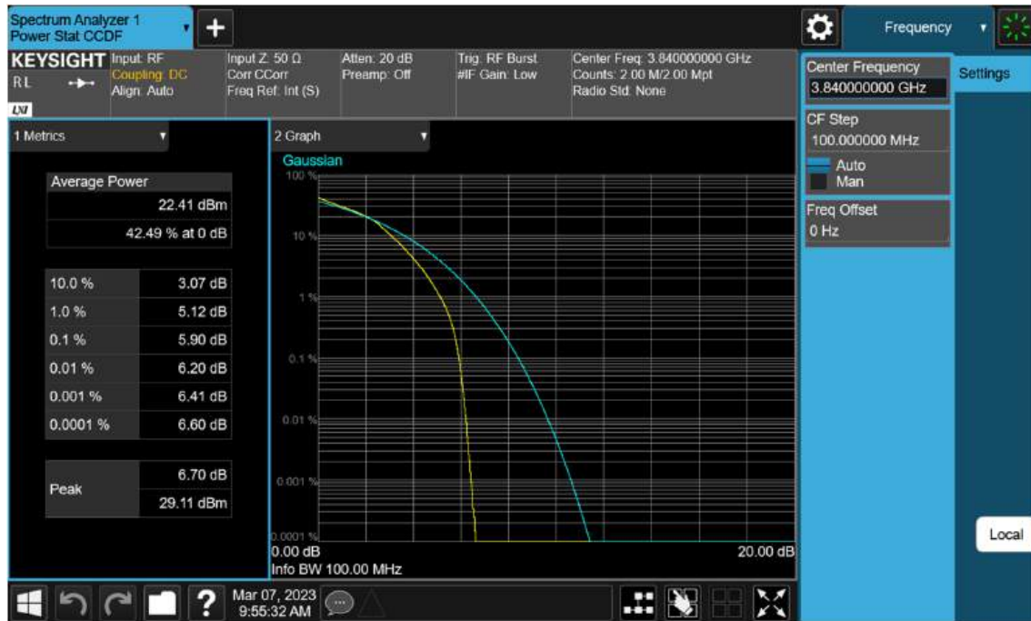
Sub6 n77(78). PAR Plot (100 M BW_Ch.656000_16QAM)
