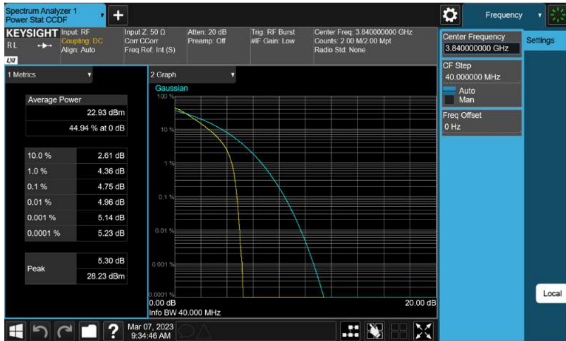
Sub6 n77(78). PAR Plot (40 M BW_Ch.656000_QPSK)
