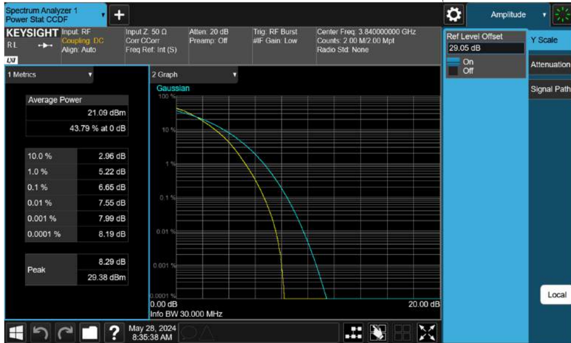
Sub6 n77(78). PAR Plot (30 M BW_Ch.656000_256 QAM)
