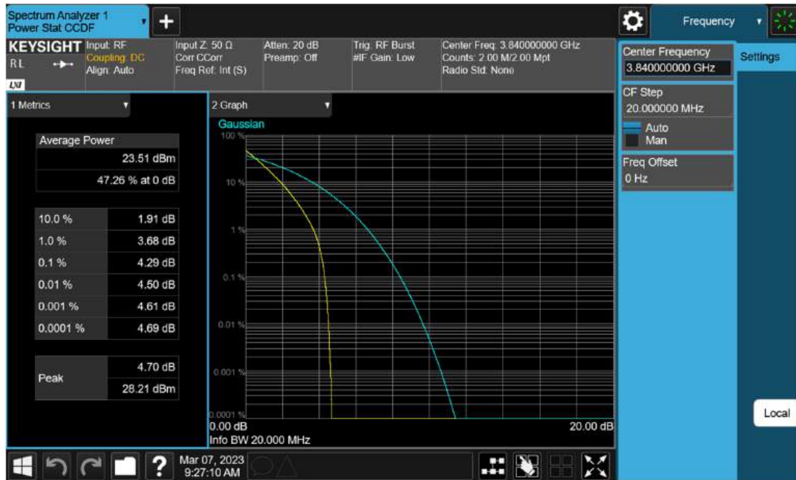
Sub6 n77(78). PAR Plot (20 M BW_Ch.656000_ BPSK)
