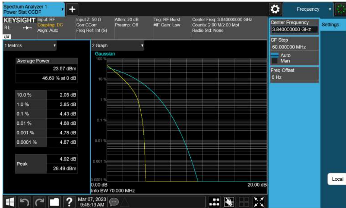
Sub6 n77(78). PAR Plot (70 M BW_Ch.656000_ BPSK)
