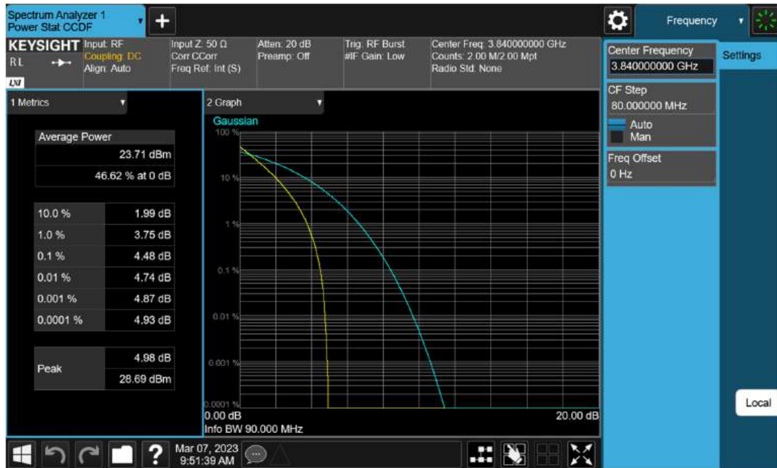
Sub6 n77(78). PAR Plot (90 M BW_Ch.656000_ BPSK)
