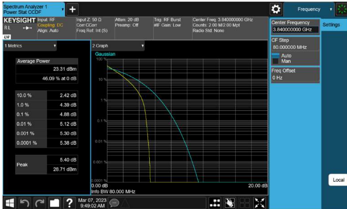
Sub6 n77(78). PAR Plot (80 M BW_Ch.656000_QPSK)
