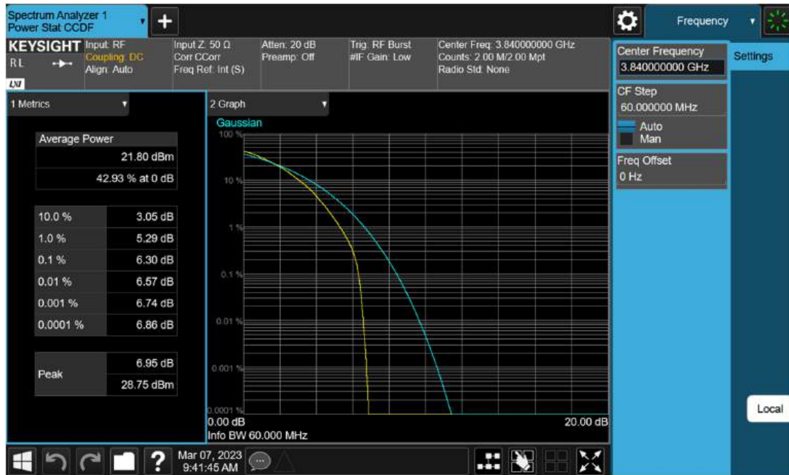
Sub6 n77(78). PAR Plot (60 M BW_Ch.656000_64 QAM)
