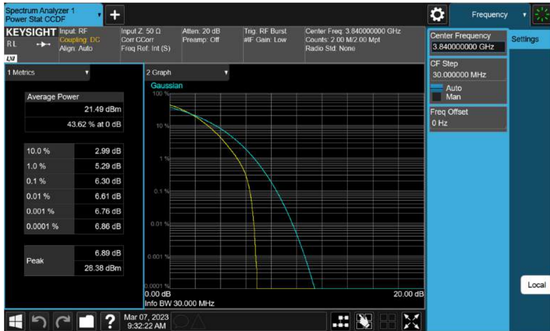
Sub6 n77(78). PAR Plot (30 M BW_Ch.656000_64 QAM)
