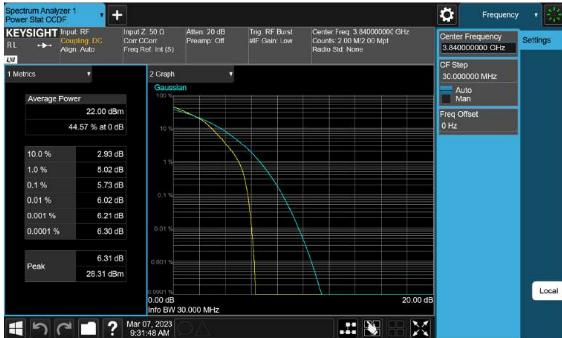
Sub6 n77(78). PAR Plot (30 M BW_Ch.656000_16QAM)
