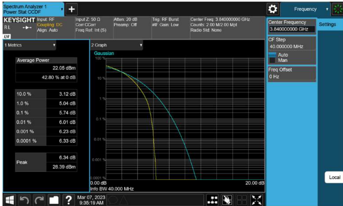
Sub6 n77(78). PAR Plot (40 M BW_Ch.656000_16QAM)
