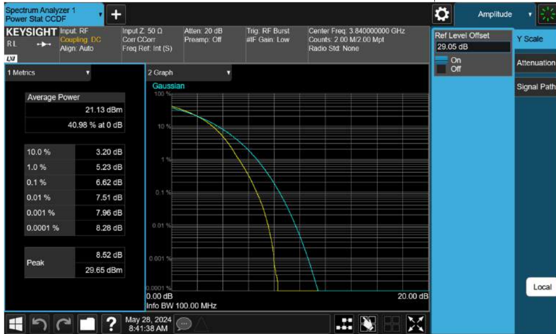
Sub6 n77(78). PAR Plot (100 M BW_Ch.656000_256 QAM)
