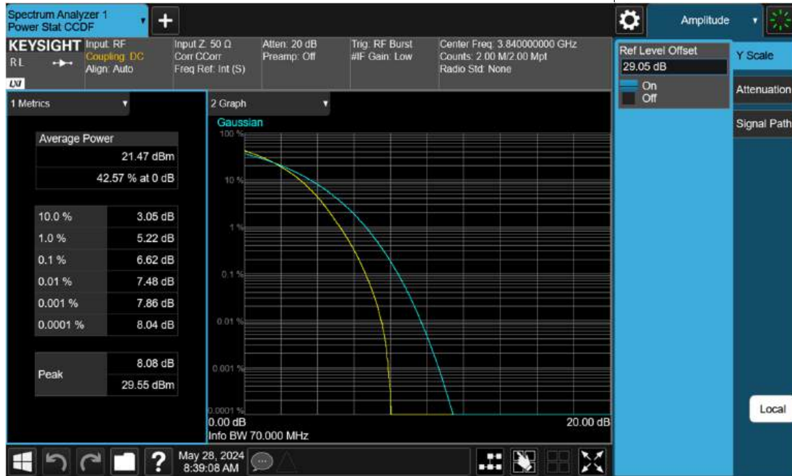
Sub6 n77(78). PAR Plot (70 M BW_Ch.656000_256 QAM)
