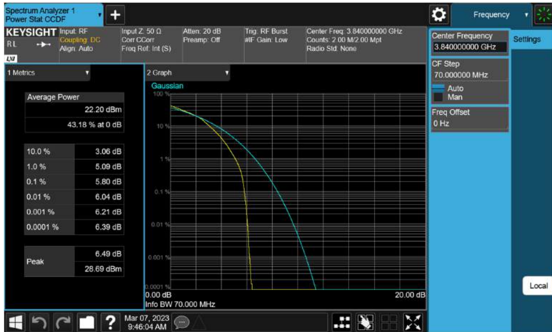
Sub6 n77(78). PAR Plot (70 M BW_Ch.656000_16QAM)
