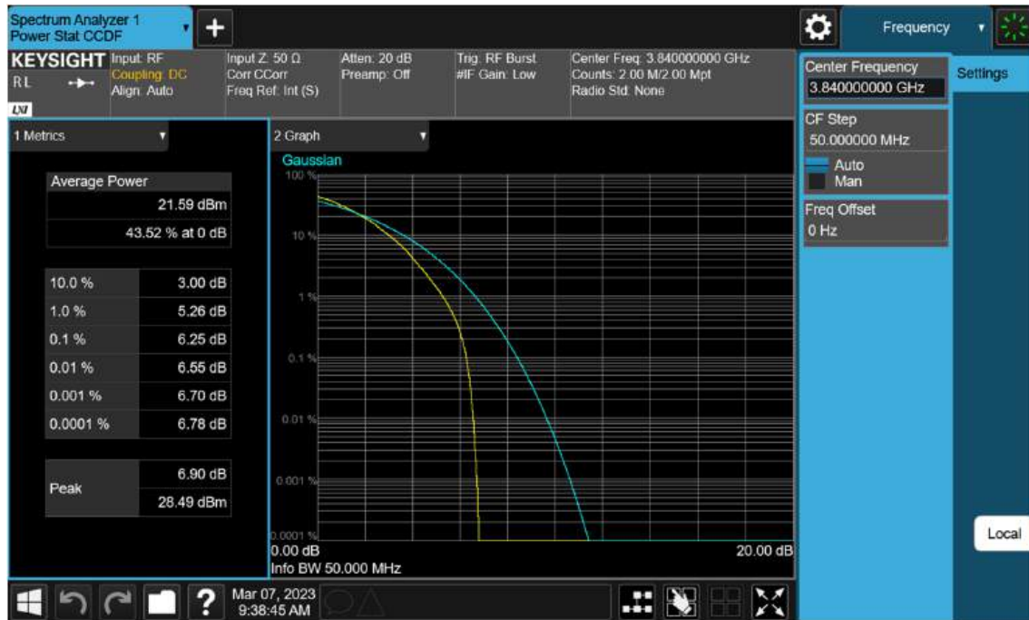
Sub6 n77(78). PAR Plot (50 M BW_Ch.656000_64 QAM)
