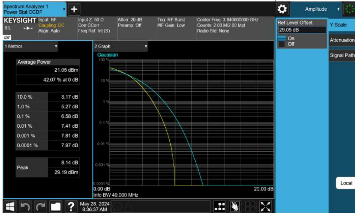
Sub6 n77(78). PAR Plot (40 M BW_Ch.656000_256 QAM)
