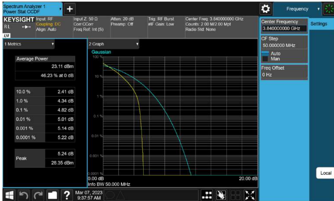
Sub6 n77(78). PAR Plot (50 M BW_Ch.656000_QPSK)
