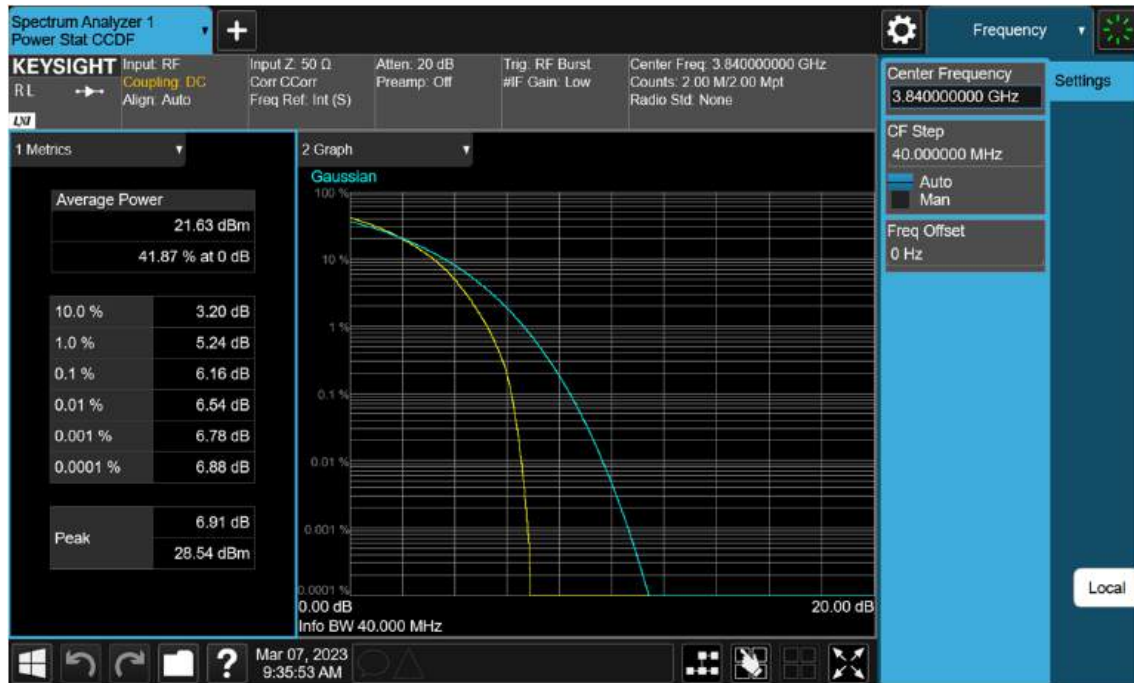
Sub6 n77(78). PAR Plot (40 M BW_Ch.656000_64 QAM)
