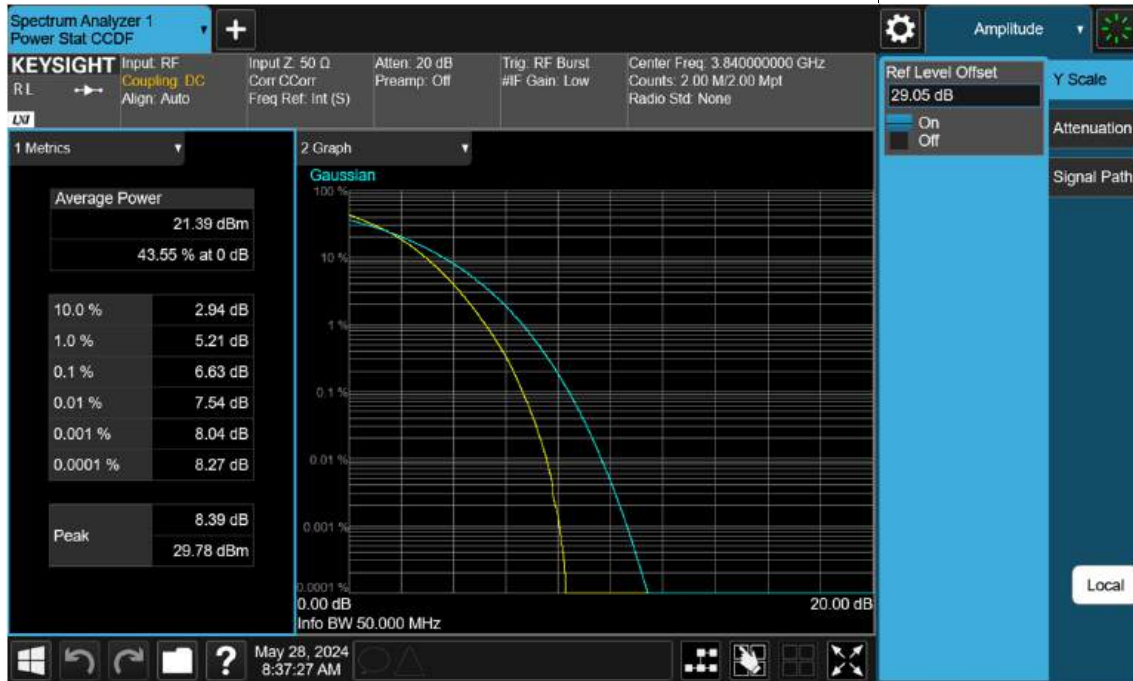
Sub6 n77(78). PAR Plot (50 M BW_Ch.656000_256 QAM)
