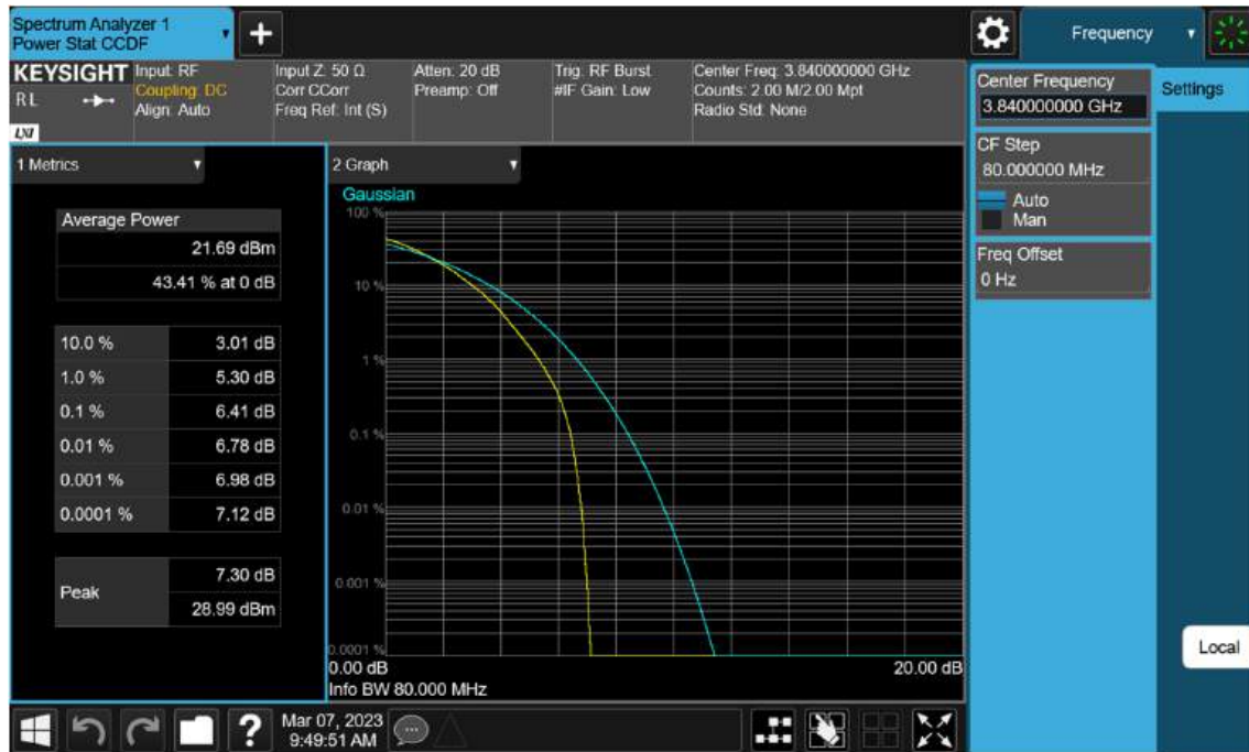
Sub6 n77(78). PAR Plot (80 M BW_Ch.656000_64 QAM)
