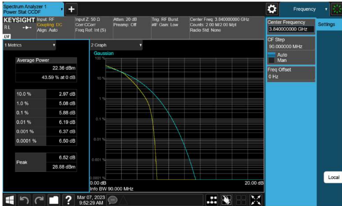
Sub6 n77(78). PAR Plot (90 M BW_Ch.656000_16QAM)
