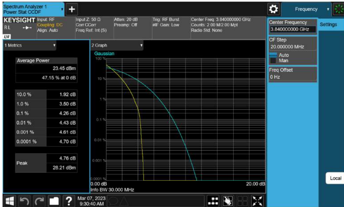
Sub6 n77(78). PAR Plot (30 M BW_Ch.656000_ BPSK)
