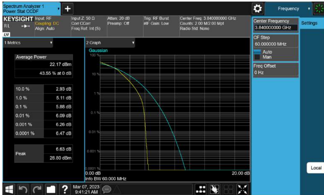
Sub6 n77(78). PAR Plot (60 M BW_Ch.656000_16QAM)
