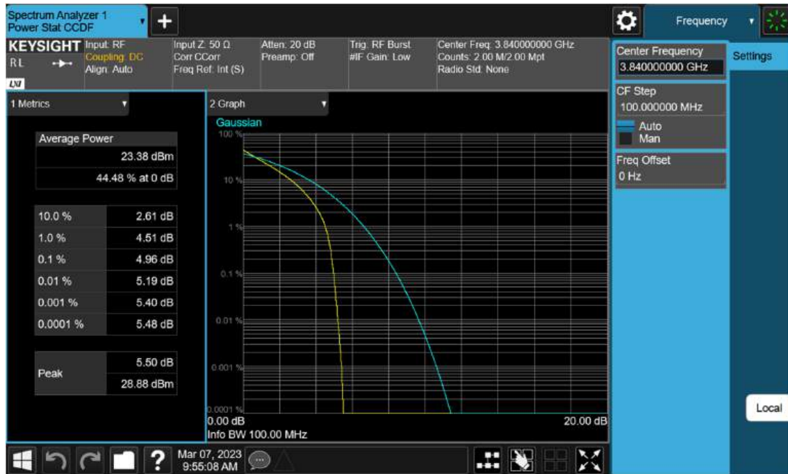
Sub6 n77(78). PAR Plot (100 M BW_Ch.656000_QPSK)
