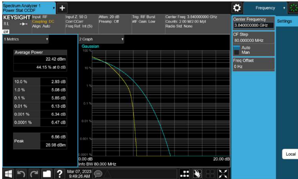
Sub6 n77(78). PAR Plot (80 M BW_Ch.656000_16QAM)
