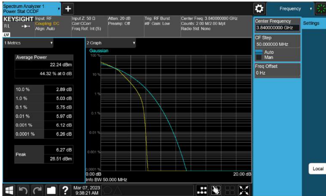
Sub6 n77(78). PAR Plot (50 M BW_Ch.656000_16QAM)
