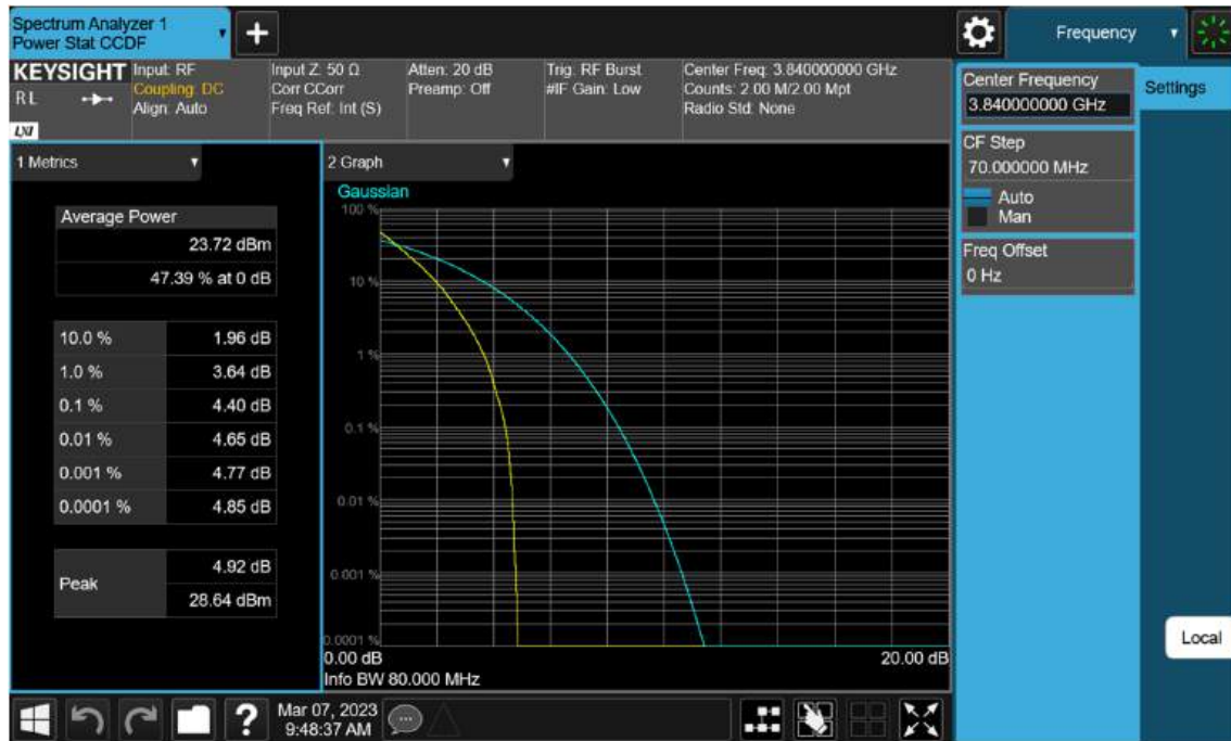
Sub6 n77(78). PAR Plot (80 M BW_Ch.656000_ BPSK)
