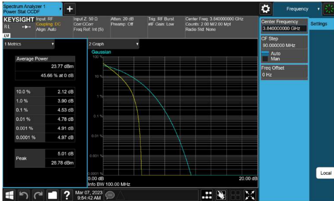
Sub6 n77(78). PAR Plot (100 M BW_Ch.656000_ BPSK)
