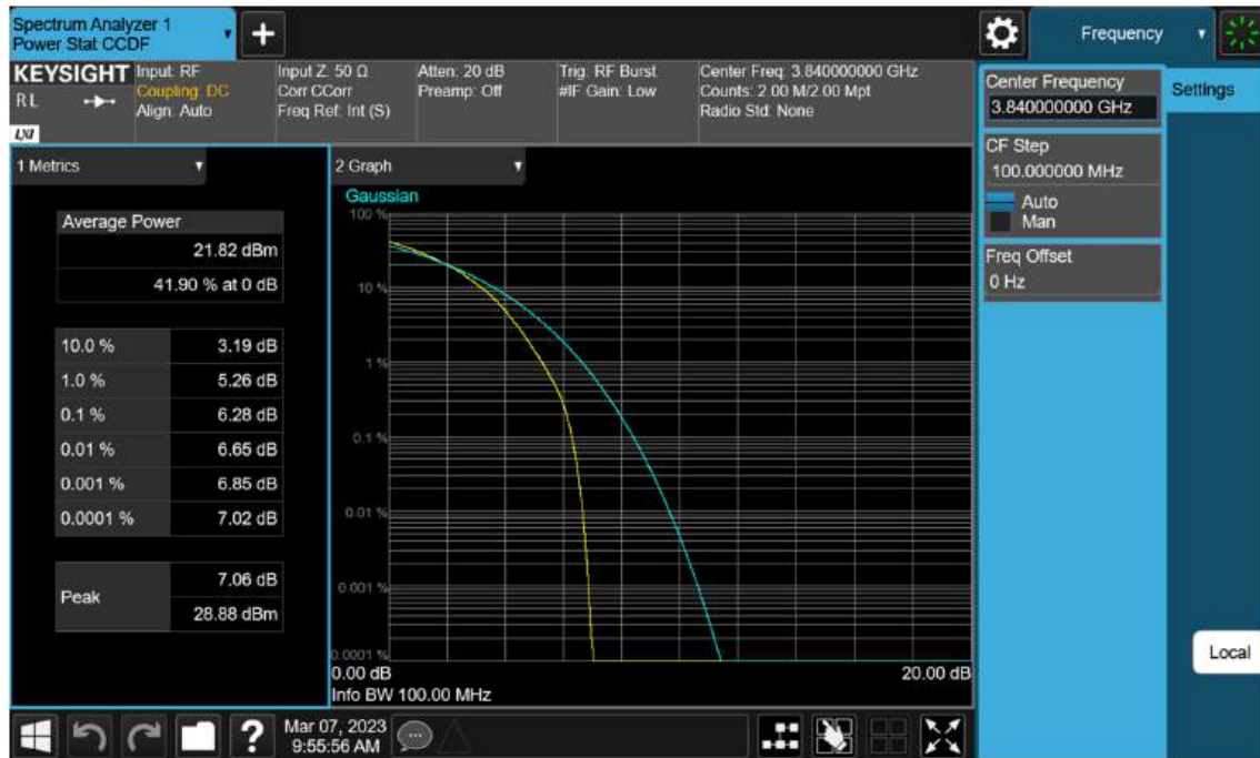
Sub6 n77(78). PAR Plot (100 M BW_Ch.656000_64 QAM)
