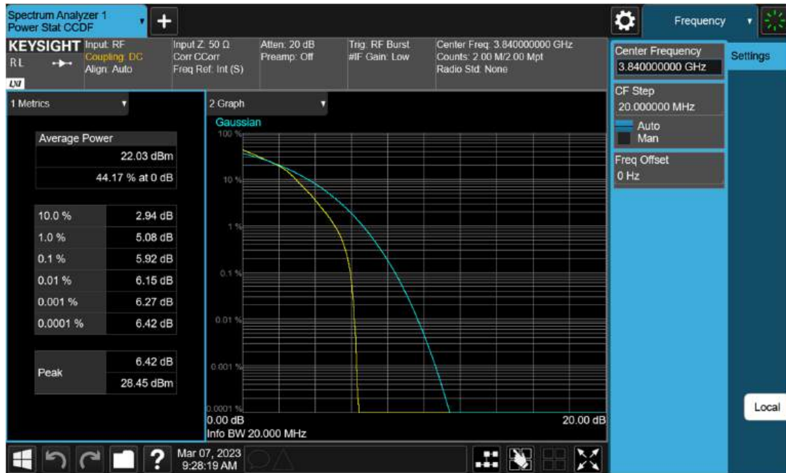
Sub6 n77(78). PAR Plot (20 M BW_Ch.656000_16QAM)
