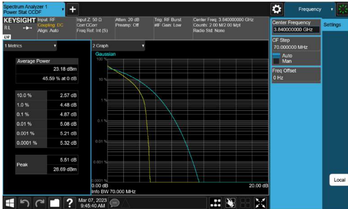
Sub6 n77(78). PAR Plot (70 M BW_Ch.656000_QPSK)
