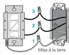
1 Raccordez le fil de « mise à la terre » nu en cuivre (ou vert) du boîtier mural au fil vert du gradateur à l'aide d'un connecteur de fils.
