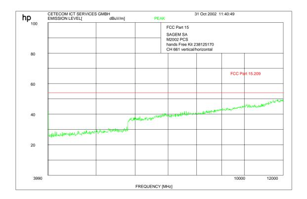
$f < 1 \text{ GHz} : RBW/VBW} : 100 \text{ kHz}$   $f \ge 1 \text{ GHz} : RBW 1 \text{ MHz}/VBW} : 10 \text{ Hz} \text{ (Average)}$
