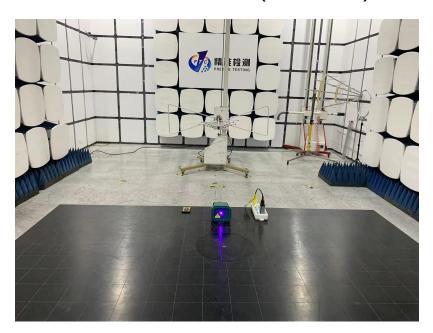
RADIATED EMISSION TEST (1GHz-6GHz)
