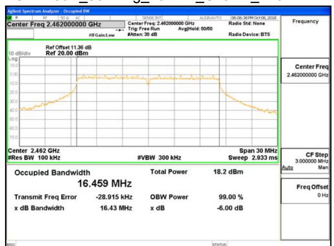
OBW 6dB 802.11g 20MHz Chain1 2462MHz
