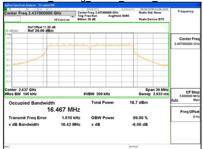
OBW 6dB 802.11g 20MHz Chain1 2462MHz
