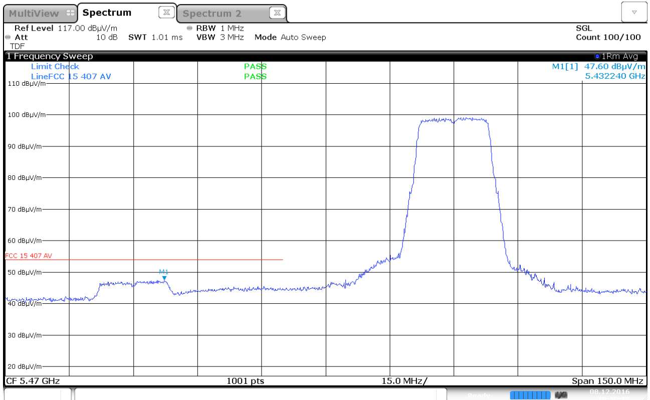
Band Edge RMS, < 5460MHz, 5500MHz, 802.11a 6Mb, Ant 1
