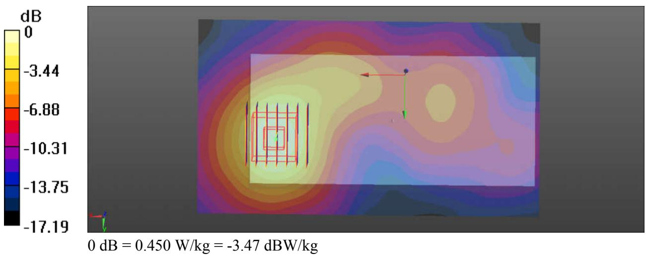
**58\_LTE Band 7\_20M\_QPSK\_1RB\_99Offset\_Back\_15mm\_Ch20850**
