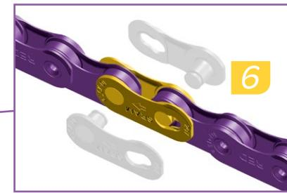
Puxe ambas as extremidades da corrente, juntando-as, e instale o PowerLock. Comprima os elementos de ligação do PowerLock juntando-os.
