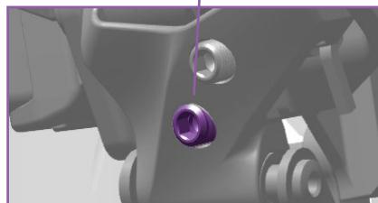
**如果难以将链条从大链环变速至小链环上：**请将前变速器置于内侧位置，同时将低限位螺钉逆时针转动1/8圈，然后再评估。请重复此步骤，直至链条可顺畅地从大链环变速至小链环上。
