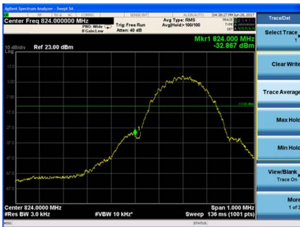
LTE Band 5 QPSK 1.4MHz CH-Low 1RB
