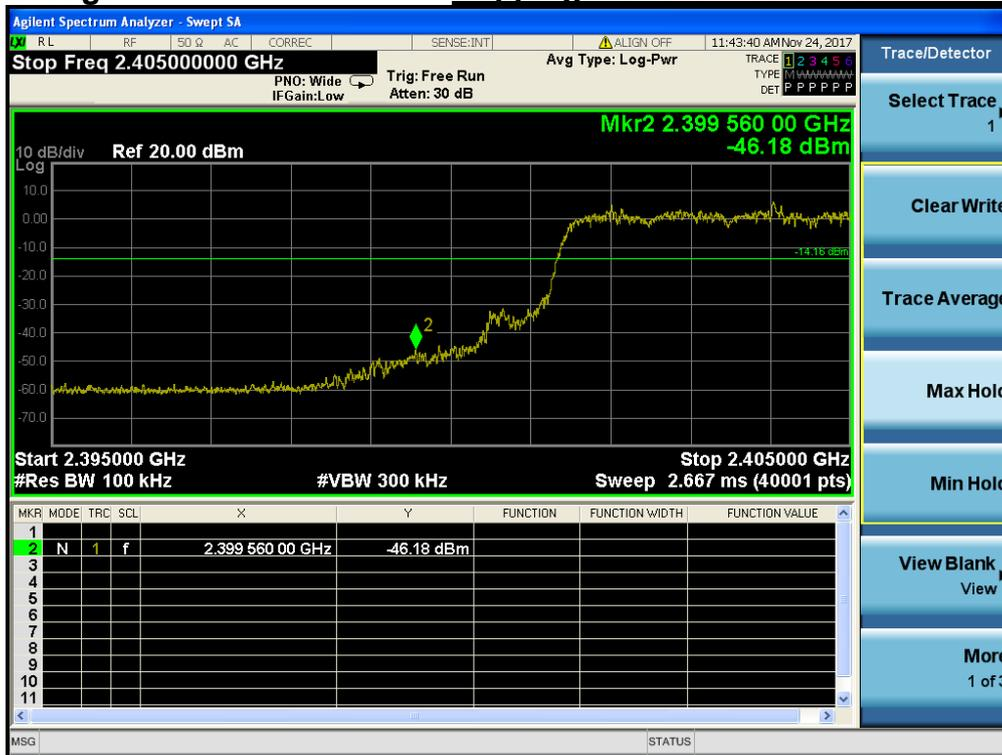
**Conducted Spurious Emissions**      **Lowest Channel & Modulation :  $\pi/4$ DQPSK**
