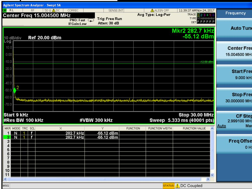
Conducted Spurious Emissions *Middle Channel & Modulation :  $\pi/4$ DQPSK*
