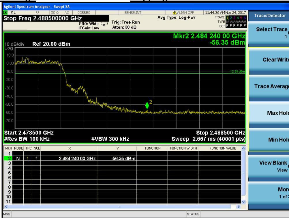
Conducted Spurious Emissions **Highest Channel & Modulation :  $\pi/4$ DQPSK**
