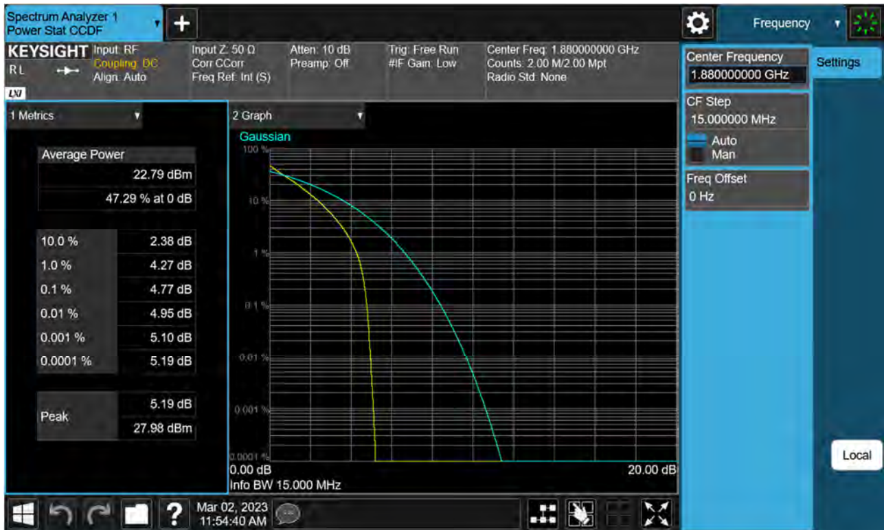
Sub6 n2. PAR Plot (15 M BW Ch.376000 QPSK RB 75_0)
