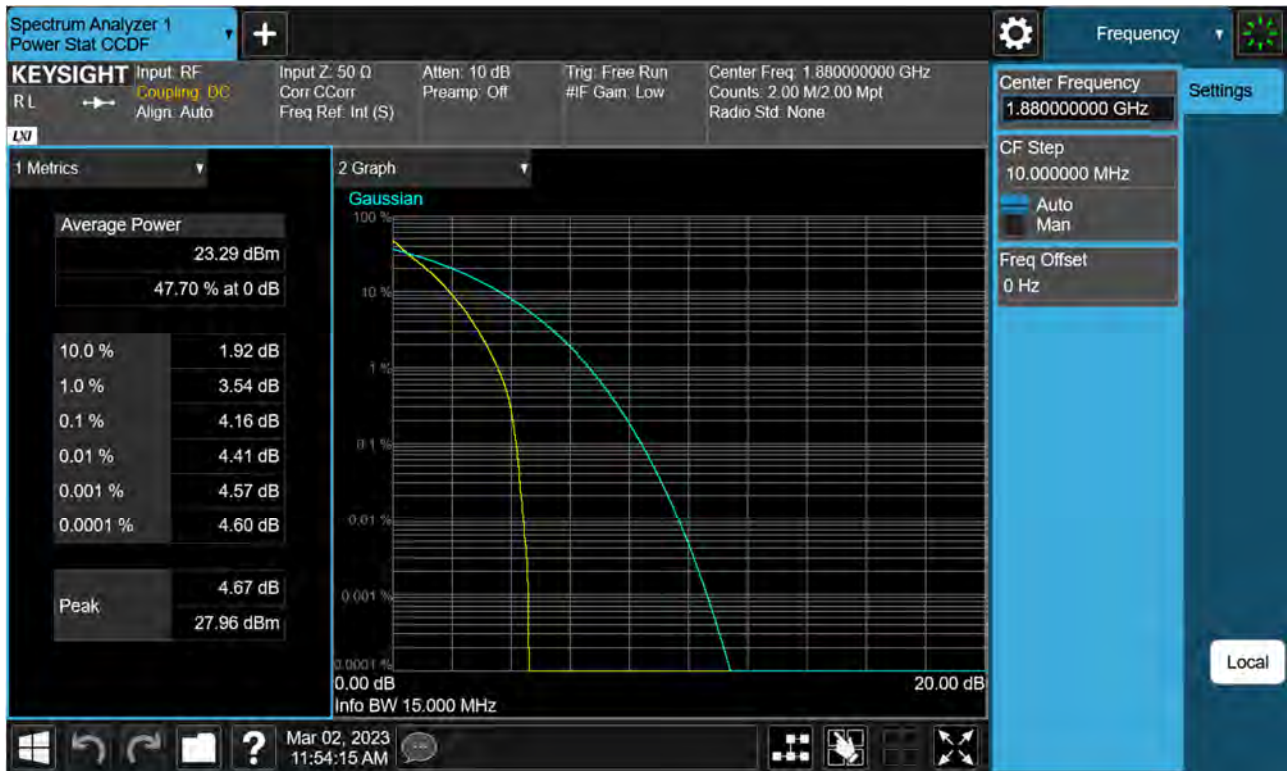
Sub6 n2. PAR Plot (15 M BW Ch.376000 BPSK RB 75_0)
