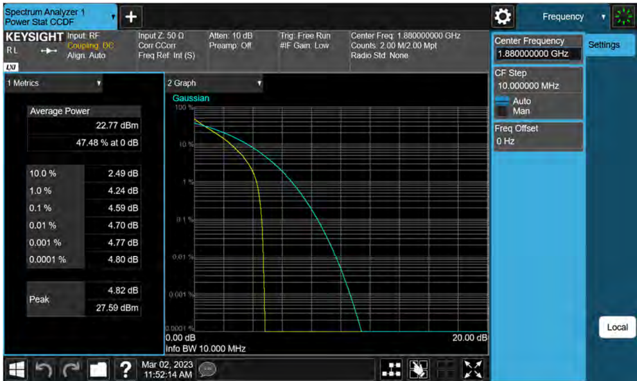
Sub6 n2. PAR Plot (10 M BW Ch.376000 QPSK RB 50_0)
