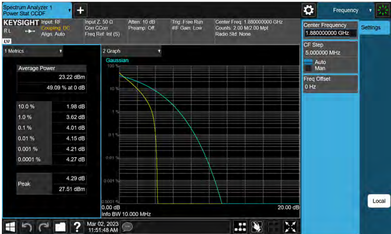
Sub6 n2. PAR Plot (10 M BW Ch.376000 BPSK RB 50_0)
