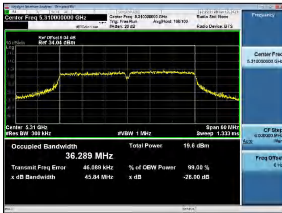
-26dB Bandwidth NVNT n40 5310MHz Ant1
