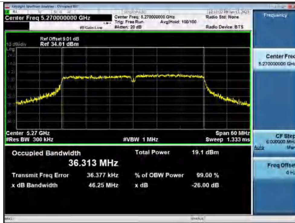
-26dB Bandwidth NVNT n40 5310MHz Ant1
