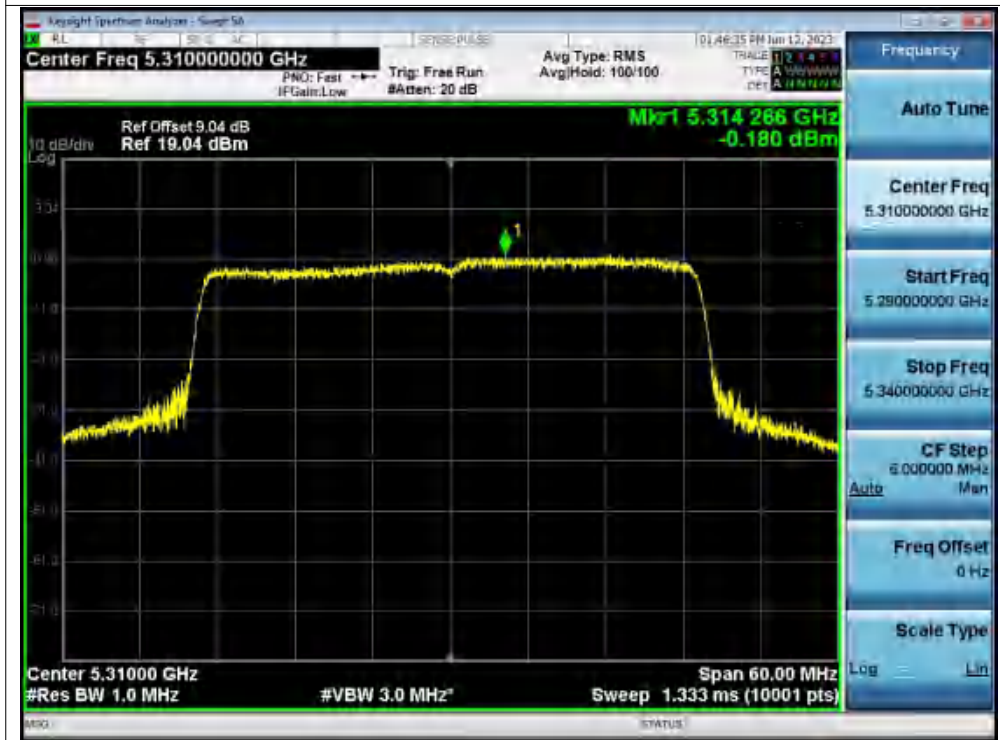
PSD NVNT ax40 5310MHz Ant1
