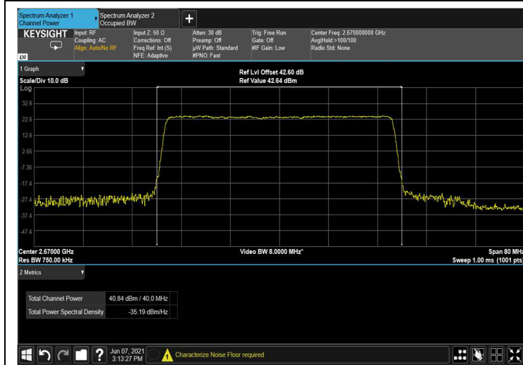
Figure 46: 256QAM 40MHz B.W.; 2670.0MHz, 60kHz
