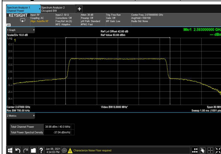
Figure 61: QPSK 40MHz B.W.; 2670.0MHz, 60kHz
