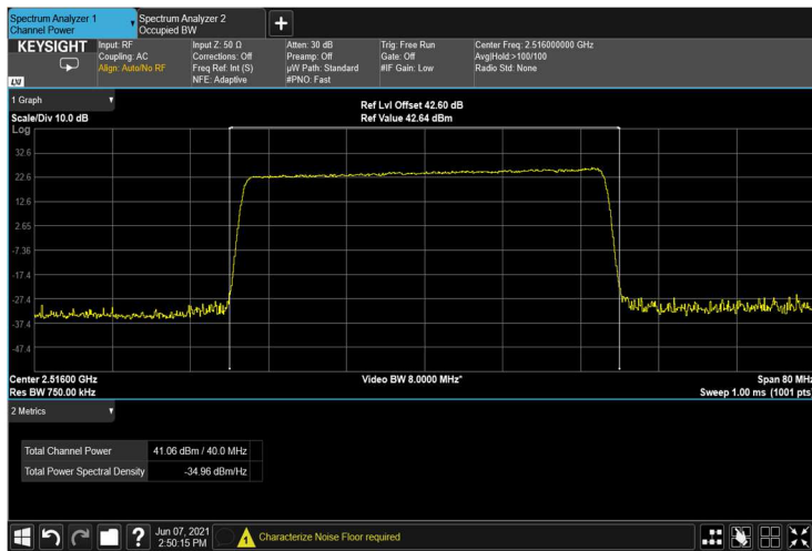
Figure 25: 64QAM 40MHz B.W.; 2516.0MHz, 60kHz
