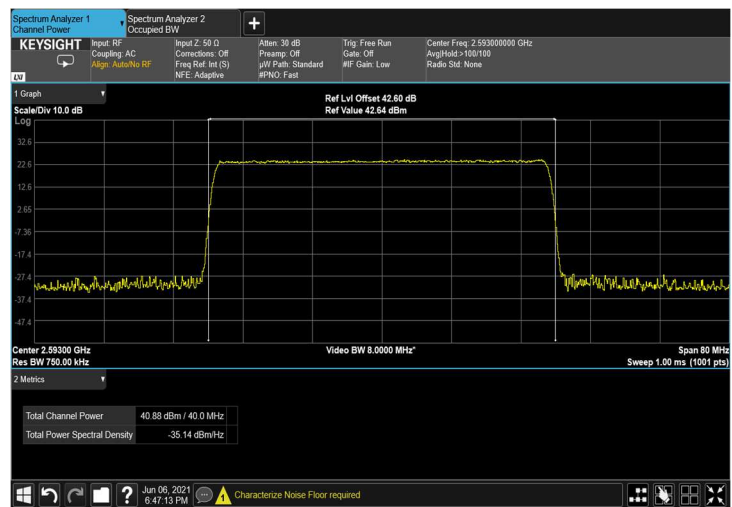
Figure 27: 64QAM 40MHz B.W.; 2593.0MHz, 30kHz
