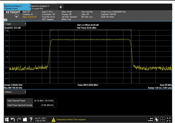
Figure 41: 256QAM 40MHz B.W.; 2593.0MHz, 15kHz
