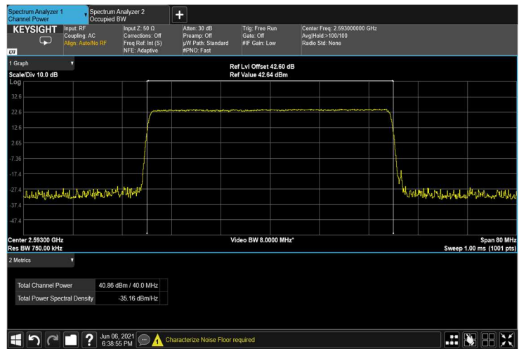
Figure 26: 64QAM 40MHz B.W.; 2593.0MHz, 15kHz
