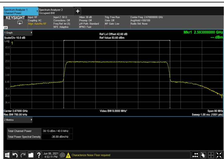
Figure 60: QPSK 40MHz B.W.; 2670.0MHz, 30kHz
