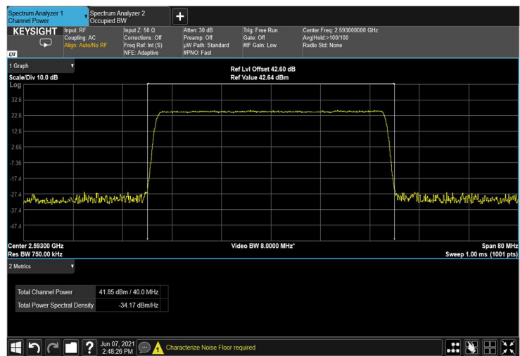
Figure 28: 64QAM 40MHz B.W.; 2593.0MHz, 60kHz
