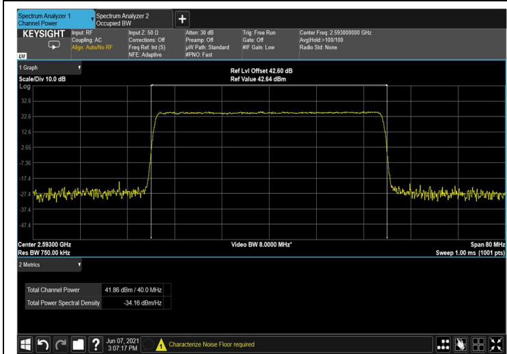
Figure 42: 256QAM 40MHz B.W.; 2593.0MHz, 30kHz
