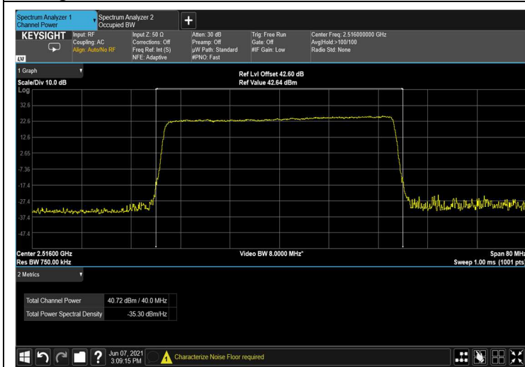
Figure 40: 256QAM 40MHz B.W.; 2516.0MHz, 60kHz
