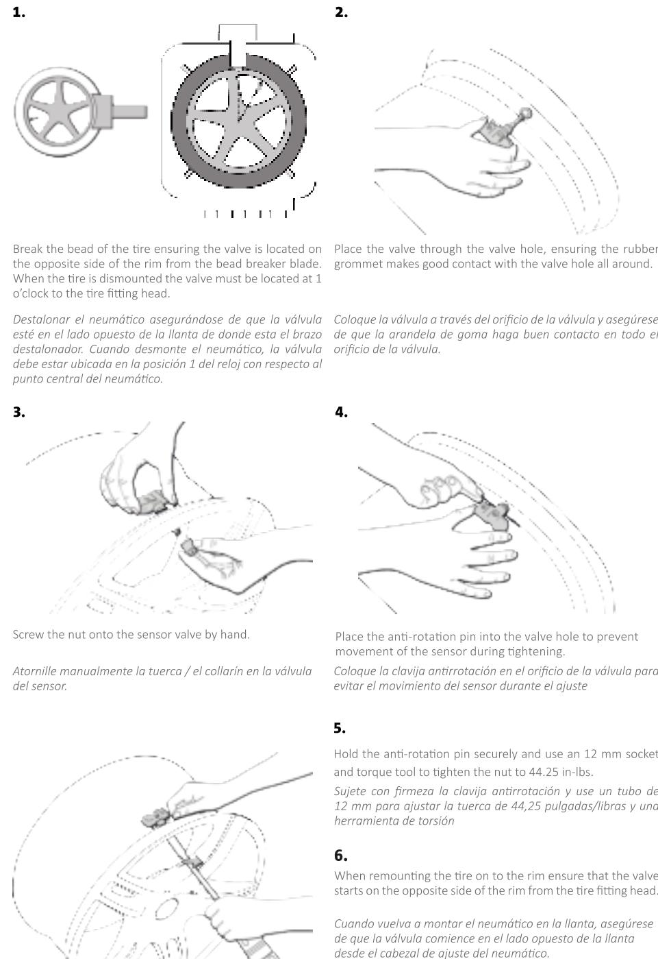
Cuando vuelva a montar el neumático en la llanta, asegúrese de que la válvula comience en el lado opuesto de la llanta desde el cabezal de ajuste del neumático.
