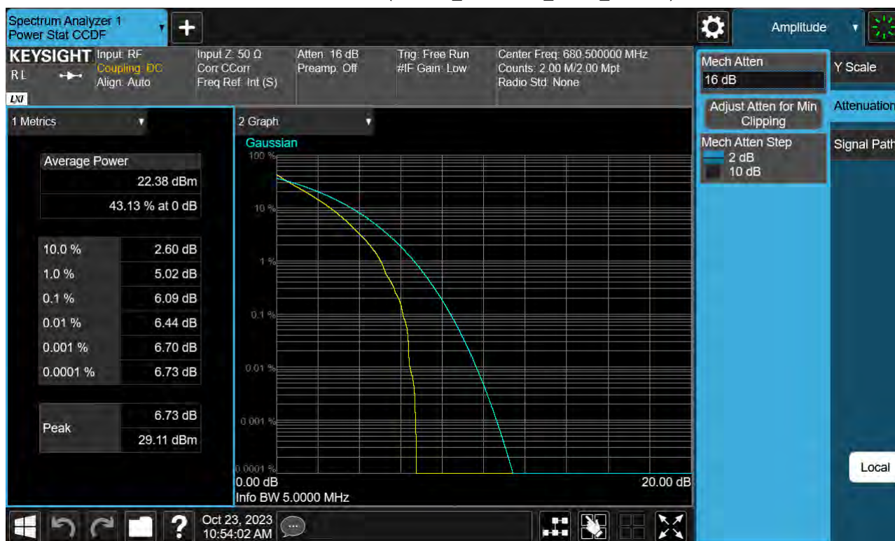
Sub6 n71. PAR Plot (5 M BW_Ch.349000_QPSK_Full RB)
