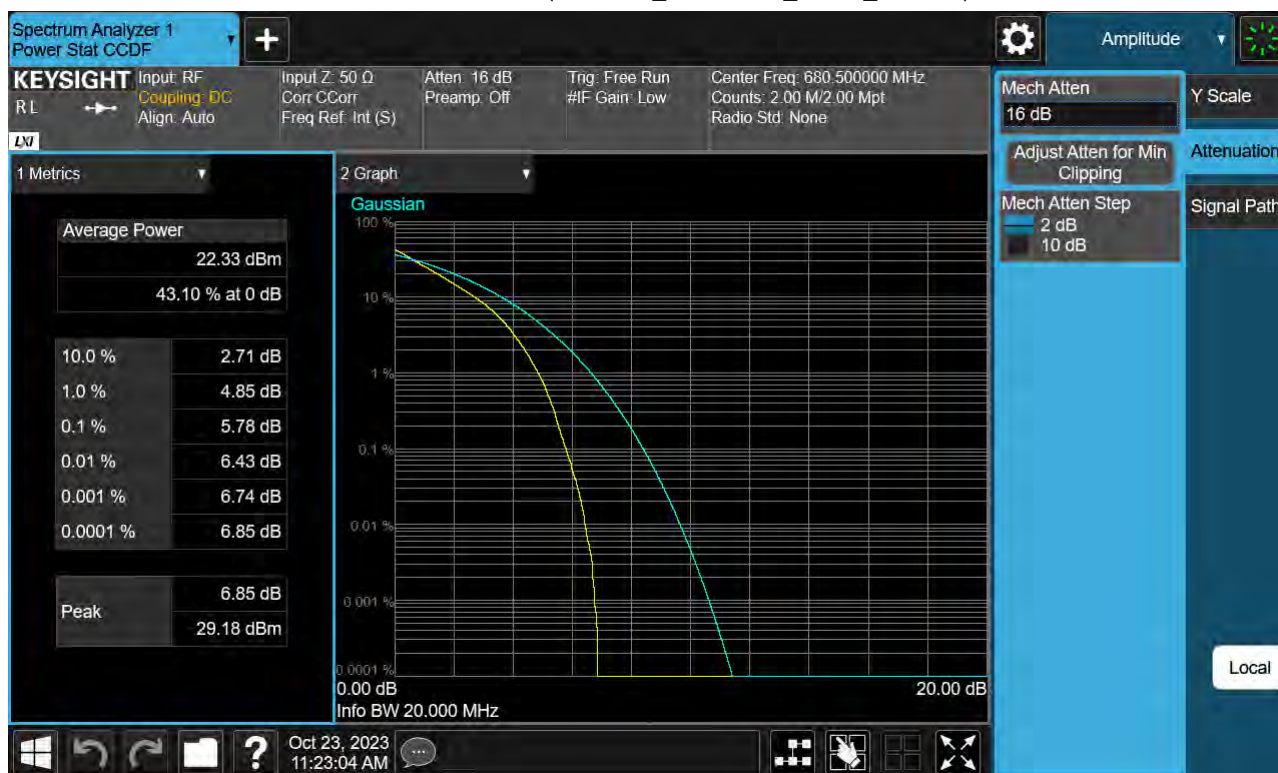
Sub6 n71. PAR Plot (20 M BW_Ch.349000_QPSK_Full RB)
