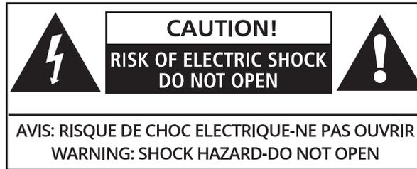
Cet éclair avec symbole en forme de flèche dans un triangle équilatéral a pour but d'alerter l'utilisateur de la présence d'une "tension électrique dangereuse" non isolée dans l'enceinte du produit, qui peut être d'une amplitude suffisante pour constituer un risque de choc électrique.
