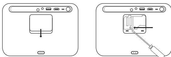
プロジェクターのダストカバーを取り外し、次にドライバーを使ってシーリングカバーを取り外します。
