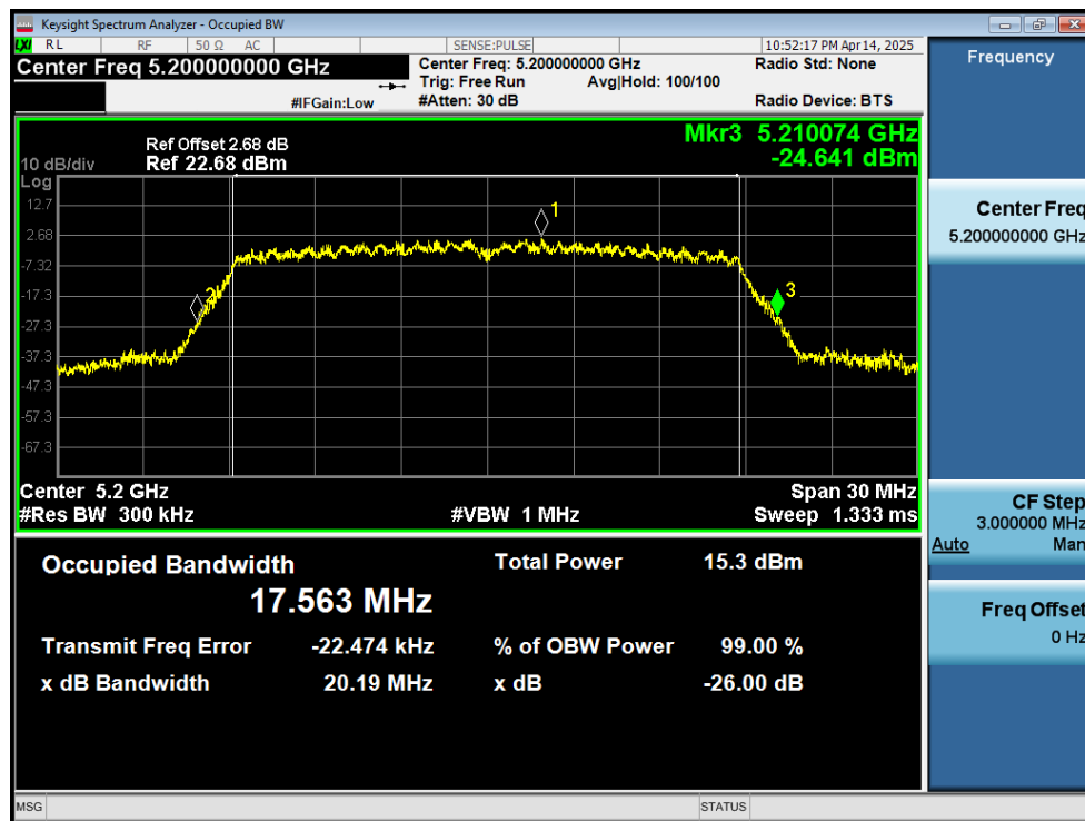
-26dB Bandwidth NVNT ac20 5200MHz Ant1
