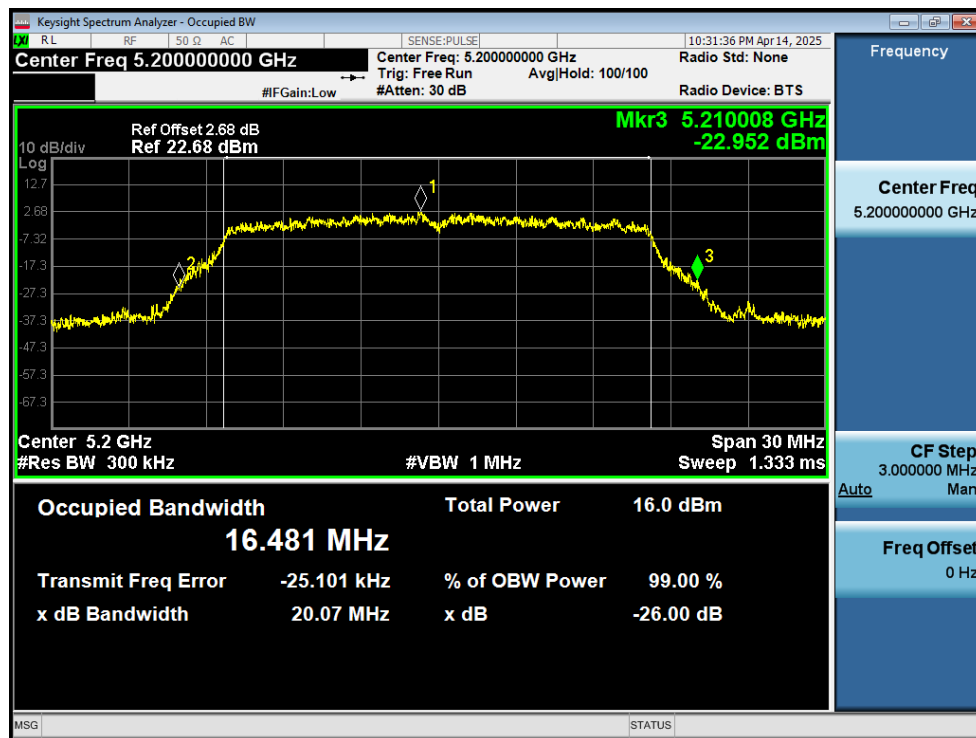
-26dB Bandwidth NVNT a 5200MHz Ant1
