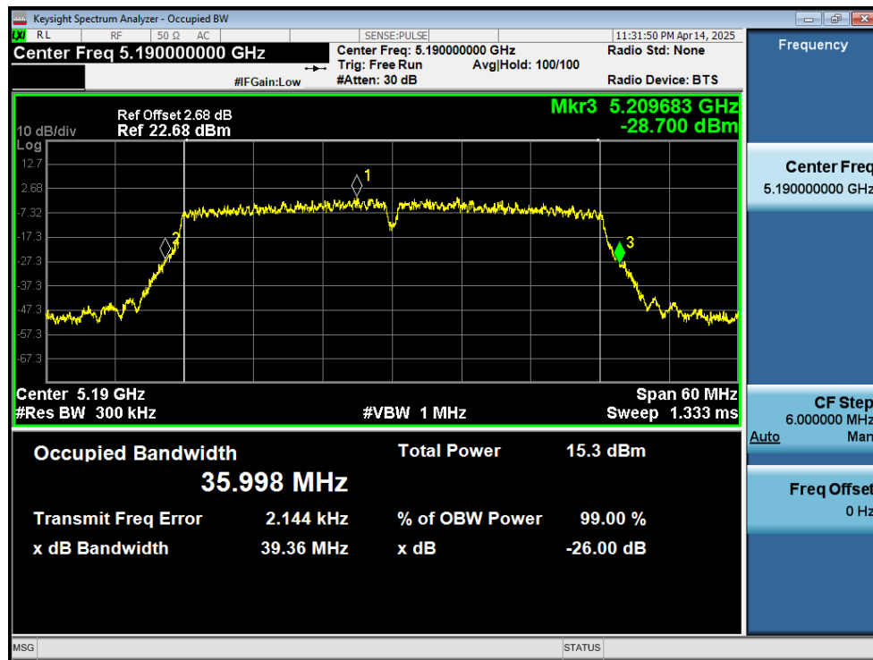
-26dB Bandwidth NVNT n40 5190MHz Ant1
