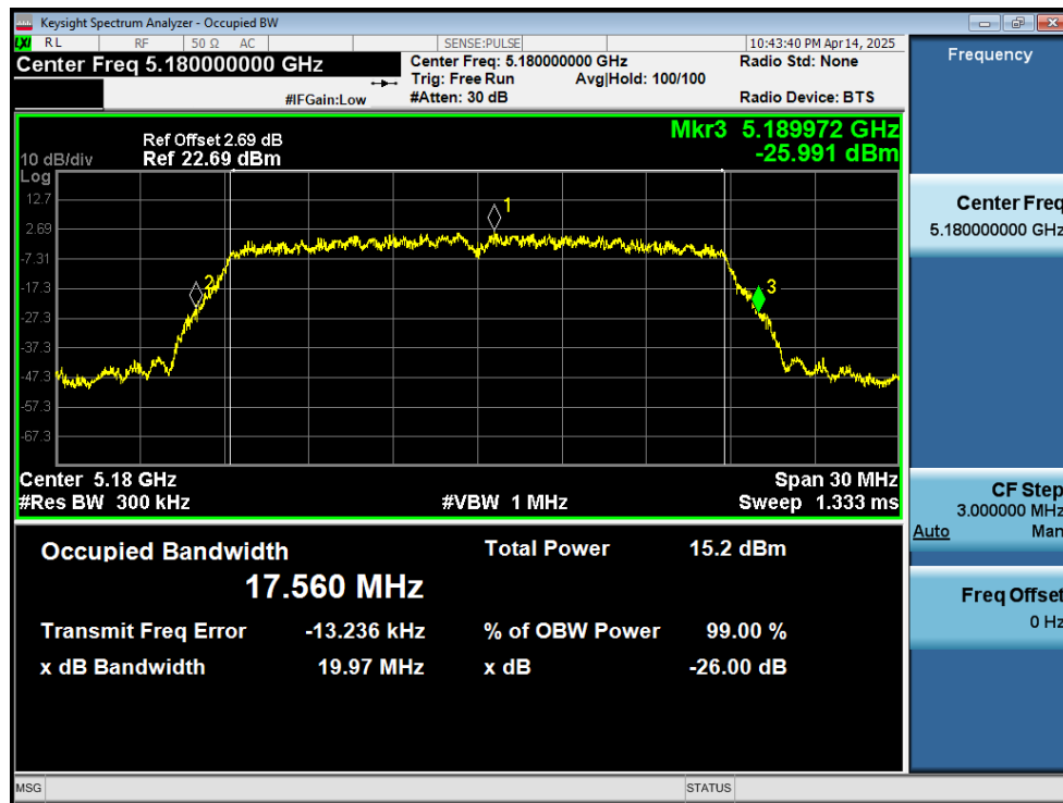
-26dB Bandwidth NVNT ac20 5180MHz Ant1
