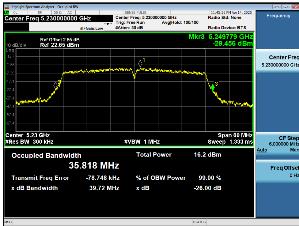
-26dB Bandwidth NVNT n40 5230MHz Ant2
