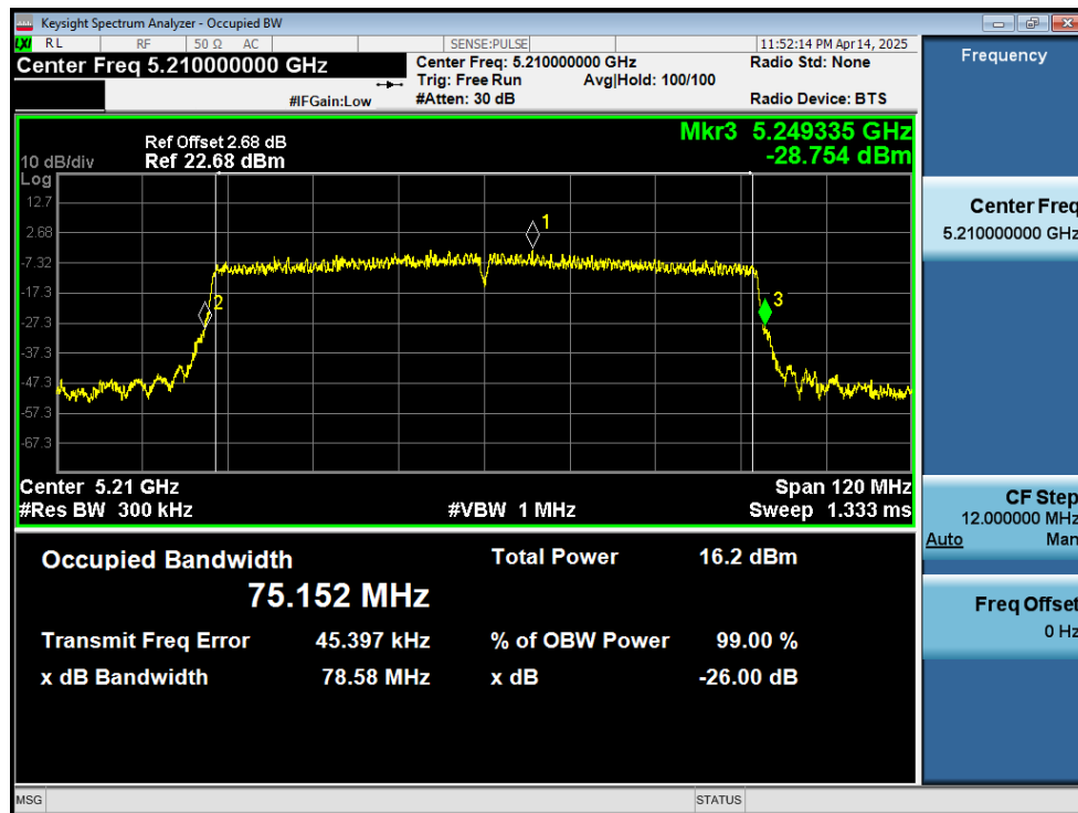
-26dB Bandwidth NVNT ac80 5210MHz Ant1
