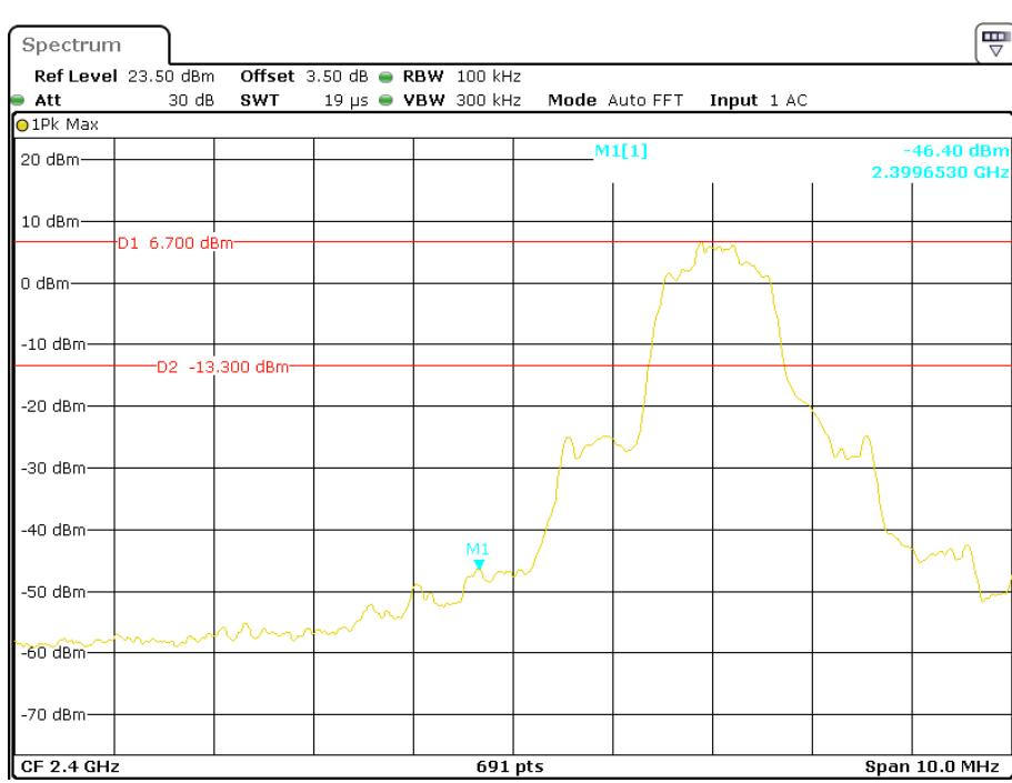
**EDR ( $\pi/4$ -DQPSK): Band Edge-Right Side Hopping**
