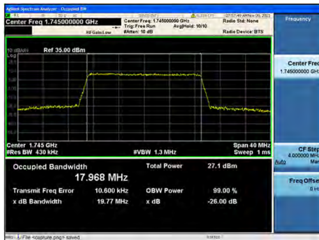
Band4 / 20MHz / High CH / QPSK
