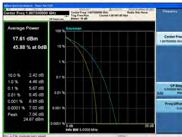
Band2 / 5MHz / High CH / QPSK
