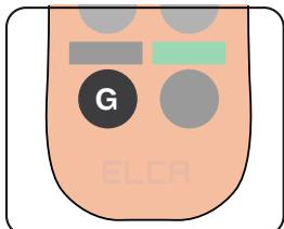
La touche G peut être configurée par le constructeur pour des fonctions particulières. La description de la manœuvre de la Machine associée à la touche G devra être fournie par le Fabricant de la Machine ou par l'Installateur.
