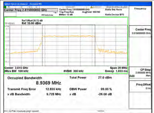
B38 / 10MHz / QPSK/ High CH
