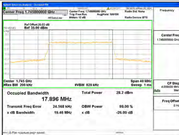
B66 / 20MHz / 64QAM/ Mid CH
