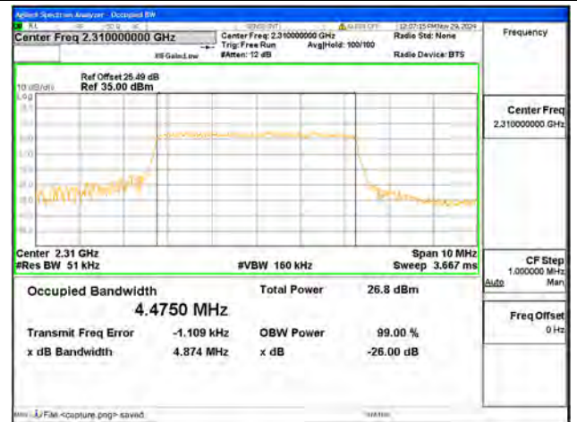
B40-1 / 5MHz / QPSK/ Mid CH
