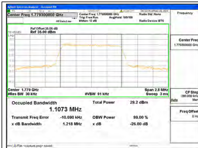
B66 / 1.4MHz / QPSK/ High CH
