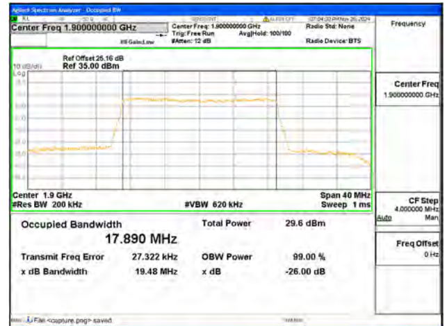
B2 / 20MHz / QPSK/ High CH
