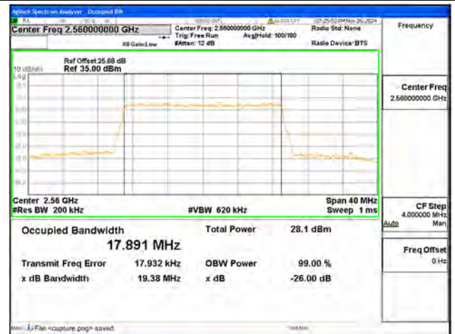
B7 / 20MHz / QPSK/ High CH
