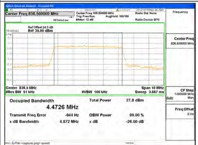
B5 / 5MHz / 64QAM/ Mid CH
