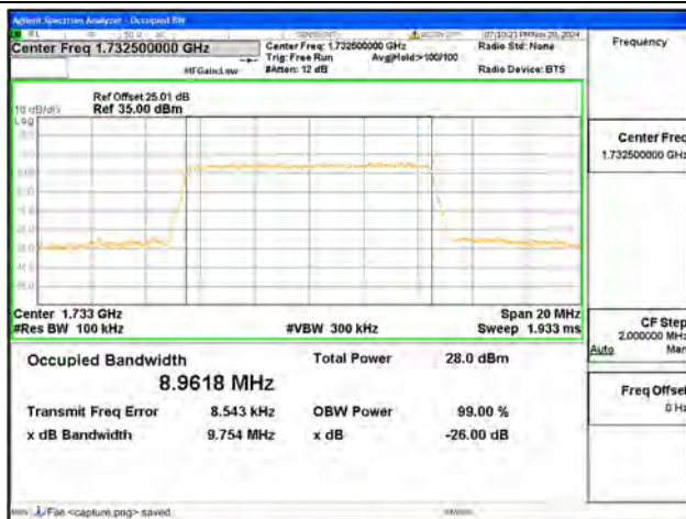
B4 / 10MHz / 64QAM/ Mid CH
