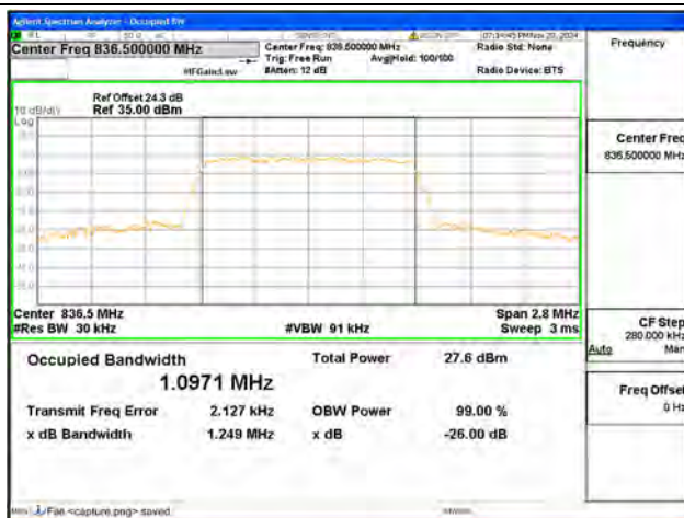
B5 / 1.4MHz / 16QAM/ Mid CH
