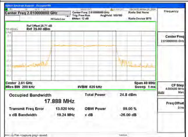
B38 / 20MHz / 64QAM/ High CH
