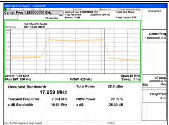
B2 / 20MHz / 16QAM/ Mid CH
