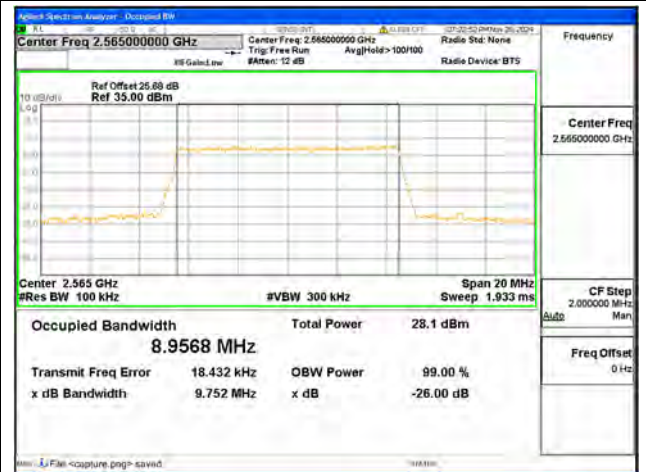
B7 / 10MHz / QPSK/ High CH
