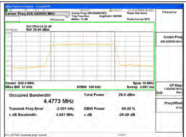
B5 / 5MHz / 16QAM/ Low CH
