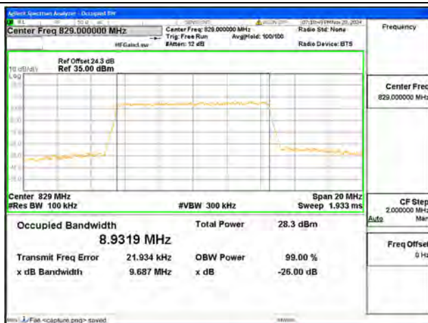
B5 / 10MHz / 16QAM/ Low CH
