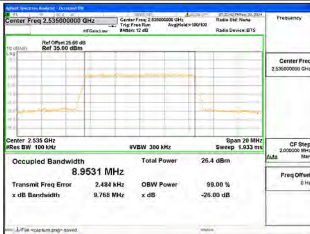
B7 / 10MHz / 64QAM/ Mid CH
