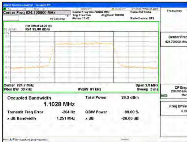
B5 / 1.4MHz / 64QAM/ Low CH
