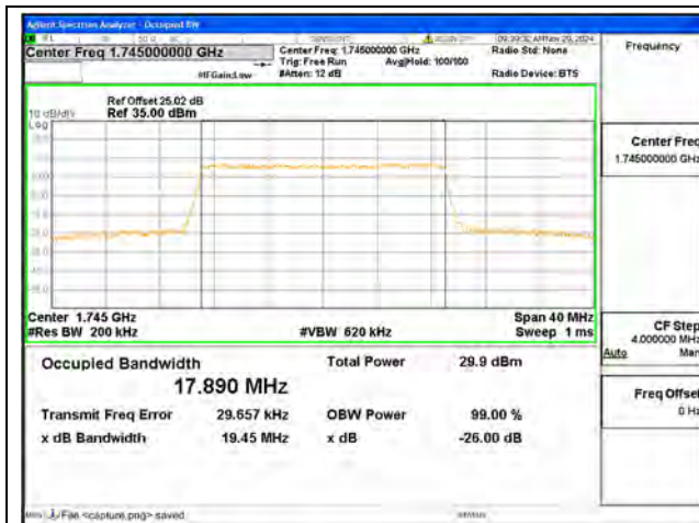
B66 / 20MHz / QPSK/ Mid CH
