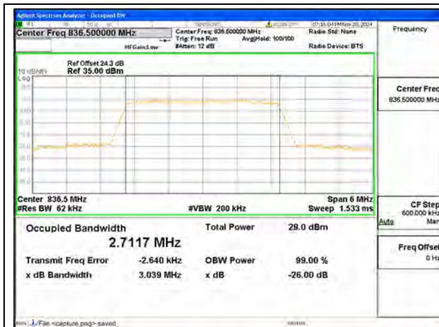
B5 / 3MHz / QPSK/ Mid CH
