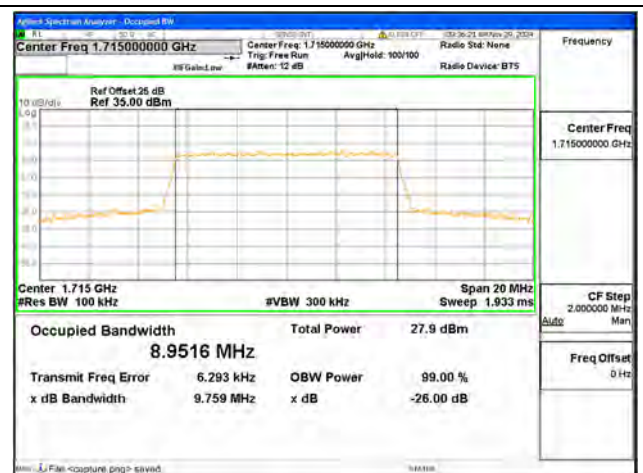
B66 / 10MHz / 64QAM/ Low CH
