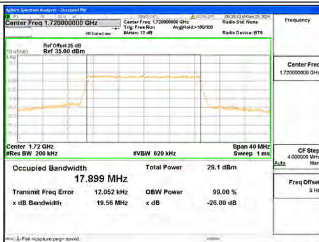
B66 / 20MHz / 16QAM/ Low CH
