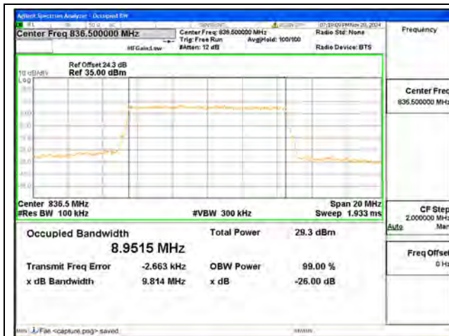
B5 / 10MHz / QPSK/ Mid CH
