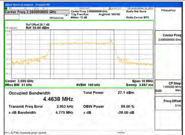
B38 / 5MHz / QPSK/ Mid CH
