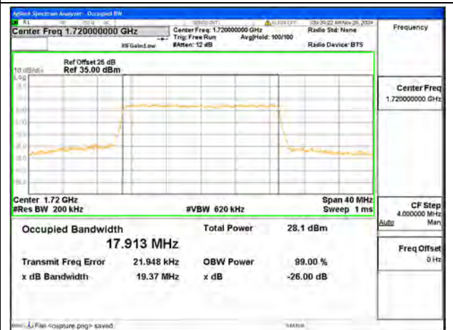
B66 / 20MHz / 64QAM/ Low CH
