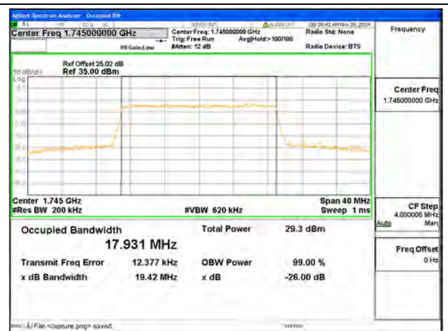
B66 / 20MHz / 16QAM/ Mid CH
