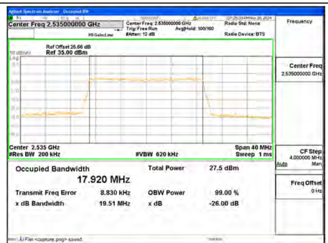
B7 / 20MHz / 16QAM/ Mid CH
