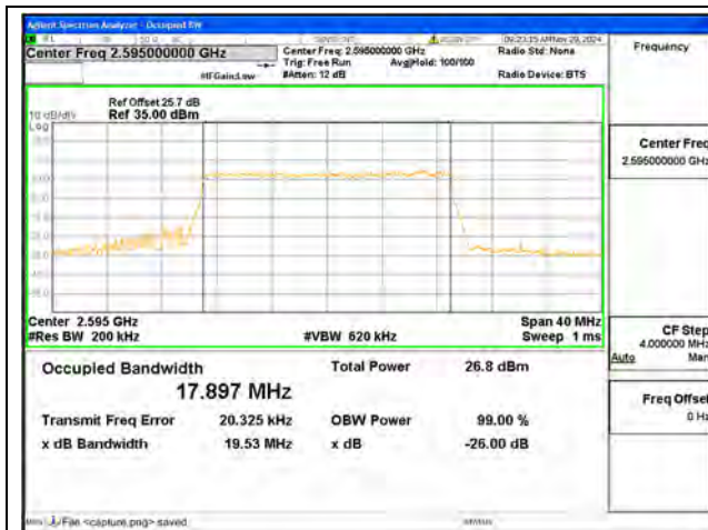
B38 / 20MHz / QPSK/ Mid CH
