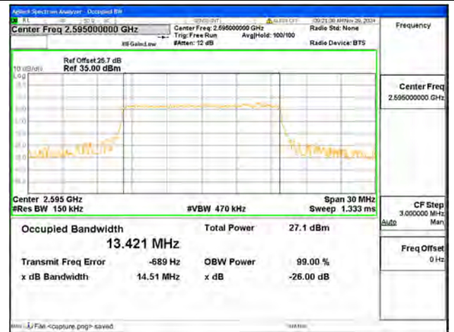
B38 / 15MHz / QPSK/ Mid CH
