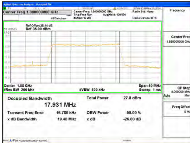
B2 / 20MHz / 64QAM/ Mid CH
