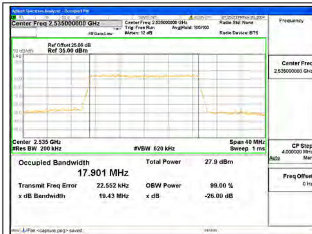
B7 / 20MHz / QPSK/ Mid CH
