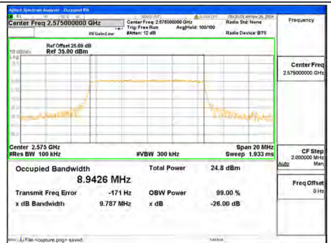
B38 / 10MHz / 64QAM/ Low CH
