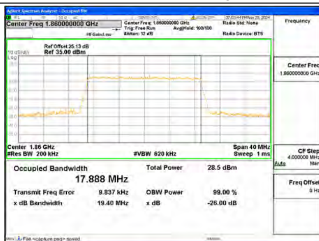
B2 / 20MHz / 16QAM/ Low CH
