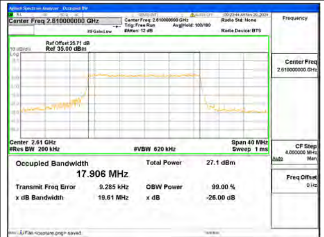
B38 / 20MHz / QPSK/ High CH
