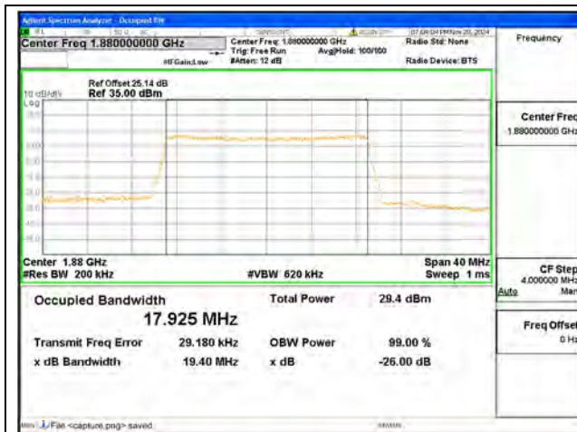
B2 / 20MHz / QPSK/ Mid CH
