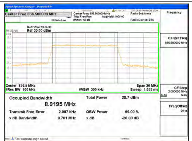
B5 / 10MHz / 16QAM/ Mid CH
