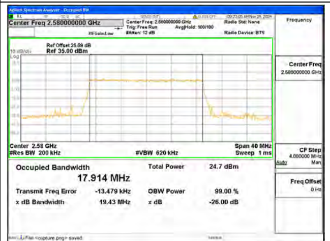
B38 / 20MHz / 64QAM/ Low CH
