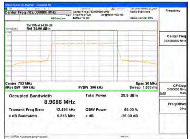
B13 / 10MHz / QPSK/ Mid CH
