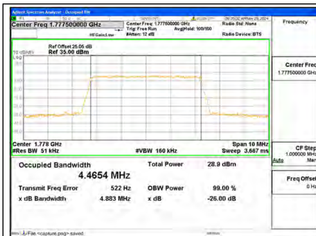
B66 / 5MHz / QPSK/ High CH
