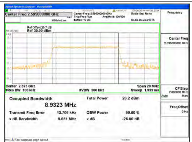
B38 / 10MHz / 16QAM/ Mid CH
