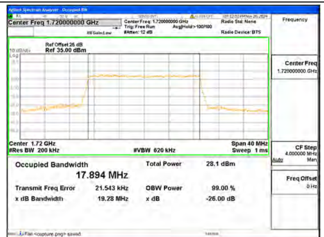
B4 / 20MHz / 64QAM/ Low CH
