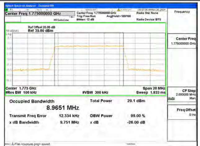
B66 / 10MHz / QPSK/ High CH
