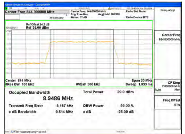
B5 / 10MHz / QPSK/ High CH
