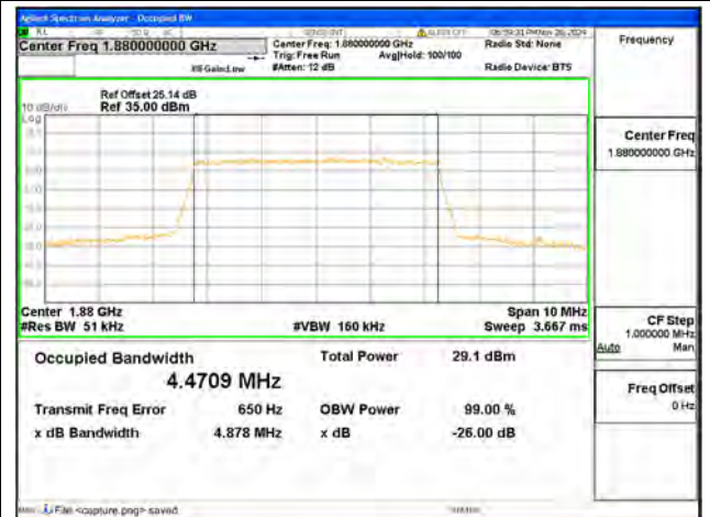
B2 / 5MHz / QPSK/ Mid CH
