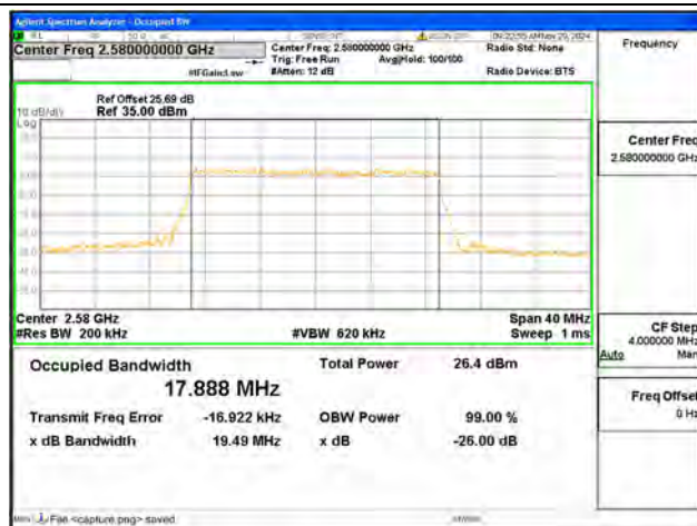
B38 / 20MHz / 16QAM/ Low CH
