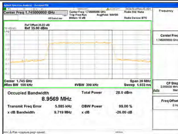
B66 / 10MHz / 64QAM/ Mid CH
