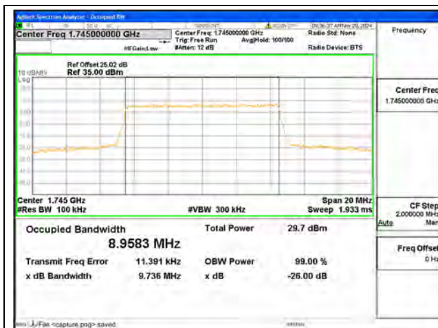
B66 / 10MHz / QPSK/ Mid CH
