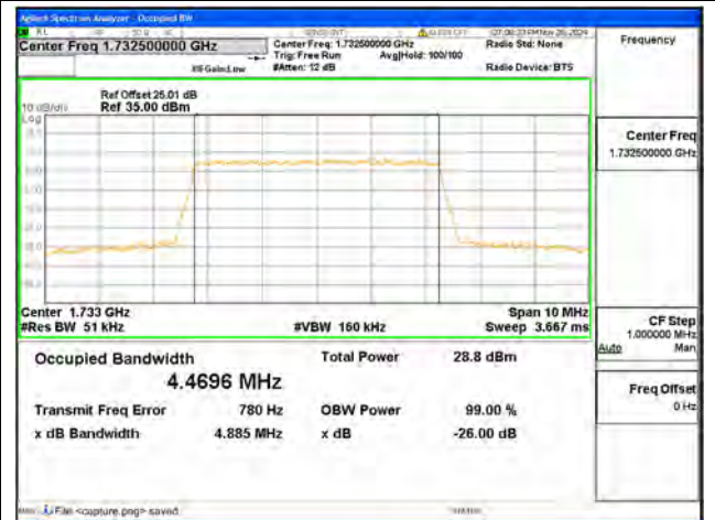
B4 / 5MHz / QPSK/ Mid CH
