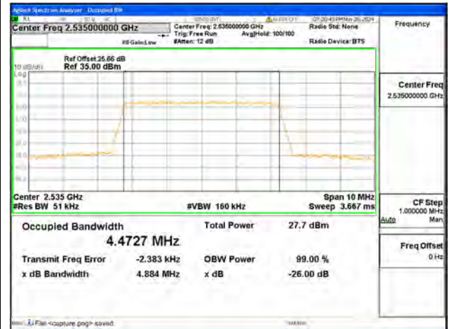
B7 / 5MHz / QPSK/ Mid CH
