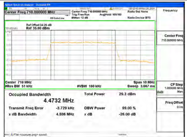
B17 / 5MHz / QPSK/ Mid CH
