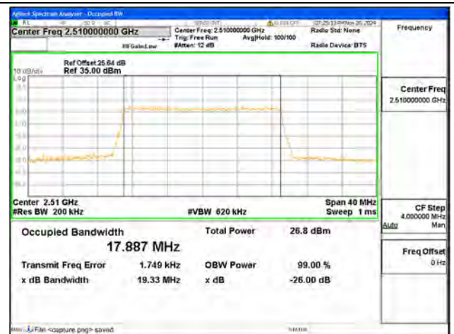
B7 / 20MHz / 64QAM/ Low CH
