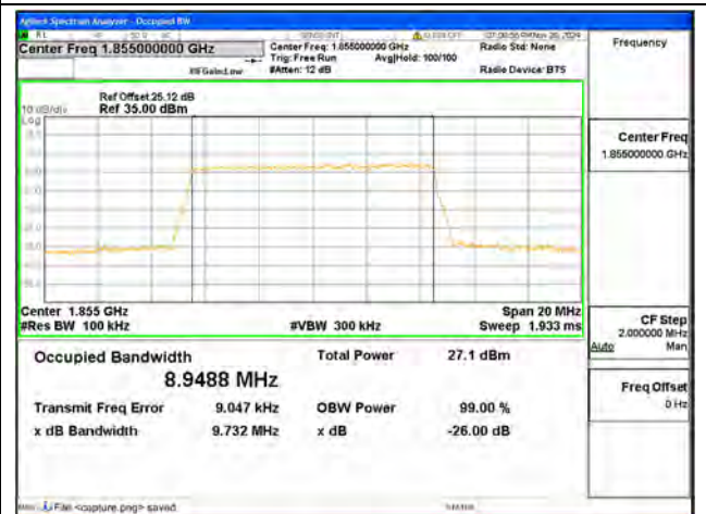
B2 / 10MHz / 64QAM/ Low CH
