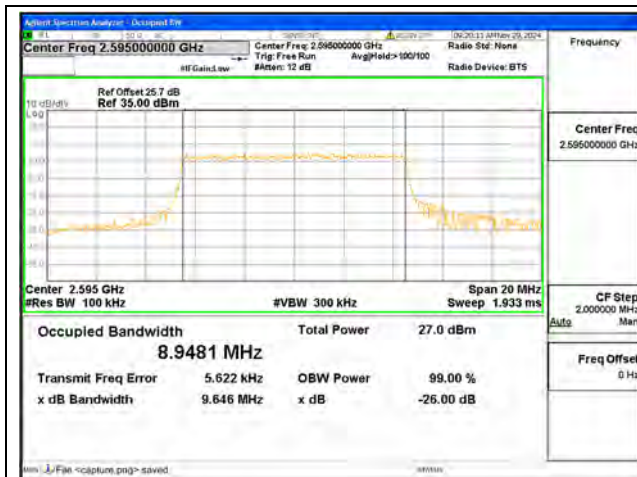
B38 / 10MHz / QPSK/ Mid CH
