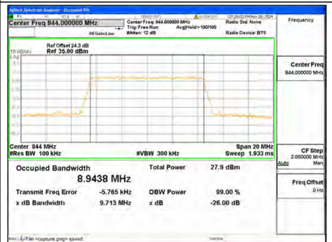
B5 / 10MHz / 64QAM/ High CH
