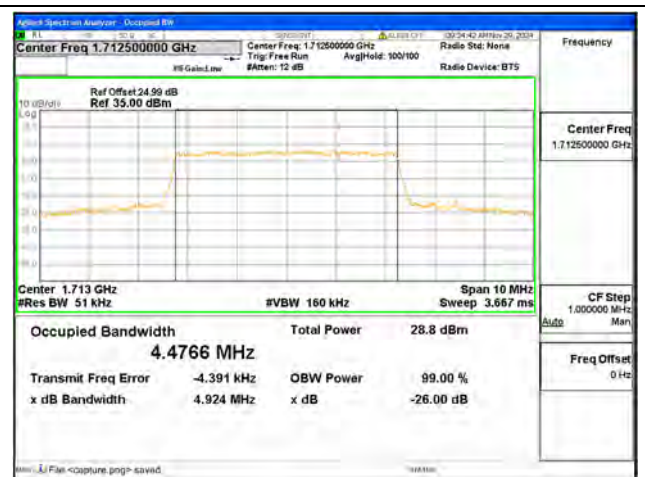
B66 / 5MHz / 16QAM/ Low CH
