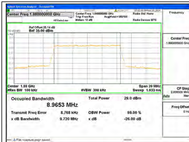
B2 / 10MHz / QPSK/ Mid CH
