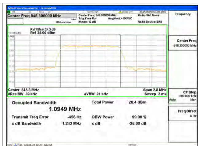
B5 / 1.4MHz / QPSK/ High CH
