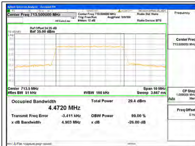
B17 / 5MHz / QPSK/ High CH
