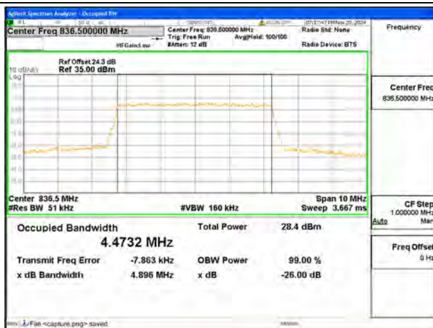
B5 / 5MHz / 16QAM/ Mid CH
