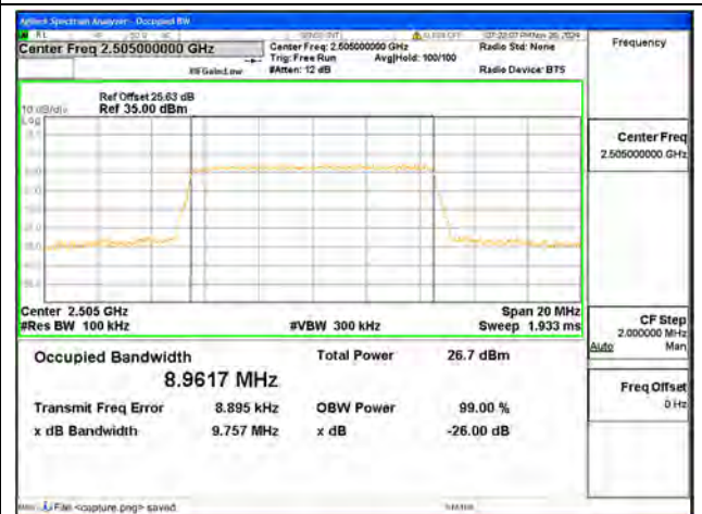
B7 / 10MHz / 64QAM/ Low CH
