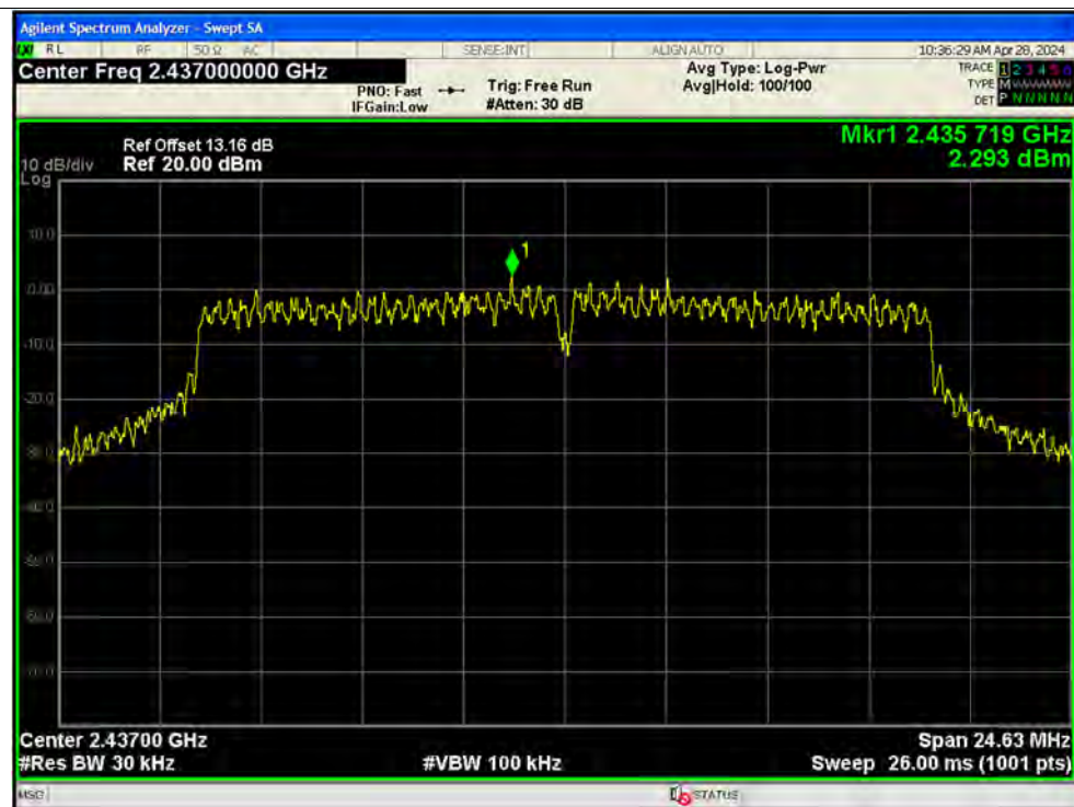
PSD NVNT ac20 2437MHz Ant1
