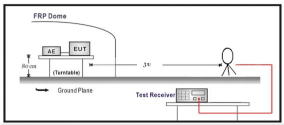
30MHz-1GHz Test Setup:
