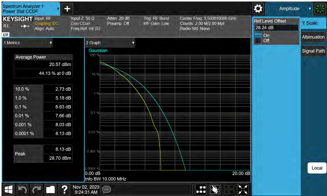
Sub6 n77(78). PAR Plot (10 M BW_Ch.633334_64QAM)
