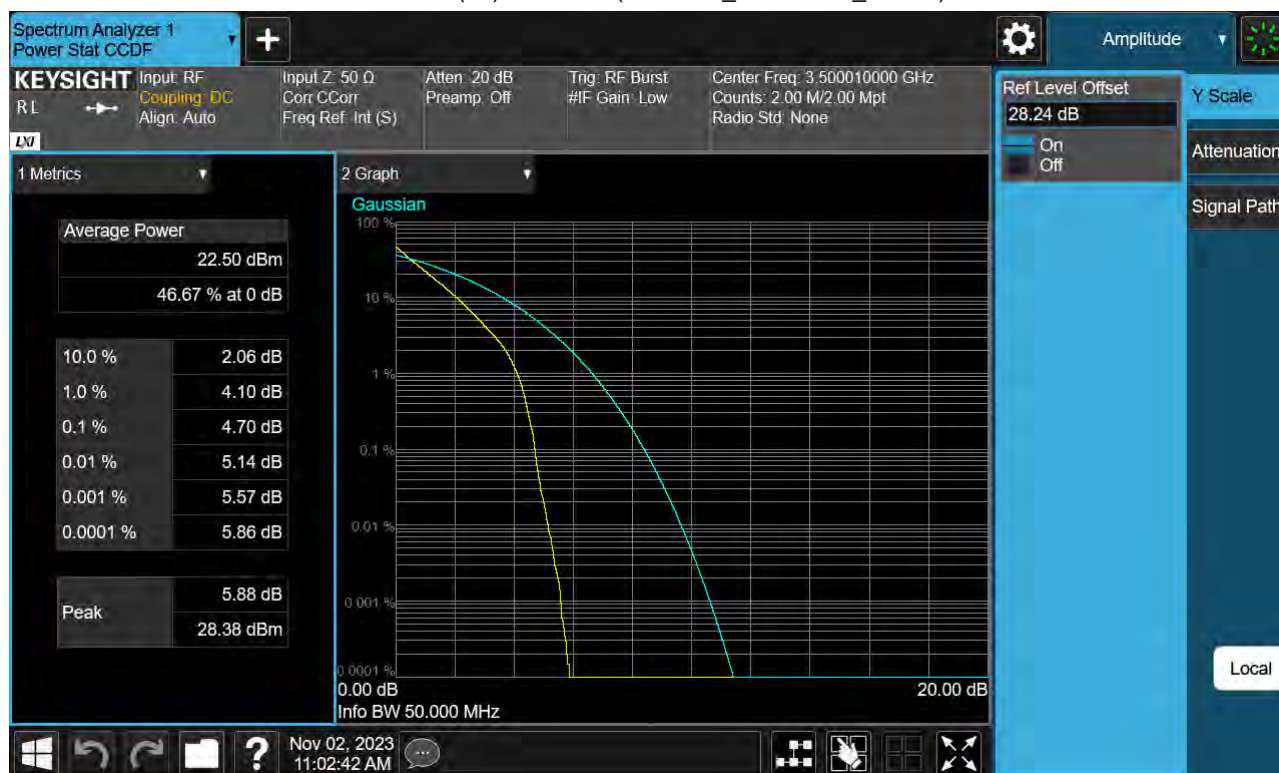
Sub6 n77(78). PAR Plot (50 M BW_Ch.633334_ BPSK)
