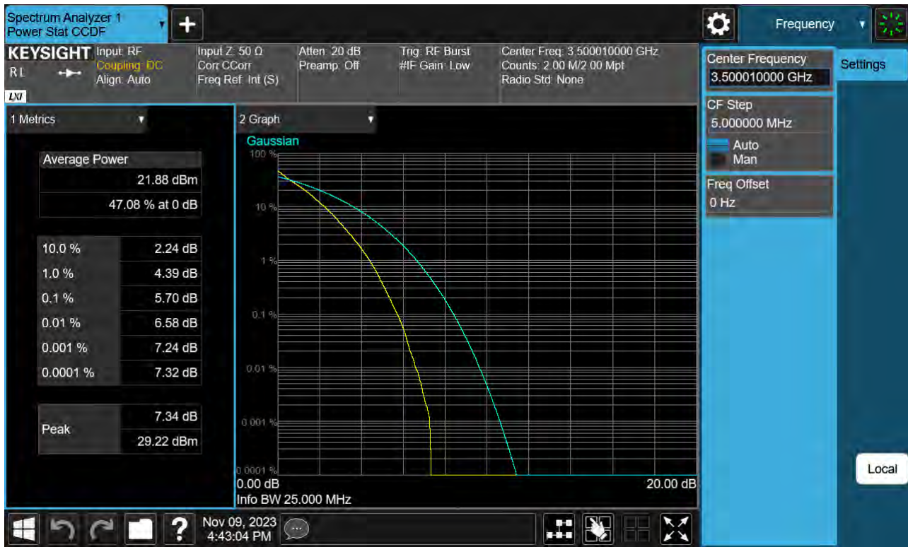
Sub6 n77(78). PAR Plot (25 M BW_Ch.633334_QPSK)
