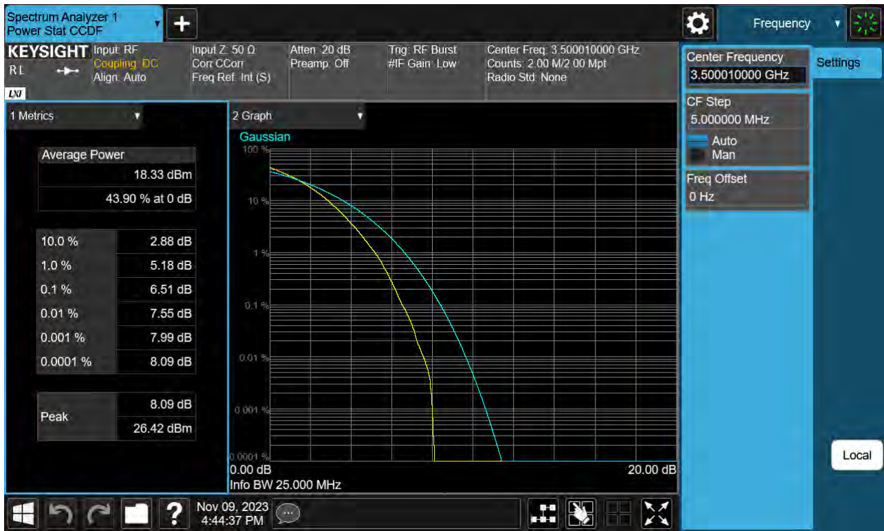
Sub6 n77(78). PAR Plot (25 M BW_Ch.633334_256QAM)
