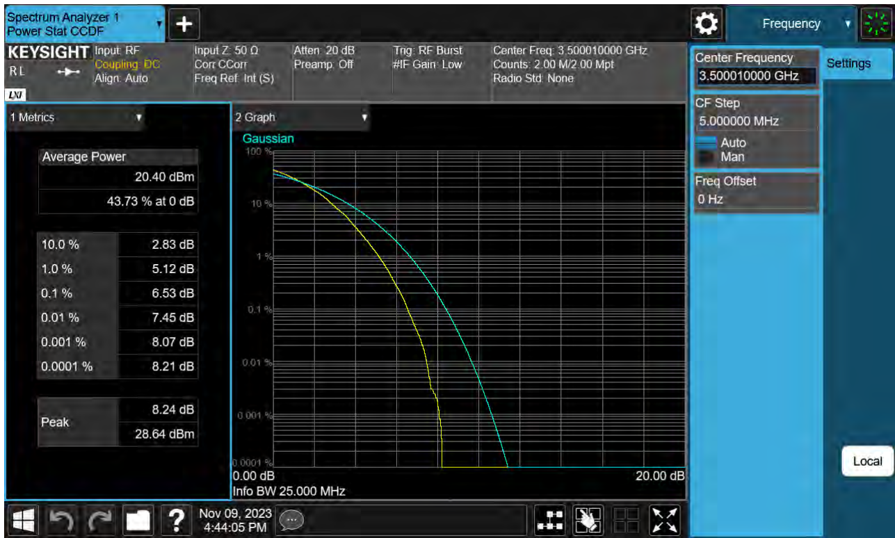
Sub6 n77(78). PAR Plot (25 M BW_Ch.633334_64QAM)
