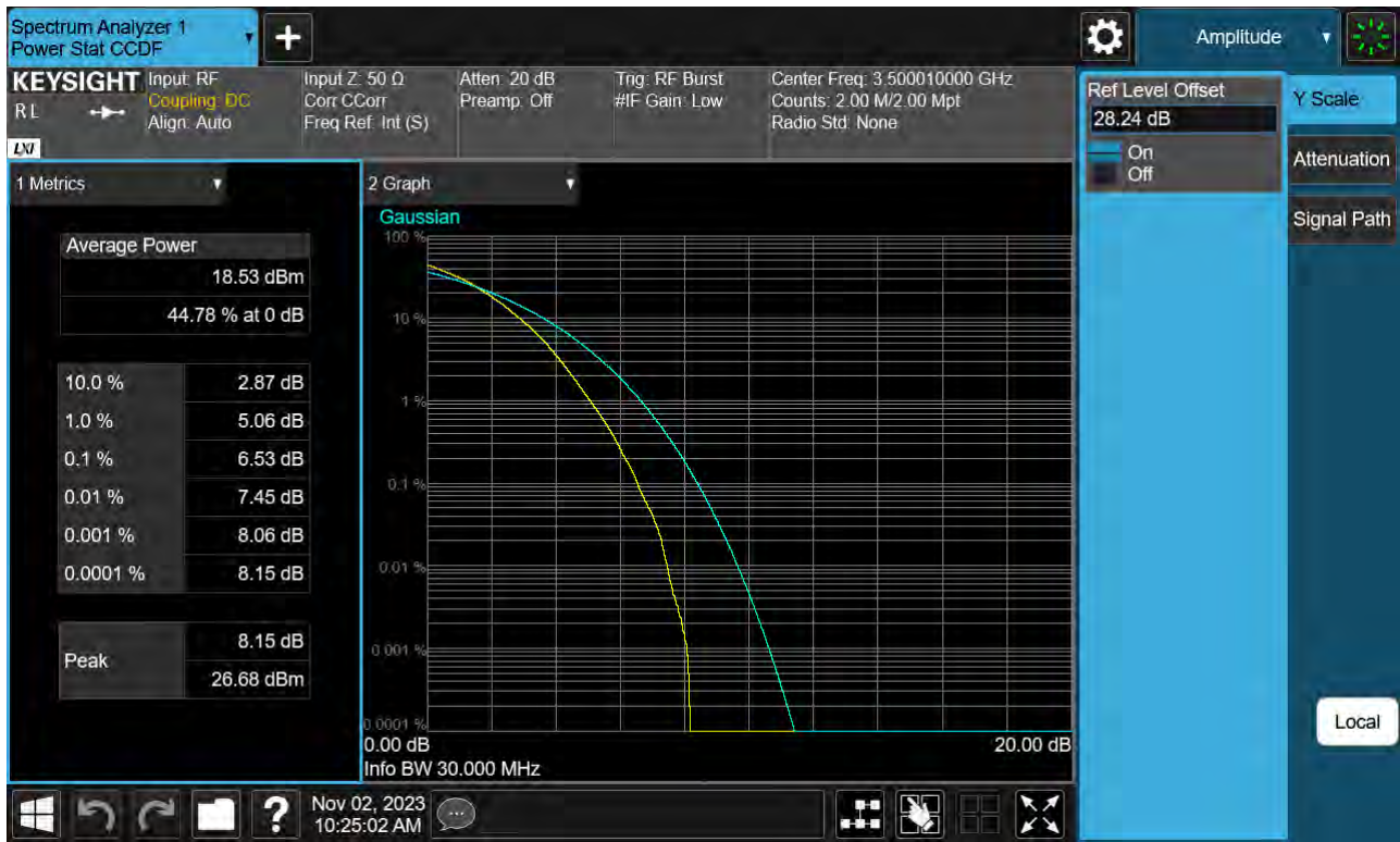
Sub6 n77(78). PAR Plot (30 M BW_Ch.633334_256QAM)
