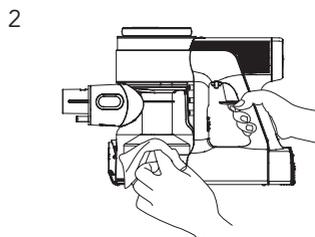
Le nettoyer avec un chiffon humide, en prenant soin d'éviter que l'eau pénètre dans le corps principal de l'appareil et dans la batterie.
