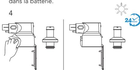
Nettoyer le réceptacle et le filtre à mailles avec un chiffon humide. Assécher complètement à l'air avant de les réinstaller.
