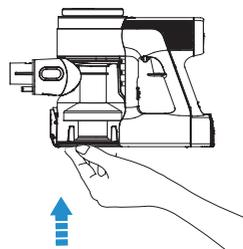
Fermer et remettre le volet du réceptacle en place en cliquant dessus.
