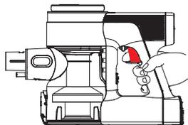
Le paramètre par défaut au démarrage est AUTO. L'appareil met ensuite 3 secondes pour détecter les obstructions ou la poussière. Si aucune poussière n'est détectée, la puissance est réduite pour économiser l'énergie.
