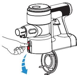
Lorsque le travail est terminé, appuyer sur le bouton de vidange situé sur le côté du réceptacle pour en vider le contenu.
