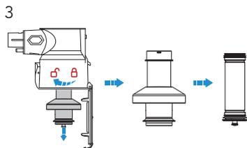
Tourner dans le sens inverse des aiguilles d'une montre pour retirer les filtres.
