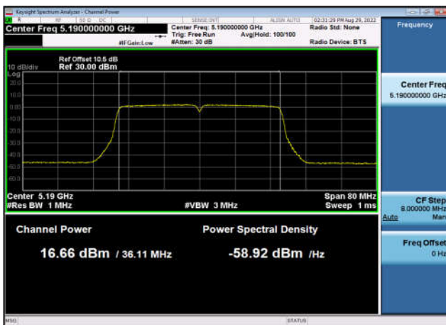
U-NII-1 Output Power-802.11ac(40MHz) ,5190MHz,Ant0
