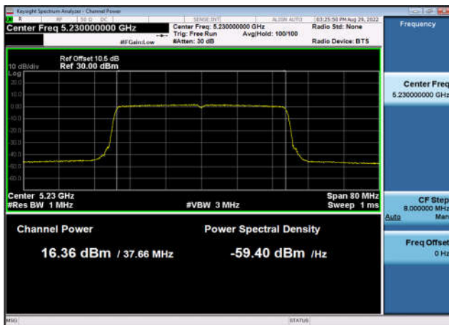
U-NII-1 Output Power-802.11ax(80MHz) ,5210MHz,Ant0
