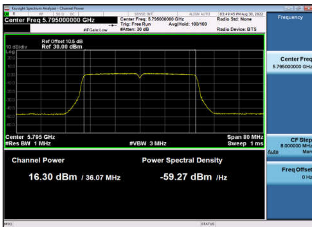
U-NII-3 Output Power-802.11ac(40MHz) ,5795MHz,Ant0
