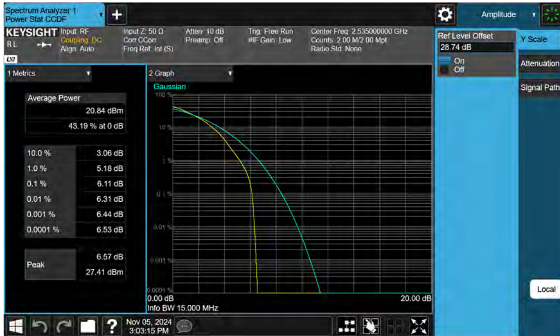
Sub6 n7. PAR Plot (15 M BW_Ch.507000_64QAM)
