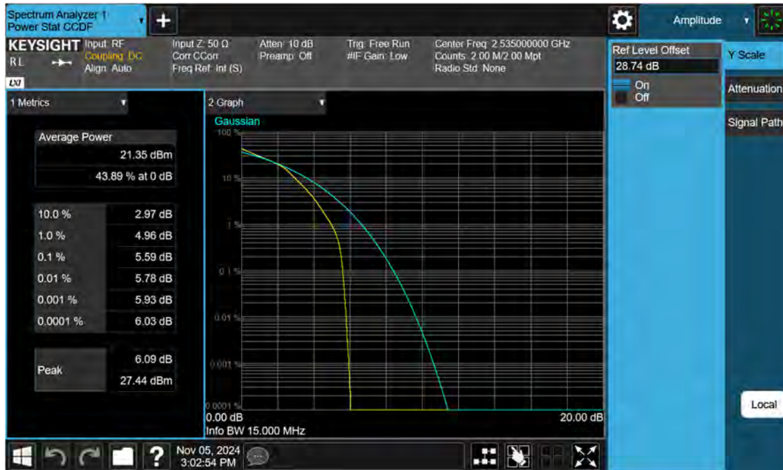
Sub6 n7. PAR Plot (15 M BW_Ch.507000_16QAM)
