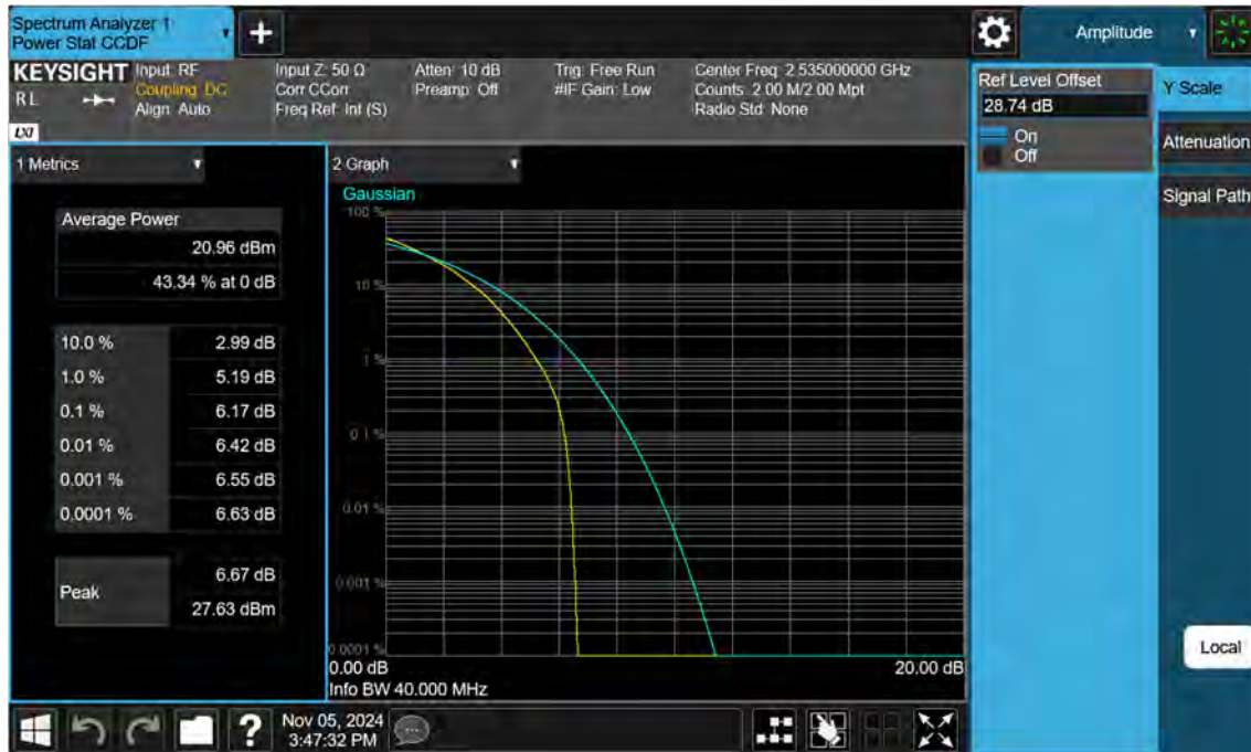
Sub6 n7. PAR Plot (40 M BW_Ch.507000_64QAM)
