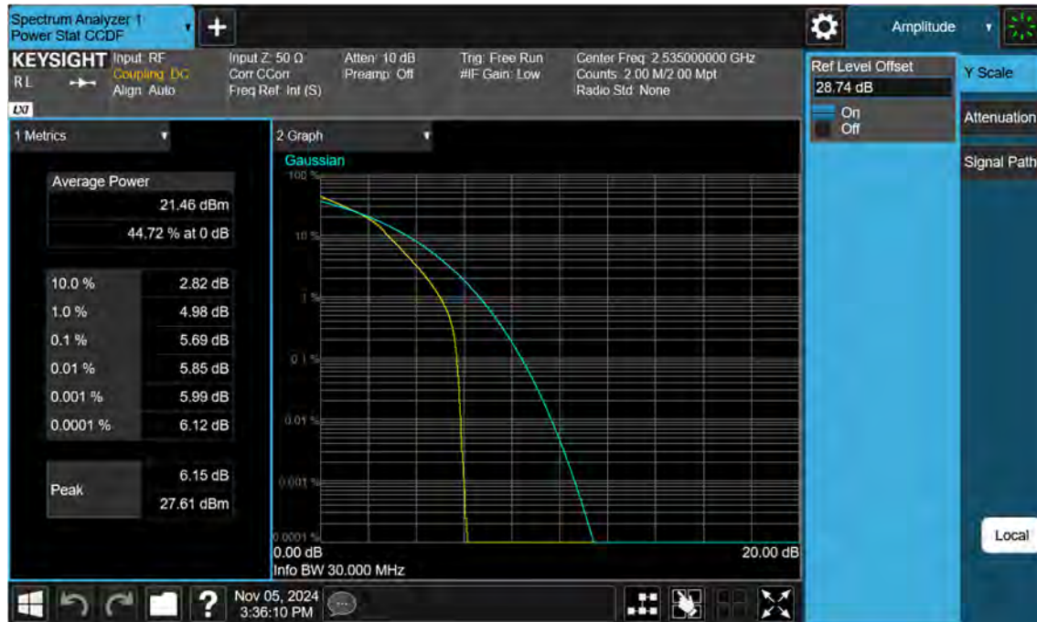
Sub6 n7. PAR Plot (30 M BW_Ch.507000_16QAM)
