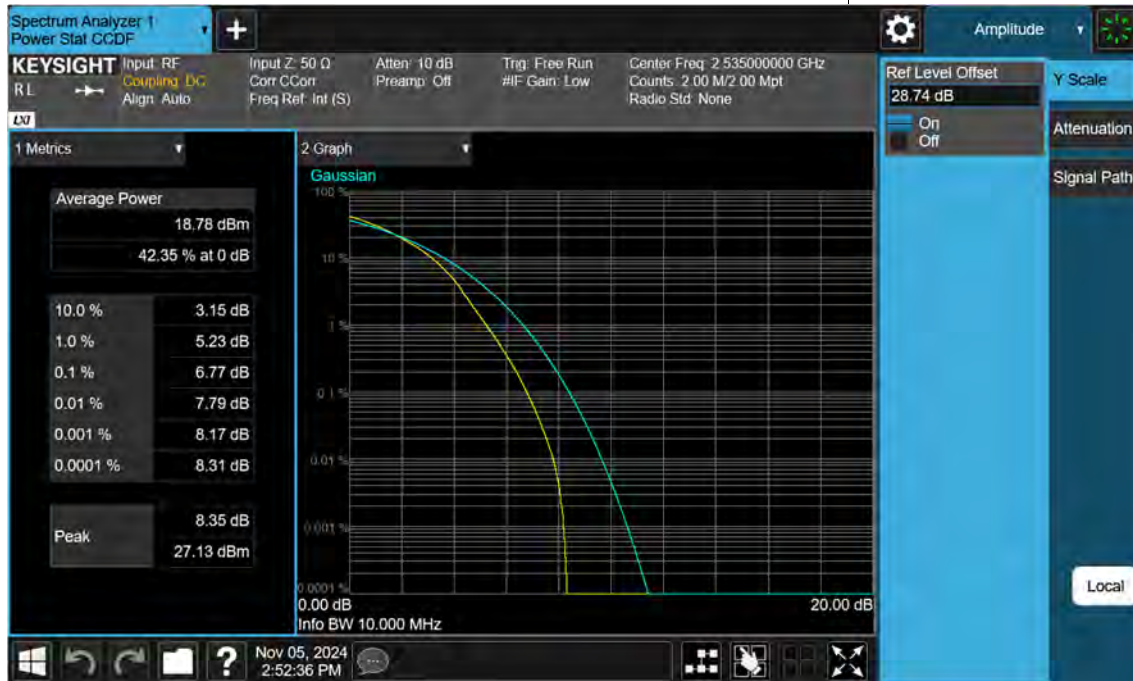
Sub6 n7. PAR Plot (10 M BW_Ch.507000_256QAM)
