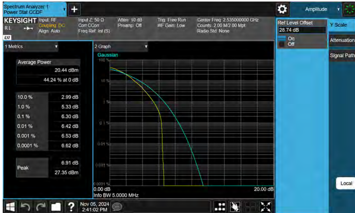
Sub6 n7. PAR Plot (5 M BW_Ch.507000_64QAM)
