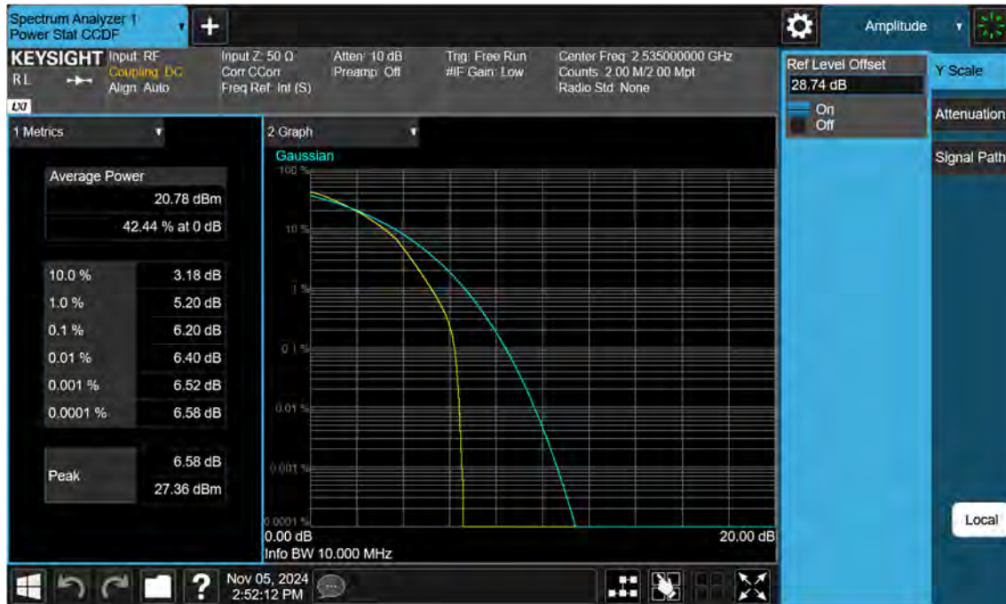
Sub6 n7. PAR Plot (10 M BW_Ch.507000_64QAM)
