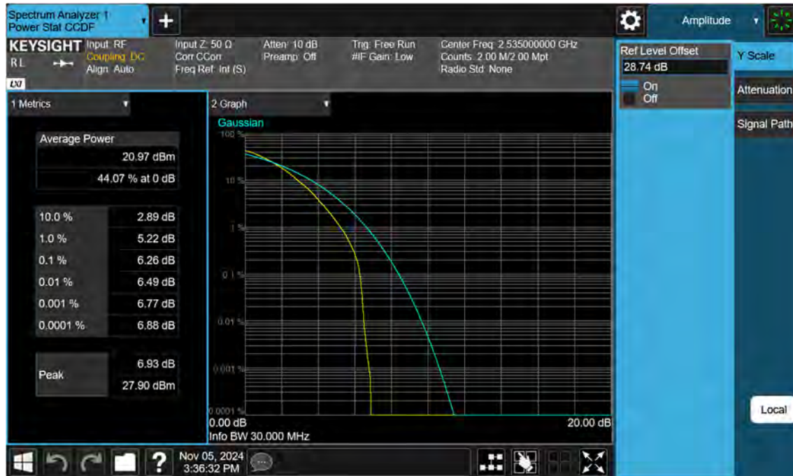
Sub6 n7. PAR Plot (30 M BW_Ch.507000_64QAM)
