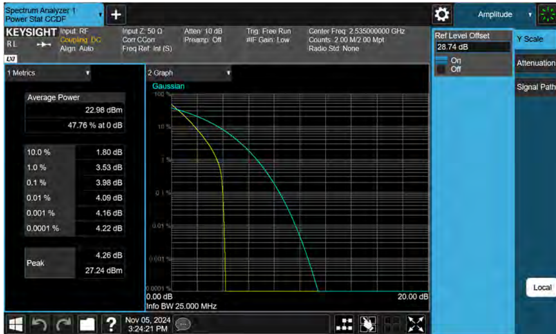
Sub6 n7. PAR Plot (25 M BW_Ch.507000_ BPSK)
