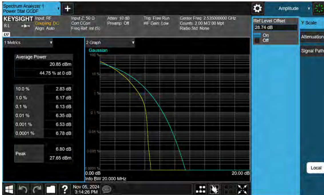
Sub6 n7. PAR Plot (20 M BW_Ch.507000_64QAM)
