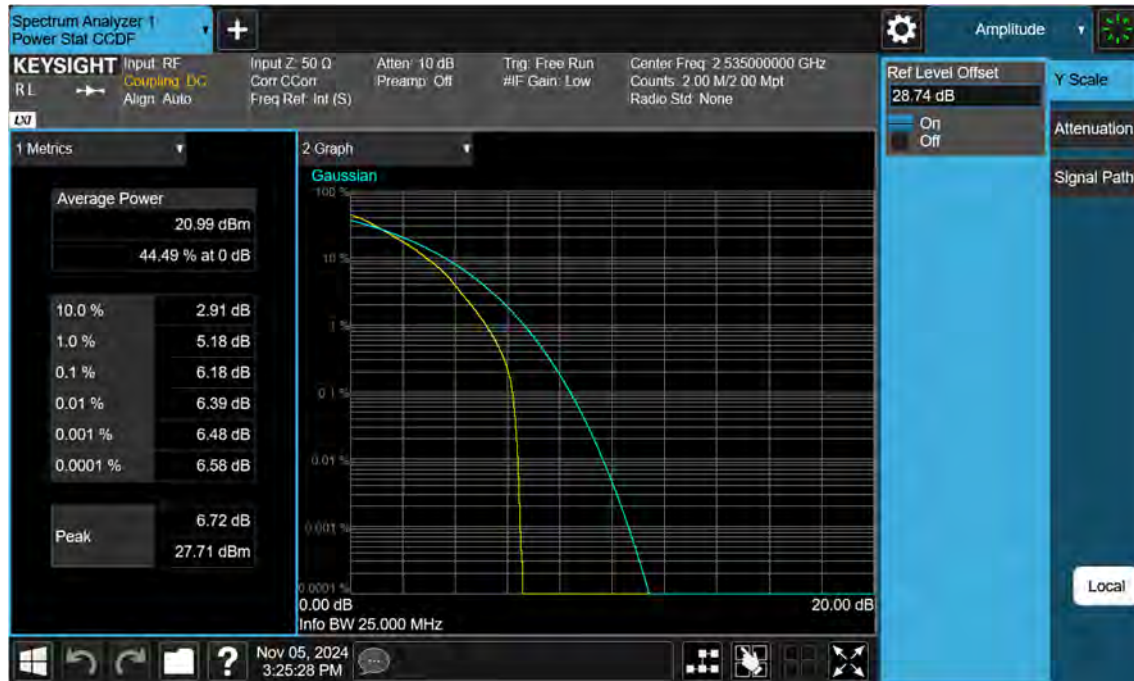
Sub6 n7. PAR Plot (25 M BW_Ch.507000_64QAM)
