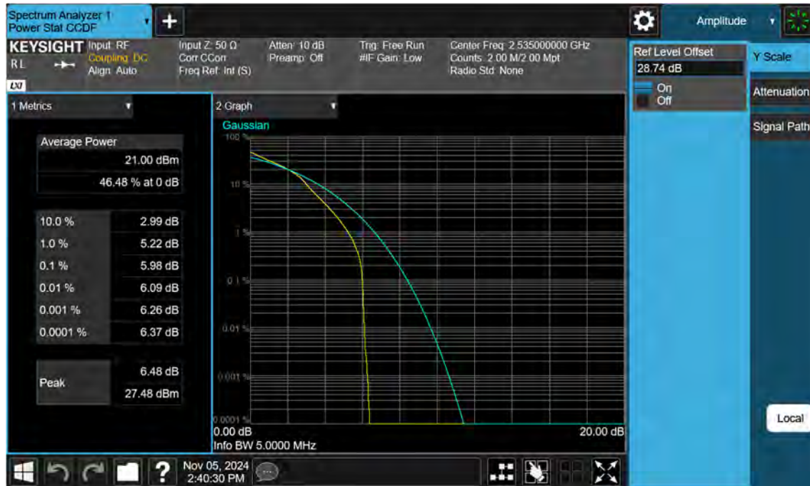
Sub6 n7. PAR Plot (5 M BW_Ch.507000_16QAM)
