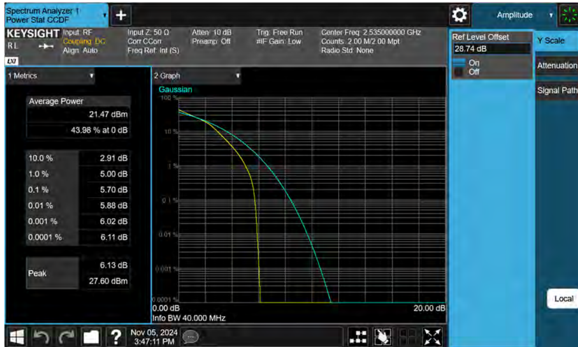
Sub6 n7. PAR Plot (40 M BW_Ch.507000_16QAM)
