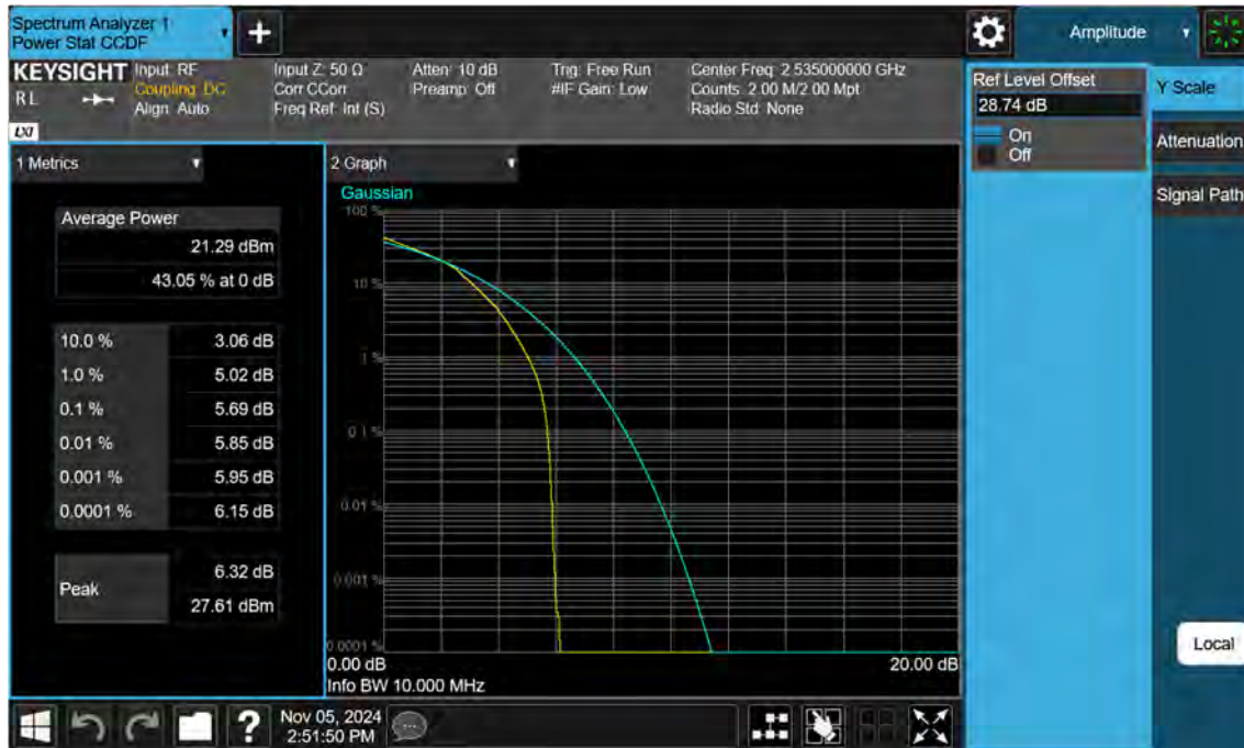
Sub6 n7. PAR Plot (10 M BW_Ch.507000_16QAM)
