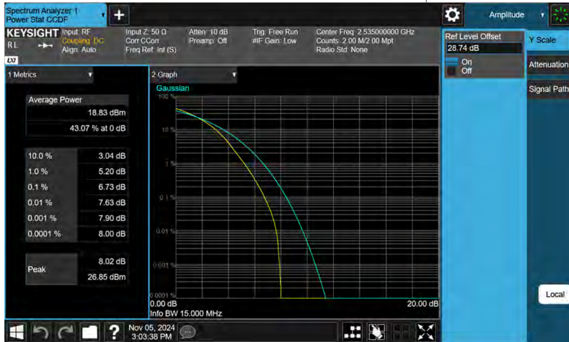
Sub6 n7. PAR Plot (15 M BW_Ch.507000_256QAM)
