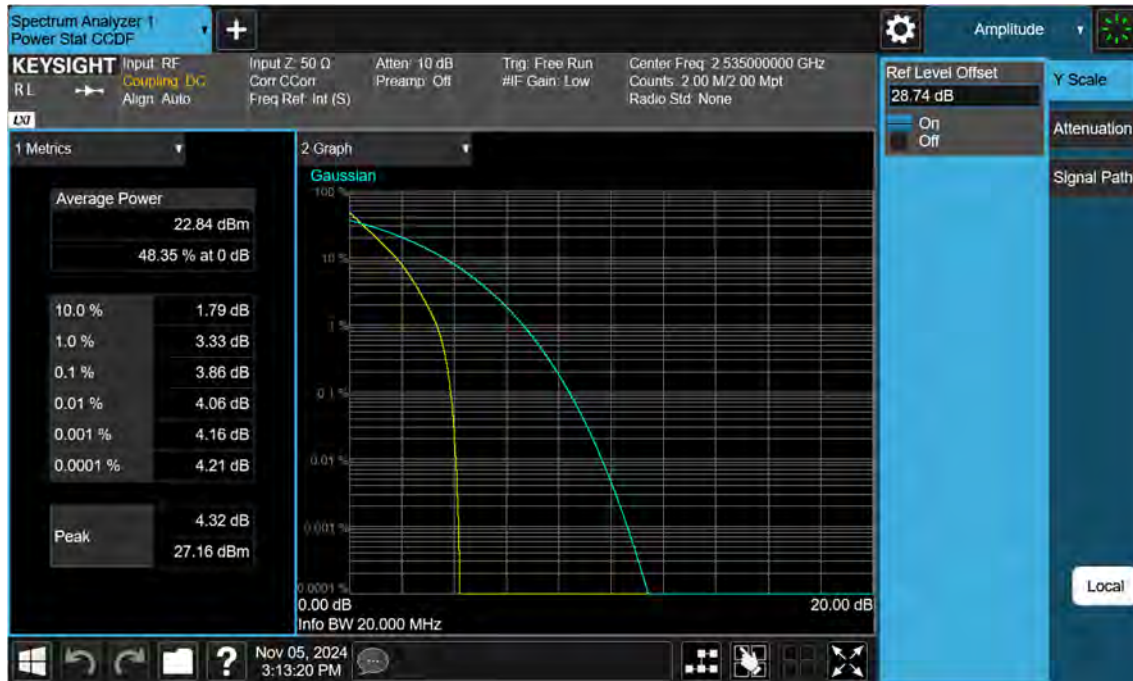
Sub6 n7. PAR Plot (20 M BW_Ch.507000_ BPSK)
