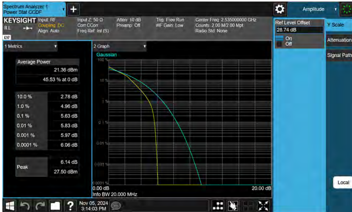
Sub6 n7. PAR Plot (20 M BW_Ch.507000_16QAM)
