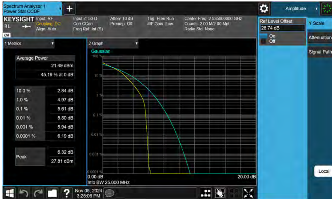
Sub6 n7. PAR Plot (25 M BW_Ch.507000_16QAM)
