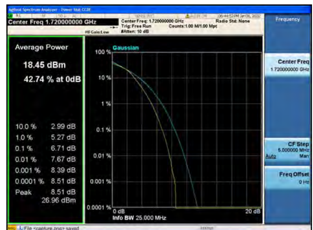
Band4 / 20MHz / Low CH / 64QAM
