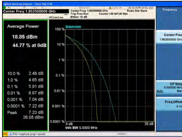
Band2 / 5MHz / Low CH / 64QAM
