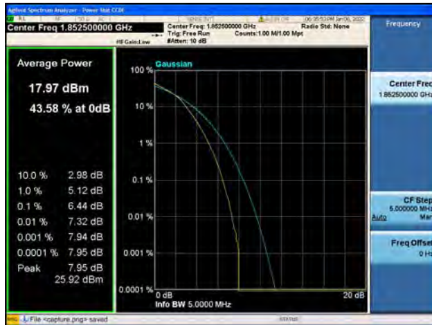
Band2 / 5MHz / Mid CH / 16QAM
