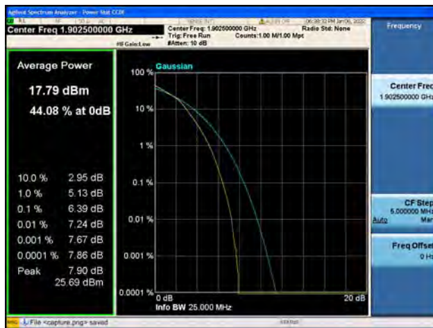
Band2 / 20MHz / Low CH / 16QAM
