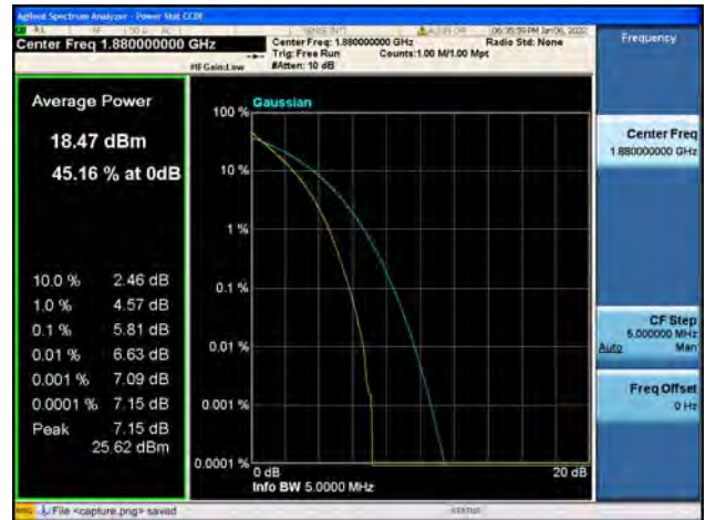
Band2 / 5MHz / Mid CH / 64QAM
