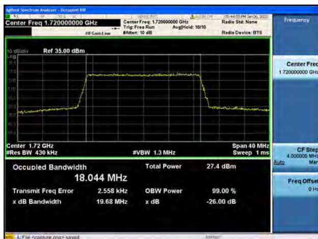
Band66 / 20MHz / Low CH / 16QAM
