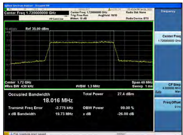
Band66 / 20MHz / Low CH / 64QAM
