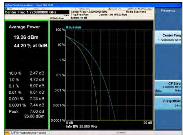
Band4 / 20MHz / Low CH / 64QAM
