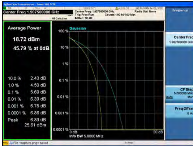
Band2 / 5MHz / High CH / 64QAM
