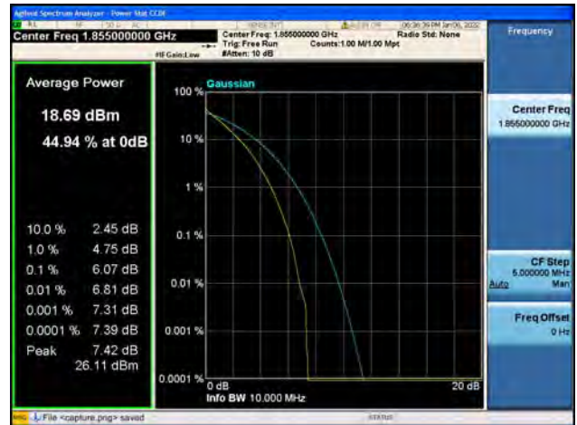
Band2 / 10MHz / Low CH / 64QAM
