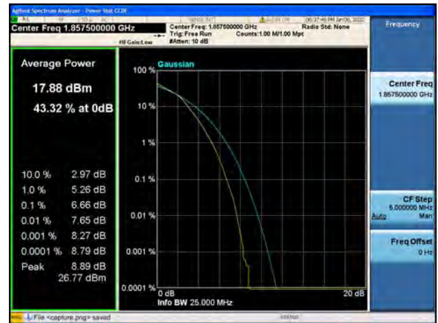
Band2 / 15MHz / Mid CH / QPSK
