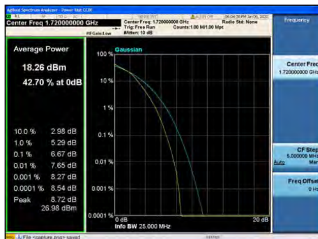
Band66 / 20MHz / Low CH / 16QAM
