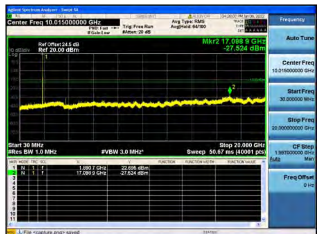
Band2 / 20MHz / High CH / 64QAM
