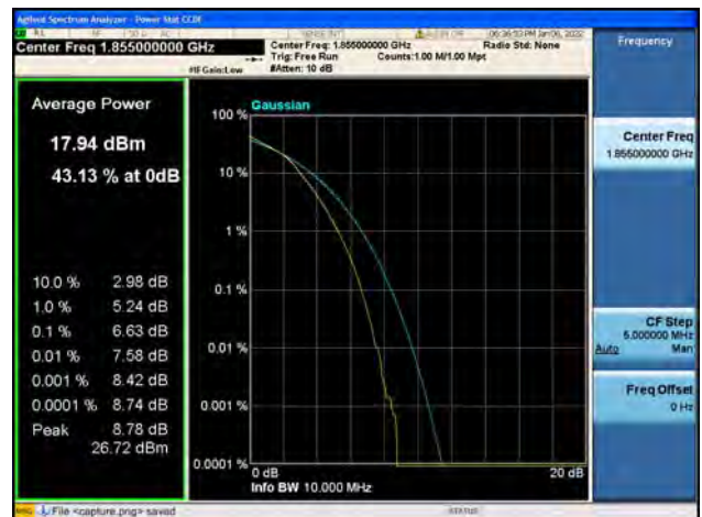
Band2 / 10MHz / Low CH / 64QAM
