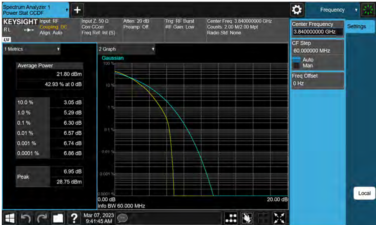
Sub6 n77(78). PAR Plot (60 M BW_Ch.656000_64QAM)
