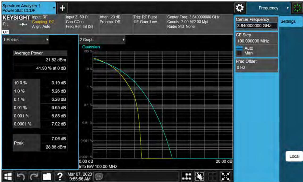
Sub6 n77(78). PAR Plot (100 M BW_Ch.656000_64QAM)
