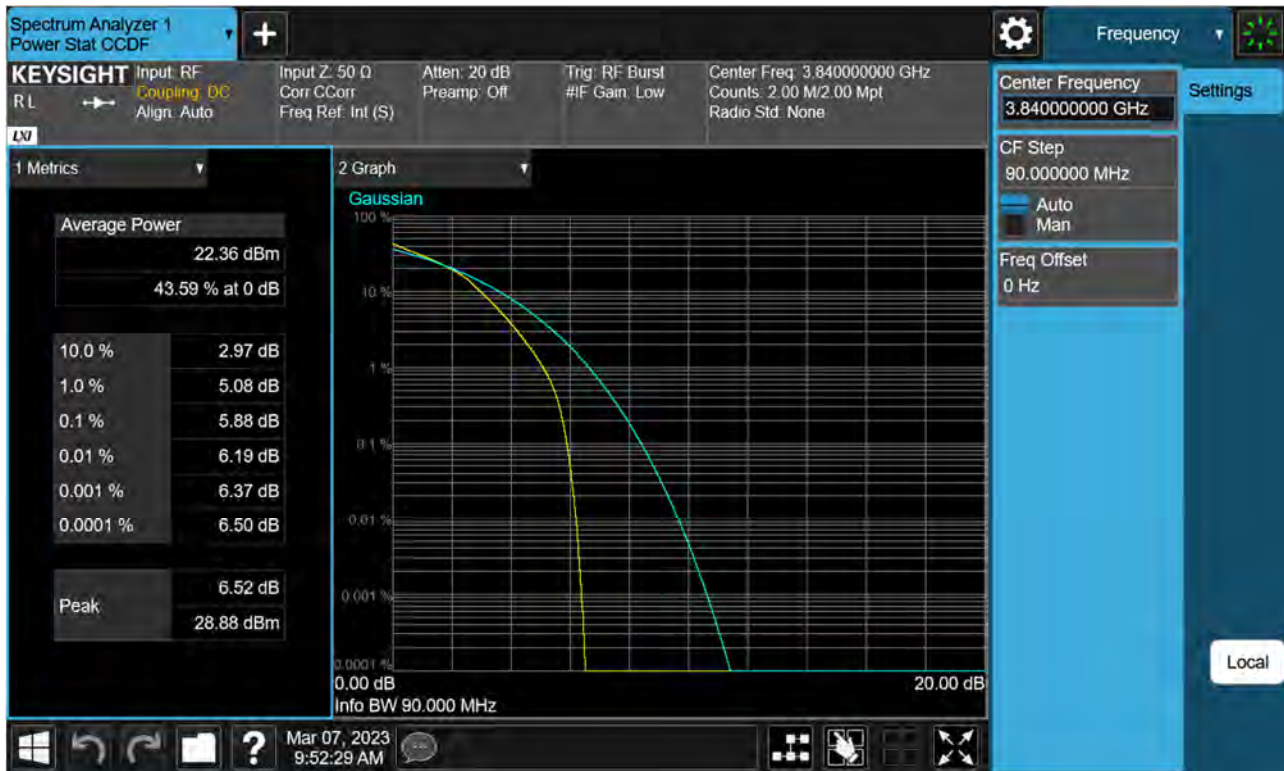
Sub6 n77(78). PAR Plot (90 M BW_Ch.656000_16QAM)
