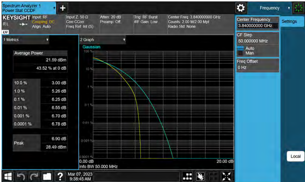
Sub6 n77(78). PAR Plot (50 M BW_Ch.656000_64QAM)
