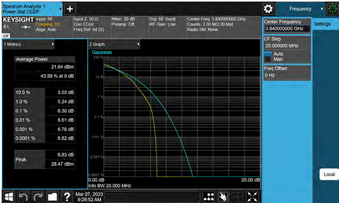
Sub6 n77(78). PAR Plot (20 M BW_Ch.656000_64QAM)
