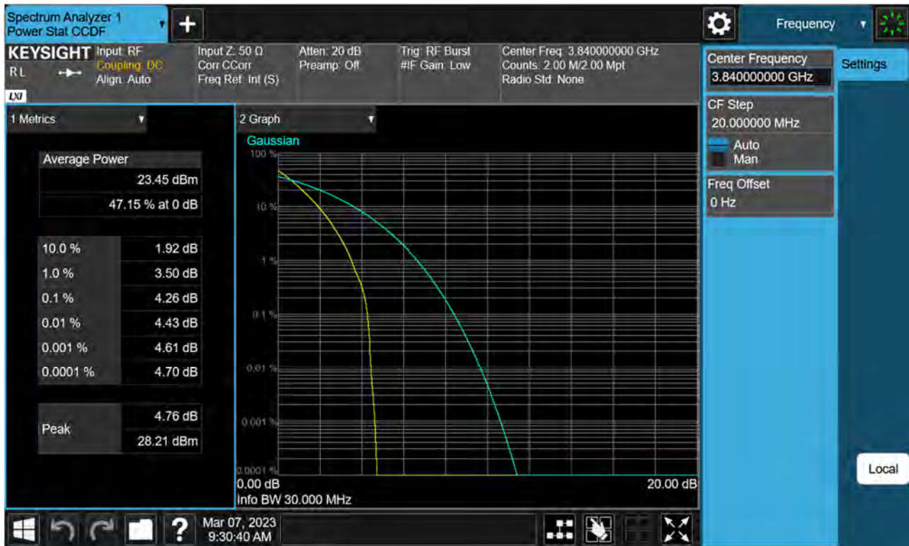
Sub6 n77(78). PAR Plot (30 M BW_Ch.656000_ BPSK)
