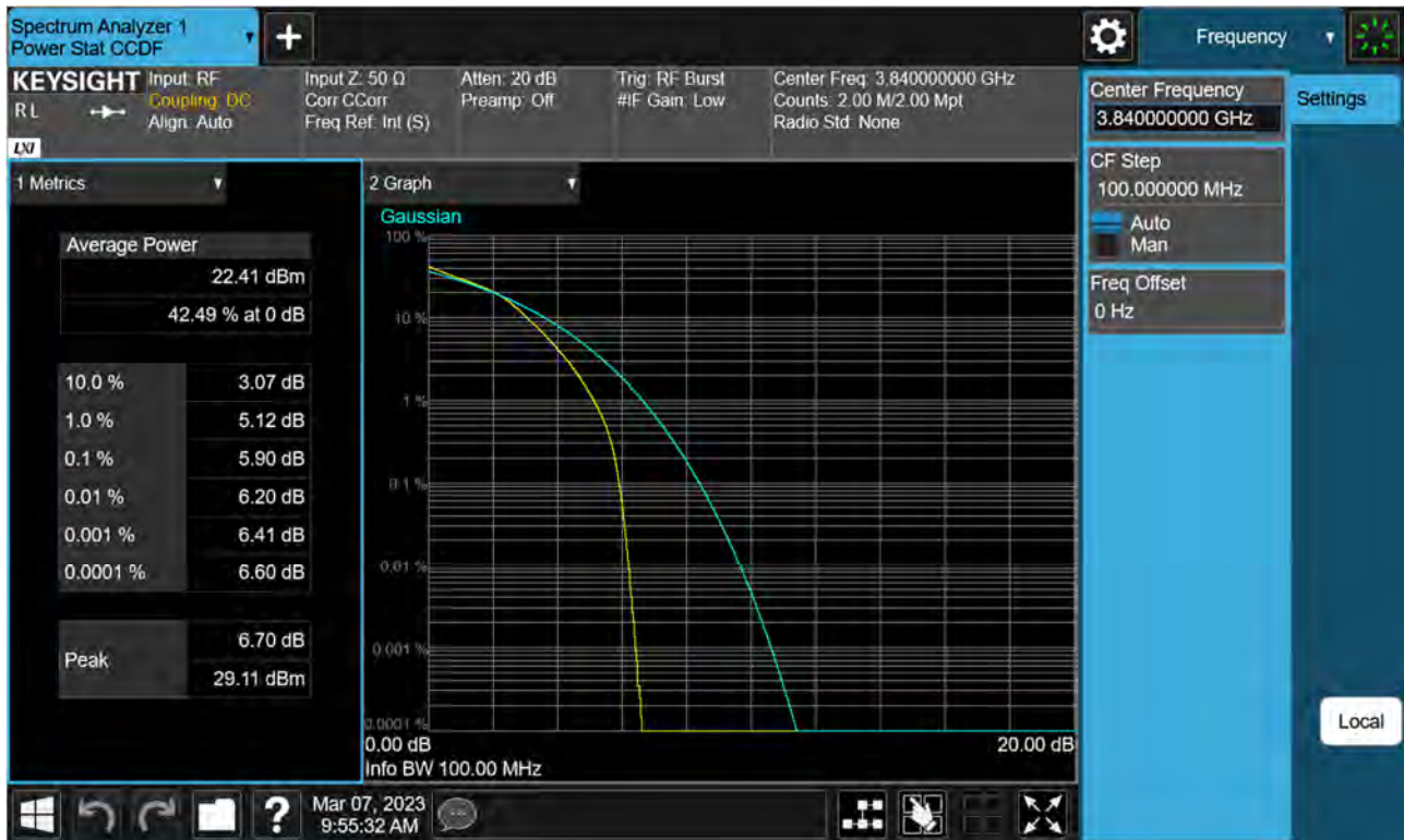
Sub6 n77(78). PAR Plot (100 M BW_Ch.656000_16QAM)
