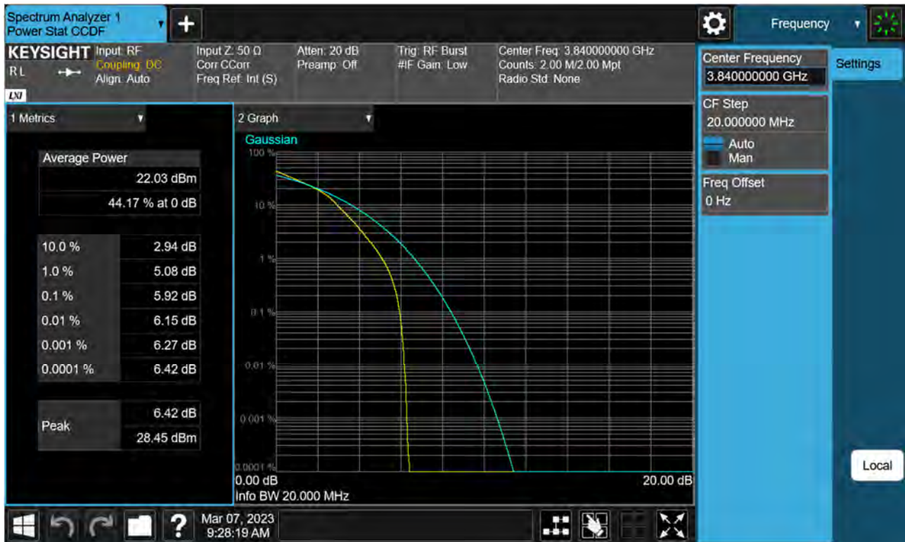
Sub6 n77(78). PAR Plot (20 M BW_Ch.656000_16QAM)
