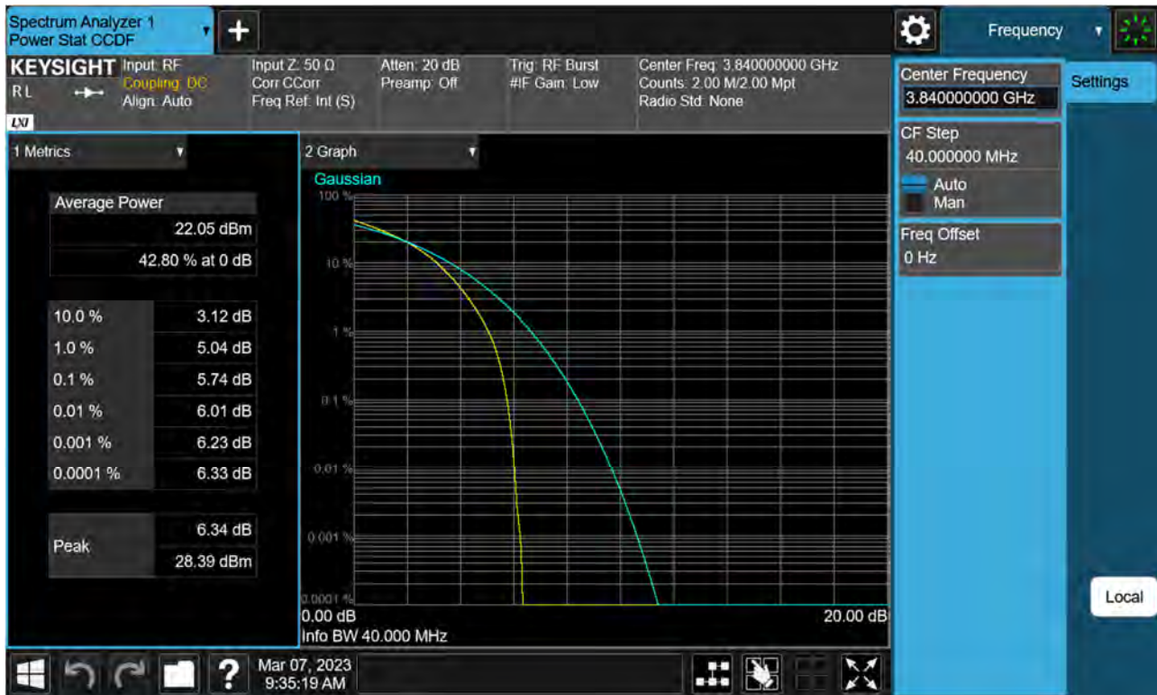
Sub6 n77(78). PAR Plot (40 M BW_Ch.656000_16QAM)
