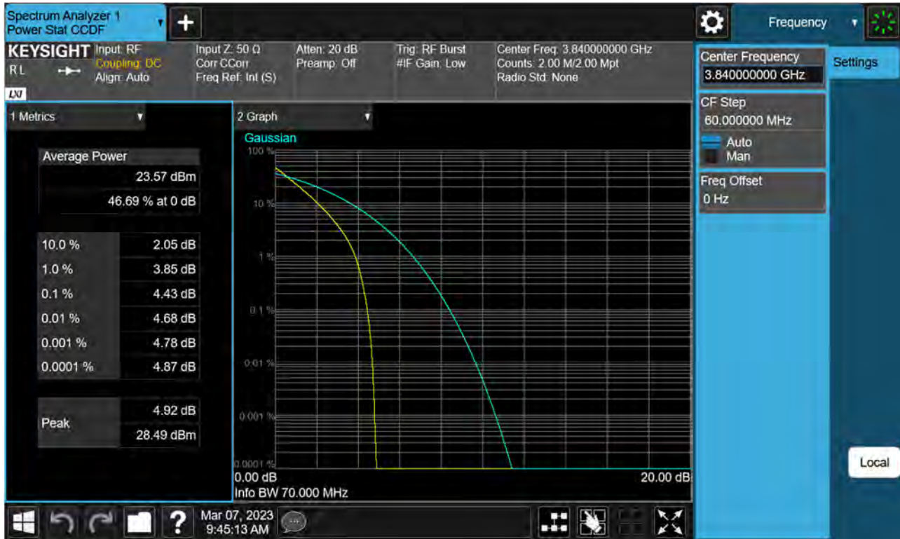
Sub6 n77(78). PAR Plot (70 M BW_Ch.656000_ BPSK)
