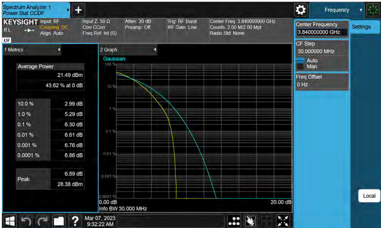
Sub6 n77(78). PAR Plot (30 M BW_Ch.656000_64QAM)
