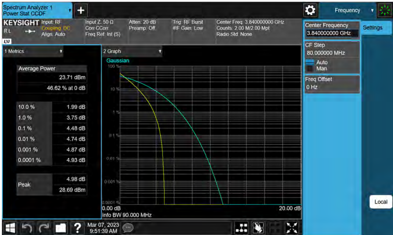
Sub6 n77(78). PAR Plot (90 M BW_Ch.656000_ BPSK)
