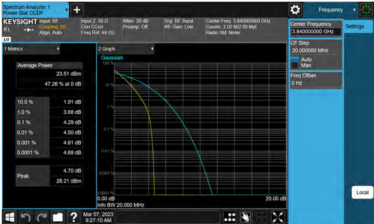
Sub6 n77(78). PAR Plot (20 M BW_Ch.656000_ BPSK)
