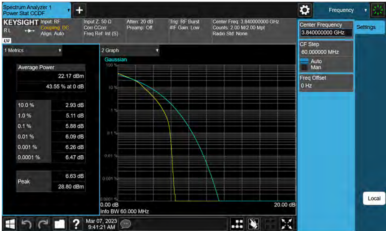
Sub6 n77(78). PAR Plot (60 M BW_Ch.656000_16QAM)
