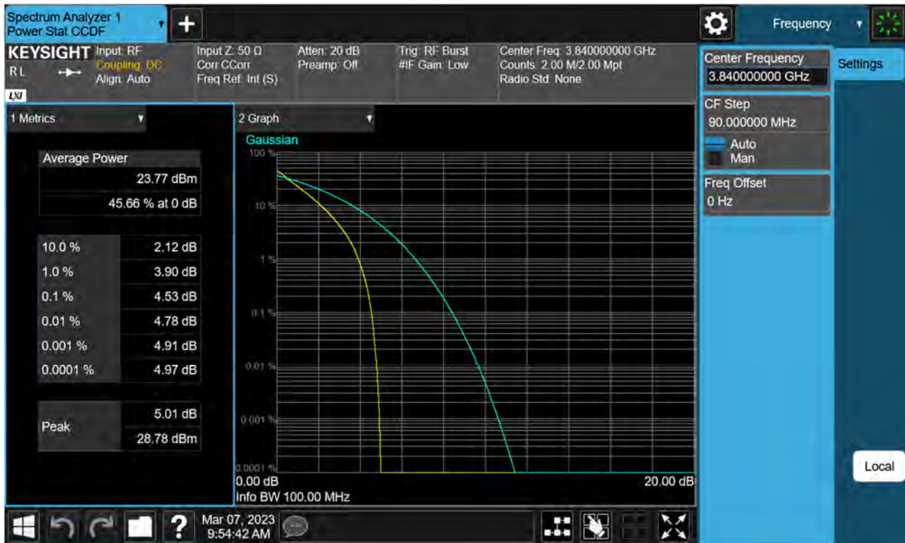
Sub6 n77(78). PAR Plot (100 M BW_Ch.656000_ BPSK)
