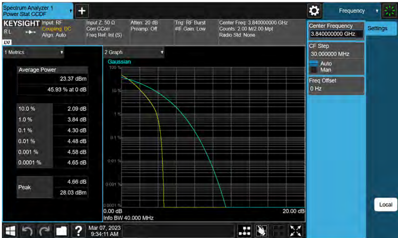
Sub6 n77(78). PAR Plot (40 M BW_Ch.656000_BPSK)
