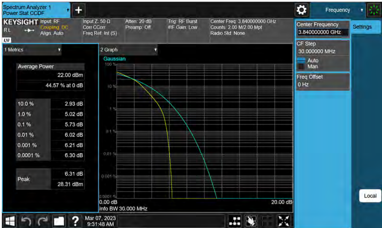
Sub6 n77(78). PAR Plot (30 M BW_Ch.656000_16QAM)
