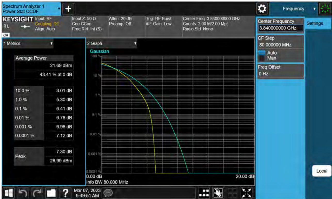
Sub6 n77(78). PAR Plot (80 M BW_Ch.656000_64QAM)
