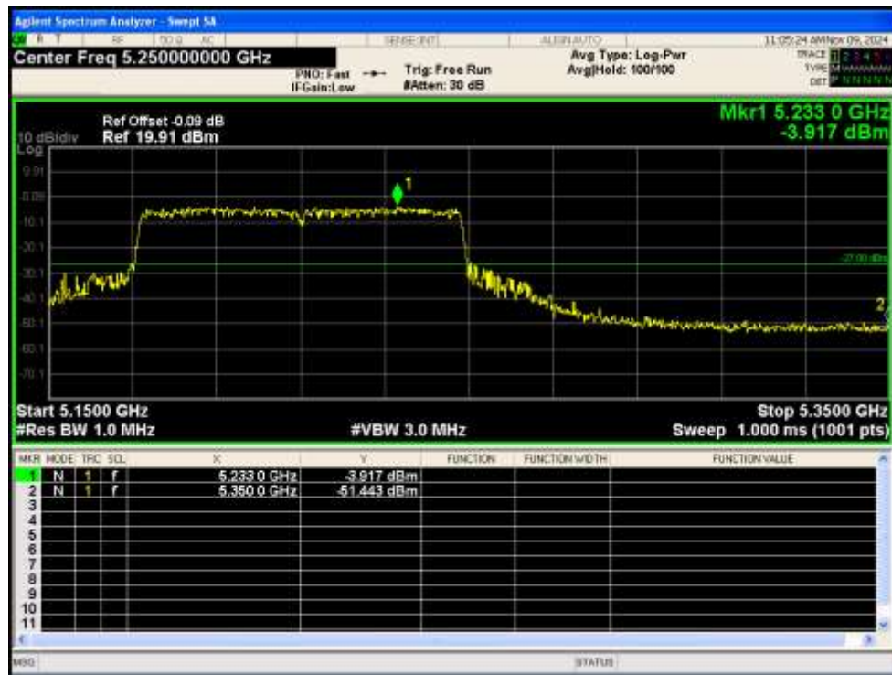
Band Edge NVNT ac80 5210MHz Low Ant1
