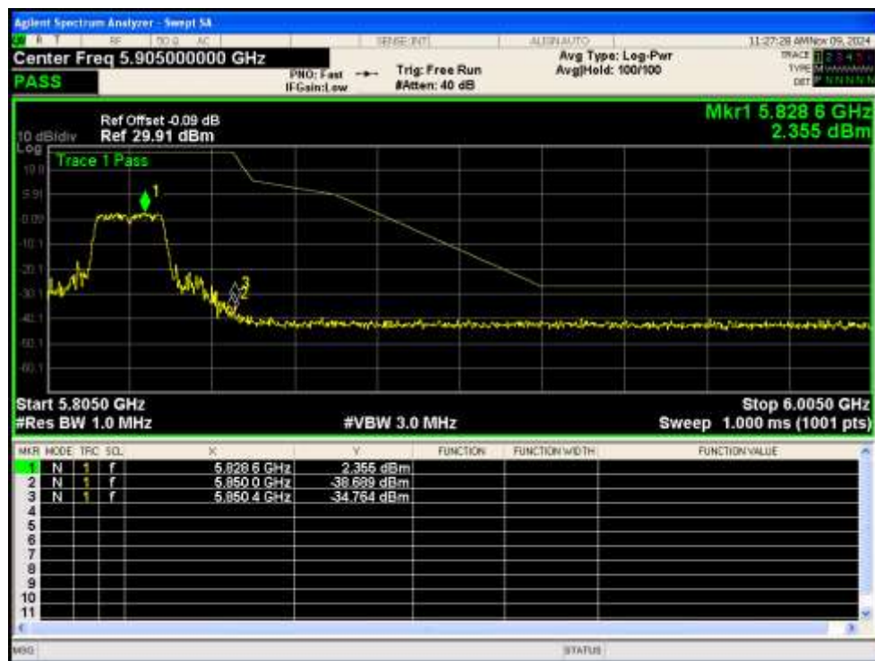
Band Edge NVNT ac20 5745MHz Low Ant1
