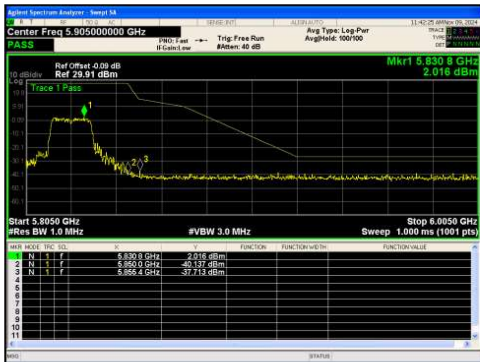
Band Edge NVNT ac40 5755MHz Low Ant1
