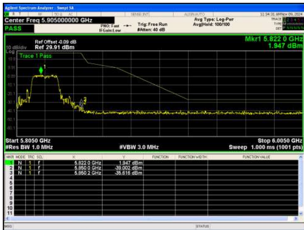
Band Edge NVNT n40 5755MHz Low Ant1
