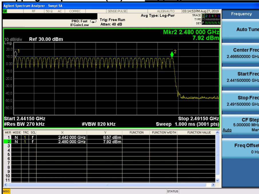
**Number of Hopping Frequencies 1(FH) *Hopping mode : Enable &  $\pi/4$ DQPSK***
