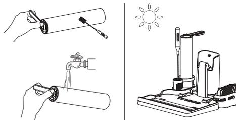
À l'aide de l'outil de nettoyage, retirez les cheveux et les débris enroulés autour du rouleau et rincez-le à l'eau. Remplacez le rouleau brosse dans le porte-accessoires et laissez-le sécher complètement avant de le réinstaller.
