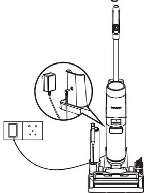
Pour charger l'appareil, placez-le sur la base de recharge et branchez l'adaptateur sur une prise secteur.
