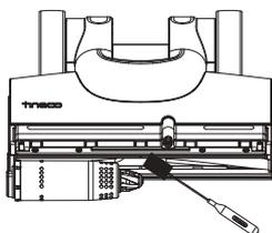
Retirez les cheveux et les débris du compartiment du rouleau brosse et de l'ouverture à l'aide de l'outil de nettoyage.
