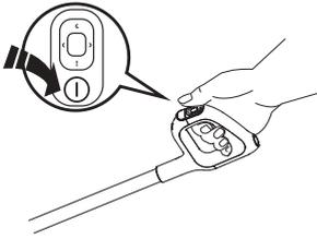
Appuyez sur le bouton ① et l'appareil démarrera en mode AUTO par défaut, appuyez sur le bouton Sélectionner pour passer d'un mode à l'autre.
