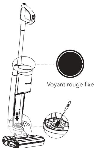
Lorsque la boucle LCD est rouge, retirez le réservoir d'eau sale et nettoyez le capteur de saleté à l'aide d'un chiffon humide ou de l'outil de nettoyage.
