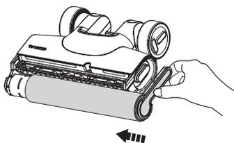
Remettez le rouleau brosse en place en insérant son extrémité dans le côté gauche du support, puis fixez la languette du rouleau à la boucle magnétique à droite pour la verrouiller en place.
