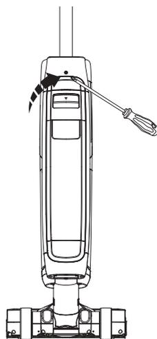
Dans le cas où la poignée doit être démontée, appuyez sur le ressort pour libérer la poignée à l'aide d'un outil (par exemple un tournevis) et soulevez la poignée de l'appareil.
