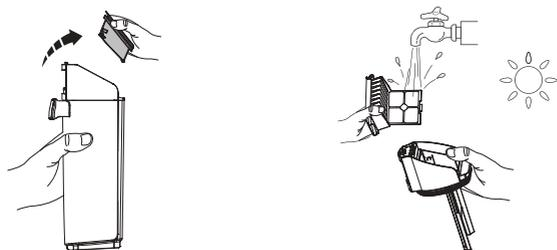
Saisissez les zones en creux de chaque côté du filtre sec et tirez vers le haut. Rincez sous l'eau courante et laissez sécher complètement avant de replacer le filtre sec dans le couvercle du RES.
