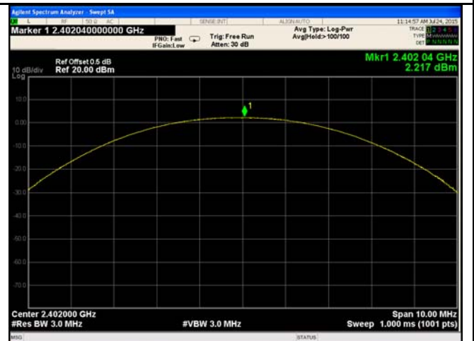
\pi/4 DQPSK Output power - Low CH 2402
