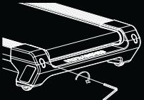
ランニングベルトが右に動く場合：右側のボルトを 時計回りに  $\frac{1}{4}$  回転、回し、その後、左の ベルトが動かない場合、それが中心に来るまで繰り返してください。ボルトを逆時計回りに  $\frac{1}{4}$  回転、回してください。
