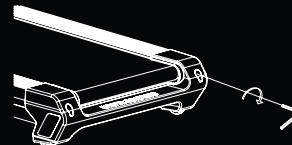
MIT DER ZEIT WIRD SICH DAS LAUFBAND LOCKERN. UM DAS LAUFBAND ZU SPANNEN, DREHEN SIE DIE SCHRAUBENDER RECHTEN UND LINKEN SEITE EINMAL UM 360 GRAD IM UHRZEIGERSINN HERUM UND ÜBERPRÜFEN SIE DANN DIE SPANNKRAFT DES LAUFBANDS. FÜHREN SIE DIESEN PROZESS FORT, BIS DAS LAUFBAND DIE RICHTIGE SPANNKRAFT HAT. STELLEN SIE SICHER, DASS BEIDE SEITEN GLEICH EINGESTELLT SIND, UM DIE AUSRICHTUNG DES LAUFBANDS ZU KORRIGIEREN.
