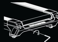
WENN SICH DAS LAUFBAND RECHTSHERUM BEWEGT: DREHEN SIE DIE SCHRAUBE AUF DER RECHTEN SEITE UM 90 GRAD IM UHRZEIGERSINN UND DANN DIE SCHRAUBE AUF DER LINKEN SEITE UM 90 GRAD GEGEN DEN UHRZEIGERSINN. BEWEGT SICH DAS LAUFBAND NICHT, WIEDERHOLEN SIE DEN VORHERIGEN SCHRITT, BIS ES SICH ZENTRIERT.
