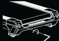
如果跑带右移，则顺时针旋转右侧螺栓  $\frac{1}{4}$  圈，然后逆时针旋转左侧螺栓  $\frac{1}{4}$  圈。如果跑带没有移动，重复操作直至其居中。
