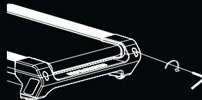
LA CINTA DE CORRER SE AFLOJARÁ CON EL TIEMPO. PARA TENSAR LA CINTA GIRO LOS PERNOS DE LOS LADOS DERECHO E IZQUIERDO UNA VUELTA COMPLETA EN SENTIDO HORARIO. COMPRUEBE LA TENSIÓN DE LA CINTA. CONTINUÉ CON EL PROCESO HASTA QUE LA CINTA ESTÉ CORRECTAMENTE TENSADA. ASEGUÍRESE DE AJUSTAR AMBOS LADOS POR IGUAL PARA UNA ALINEACIÓN CORRECTA DE LA CINTA.
