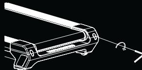
LE TAPIS ROULANT VA SE DÉTENDRE AU FIL DU TEMPS. POUR LE RETENDRE, TOURNER LES BOULONS DE GAUCHE ET DE DROITE D'UN TOUR COMPLET DANS LE SENS DES AIGUILLES D'UNE MONTRE. VÉRIFIER LA TENSION DU TAPIS. CONTINUER LE PROCESSUS JUSQU'À CE QUE LE TAPIS SOIT À LA BONNE TENSION. VEILLER À AJUSTER LES DEUX CÔTÉS DE LA MÊME FAÇON POUR CORRIGER L'ALIGNEMENT DU TAPIS.
