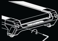
SE O TAPETE DE CORRIDA SE MOVER PARA A DIREITA: RODE O PARAFUSO À DIREITA  $\frac{1}{4}$  DE VOLTA NO SENTIDO DOS PONTEIROS DO RELÓGIO, DEPOIS, RODE O PARAFUSO À ESQUERDA  $\frac{1}{4}$  DE VOLTA NO SENTIDO CONTRÁRIO AO DOS PONTEIROS DO RELÓGIO. SE O TAPETE NÃO SE MOVER, REPITA ATÉ QUE FIQUE CENTRADO.
