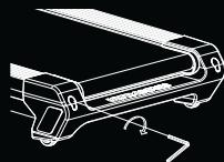
SI LE TAPIS ROULANT SE DÉPLACE VERS LA GAUCHE : TOURNER LES BOULONS DE GAUCHE D'UN QUART DE TOUR DANS LE SENS DES AIGUILLES D'UNE MONTRE. PUIS TOURNER LE BOULON DE DROITE D'UN QUART DE TOUR DANS LE SENS INVERSE DES AIGUILLES D'UNE MONTRE. SI LE TAPIS NE BOUGE PAS, RÉPÉTER L'OPÉRATION JUSQU'À CE QU'IL SOIT CENTRE.
