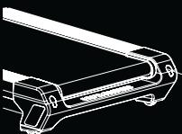
ランニングベルトが左に動く場合：左側の ボルトを時計回りに  $\frac{1}{4}$  回転、回し、その後、右のボルトを逆時計回りに  $\frac{1}{4}$  回転、回してください。ベルトが動かない場合、それが中心に来るまで繰り返してください。
