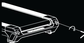
如果跑带左移，则顺时针旋转左侧螺栓  $\frac{1}{4}$  圈，然后逆时针旋转右侧螺栓  $\frac{1}{4}$  圈。如果跑带没有移动，重复操作直至其居中。
